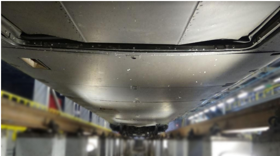
Rysunek 3: Podwozie pojazdu szynowego wyposażonego w osłony zabezpieczające
