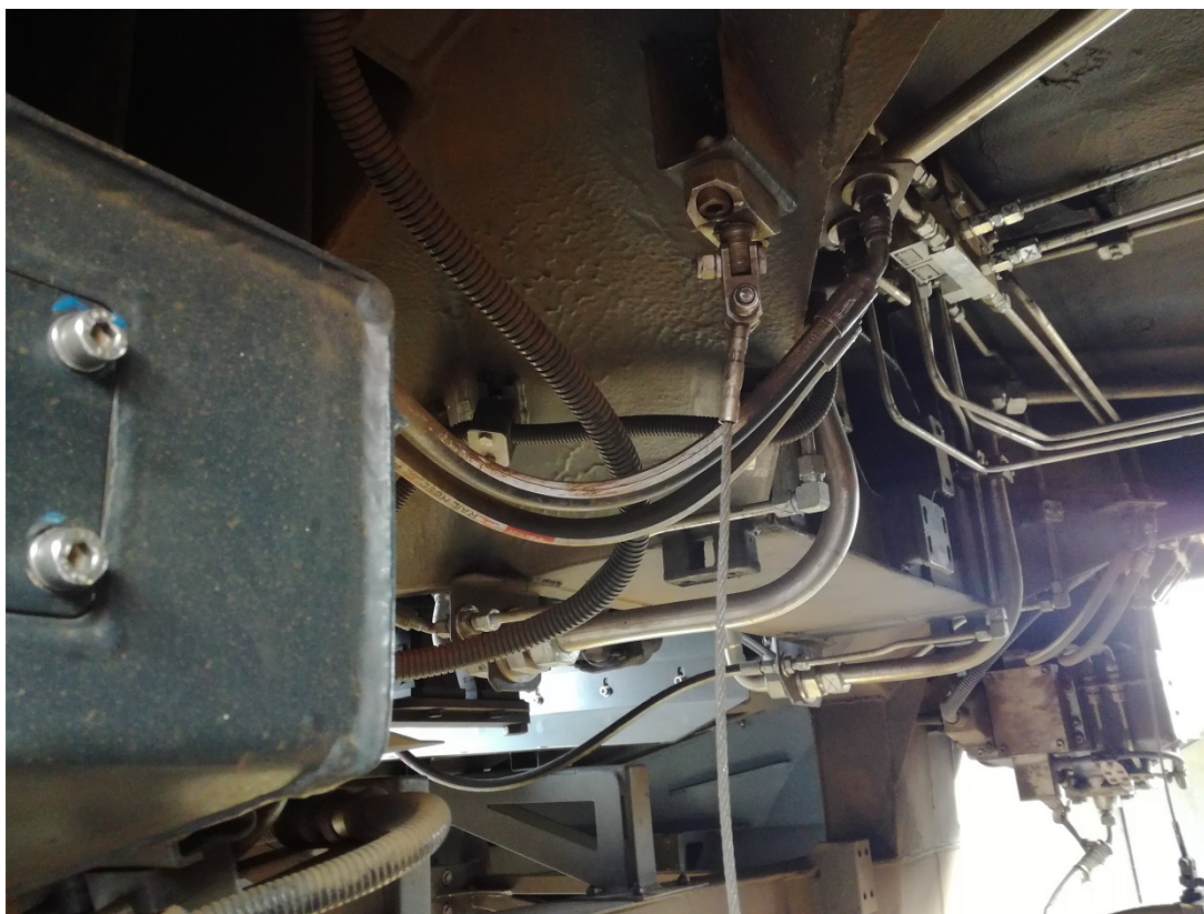
Rysunek 1: Podwozie współczesnego pojazdu szynowego obsługującego ruch regionalny, niewyposażonego w osłony zabezpieczające podwozie
