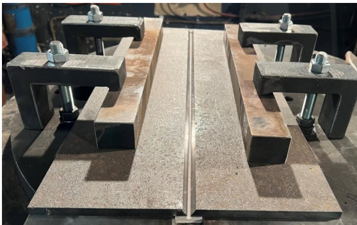
Rys. 29. Płyta próbna z podkładką ceramiczną zamontowaną na stole robota spawalniczego
