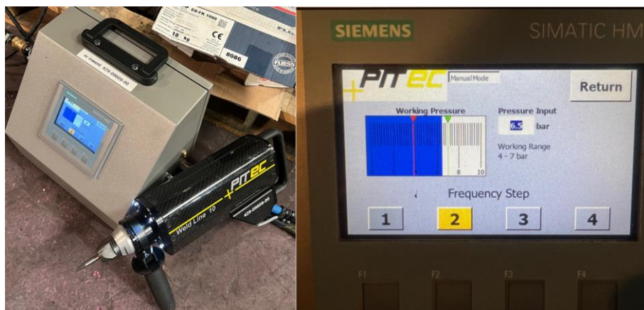
Rys. 41. Urządzenie Weld Line 10 (po lewej), wartość ciśnienia zasilającego urządzenie w trakcie przekuwania płyt próbnych (po prawej)
