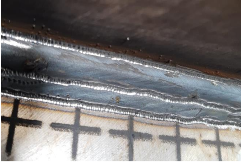
Rys. 51. Lico spoiny pachwinowej płyty o oznaczeniu B2 po zakończeniu spawania drugiej warstwy po wykonaniu pierwszego etapu przekuwania
