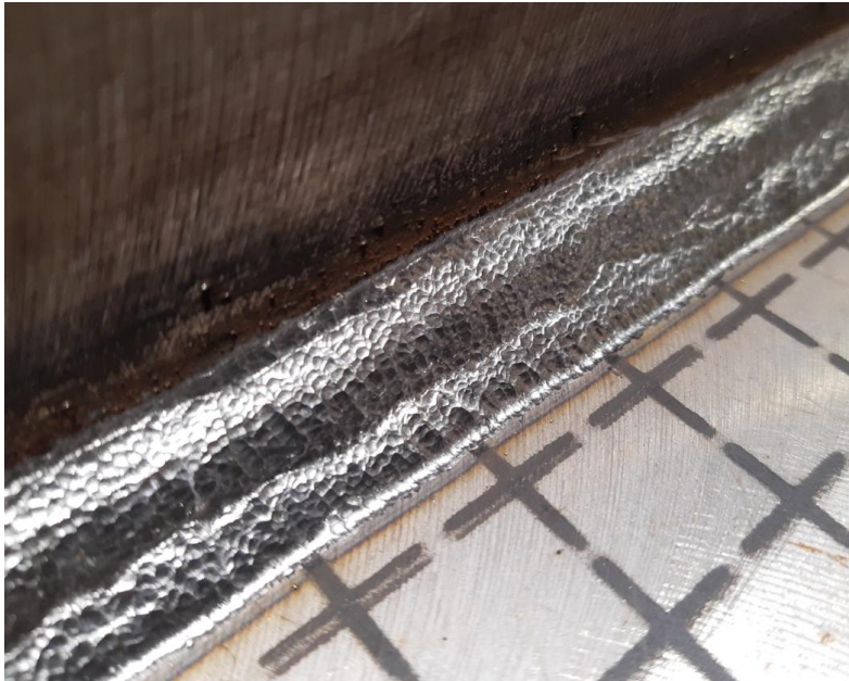
Rys. 52. Lico spoiny pachwinowej płyty o oznaczeniu B2 po zakończeniu spawania drugiej warstwy po zakończeniu przekuwania
