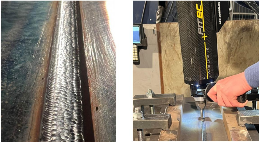
Rys. 42. Płyta próbna S960M w trakcie przekuwania (po prawej), ścieg Nr 2 (wypełnienie) po przekuciu całej powierzchni (po lewej)
