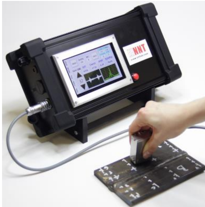
Rys. 66. Urządzenie MagStress5c w trakcie pomiaru naprężeń w złączu spawanym
