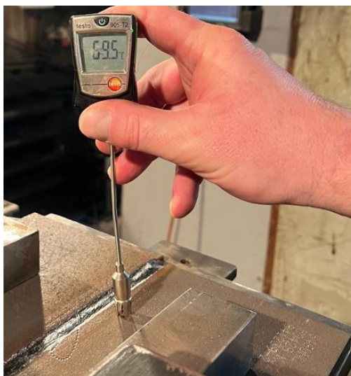
Rys. 40. Płyta próbna S460M w trakcie pomiaru temperatury między ściegowej
