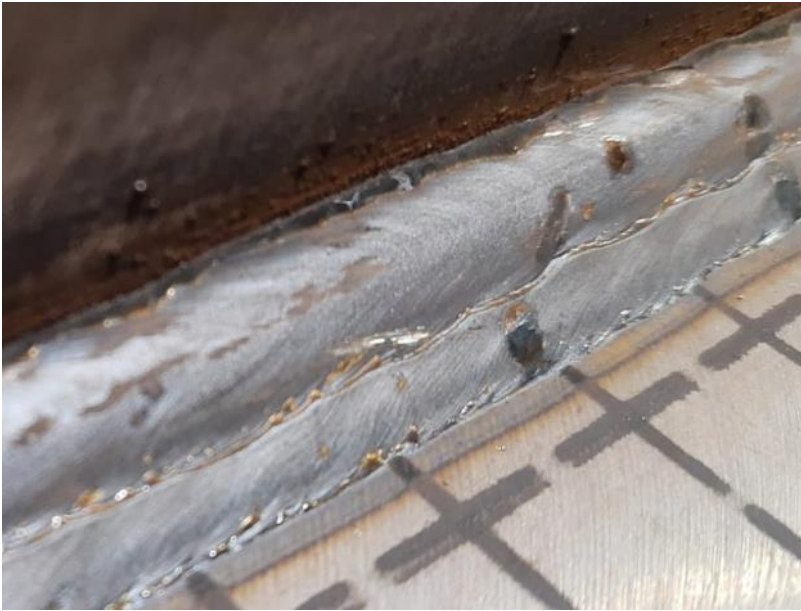
Rys. 50. Lico spoiny pachwinowej płyty o oznaczeniu B2 po zakończeniu spawania drugiej warstwy
