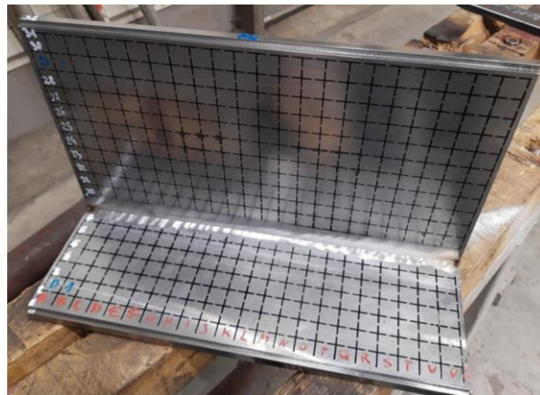
Rys. 55. Złącze teowe przygotowane do spawania z wytrasowaną siatką punktów do pomiaru przed i po spawaniu i procesach towarzyszących
