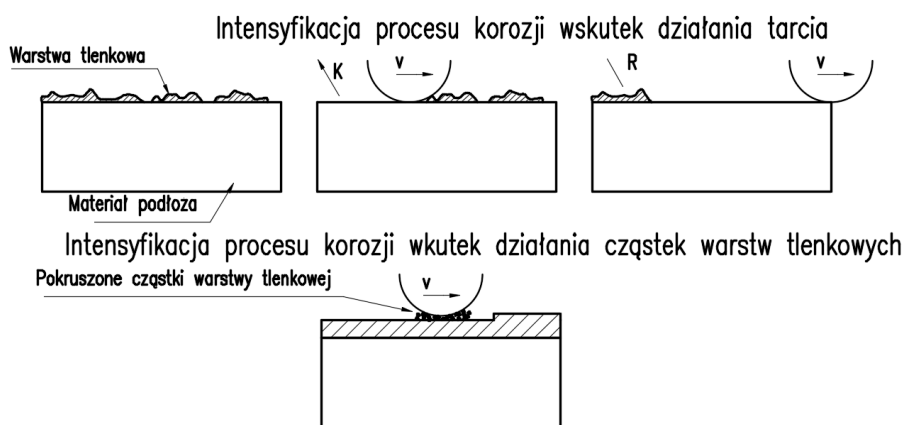
Rys. 2.12. Mechanizm zużycia tribokorozyjnego ( v -wektor prędkości, K -korozja; R -repasywacja) [46]
