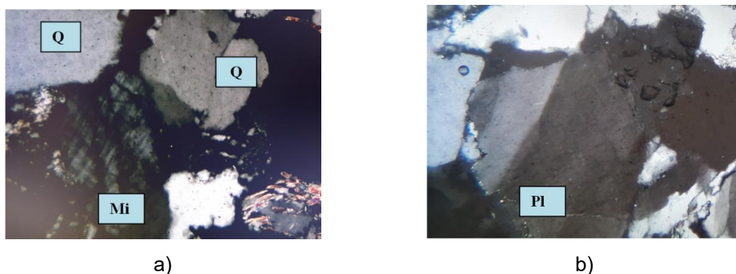
Rys. 6.14. Widok a) mikroklin (Mi) w otoczeniu kwarcu (Q); b) plagioklaz (Pl); polaryzatory skrzyżowane, powiększenie 100x
