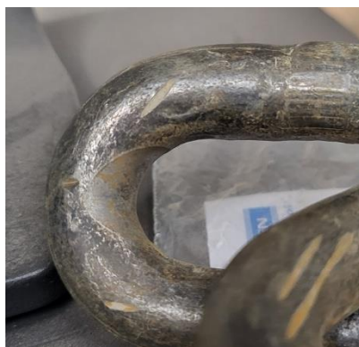
Rys. 6.5. Widok strefy zużycia pary ogniw po teście trwającym 30 godzin i pod obciążeniem siłą osiową F=981\text{ N}
