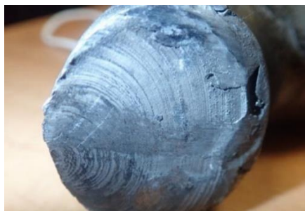
Rys. 2.4 Przykład przełomu zmęczeniowego ogniwa łańcuchowego [2]
