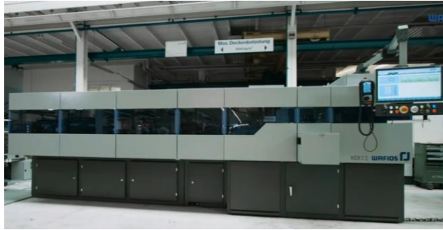
Rys. 4.12. Przycinarka prętów do produkcji łańcuchów [71]
