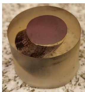
Rys. 5.19. Widok fragmentu ogniwa przygotowanego do badań mikroskopowych
