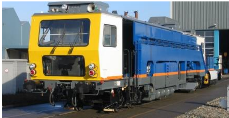
Rysunek 2. Drezyna z systemem TMS do pomiarów rozjazdów kolejowych [39].
