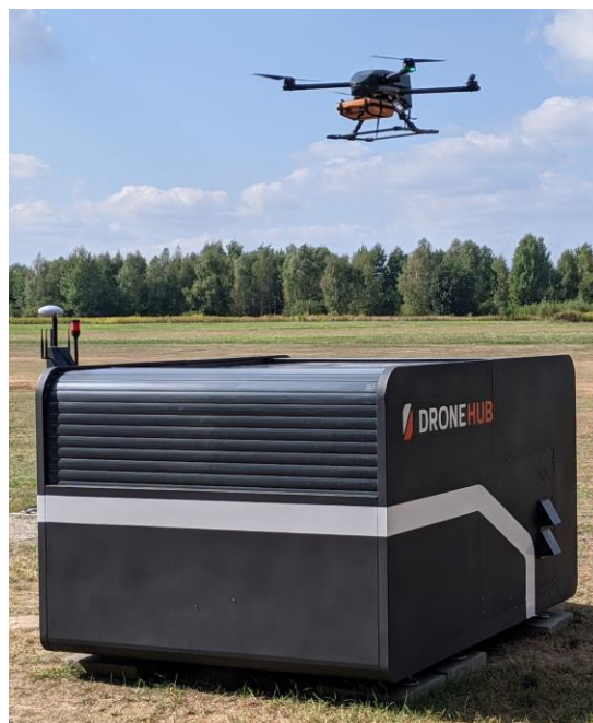
Rysunek 14. Garaż dla drona z lądowiskiem na dachu (rekomendowany).
