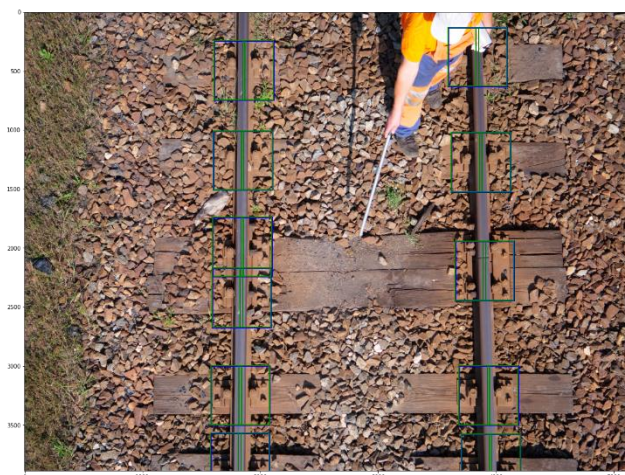
Rysunek 31. Wskazanie obszaru do analizy na przecięciu szyn i podkładów (tzw. checking box).
