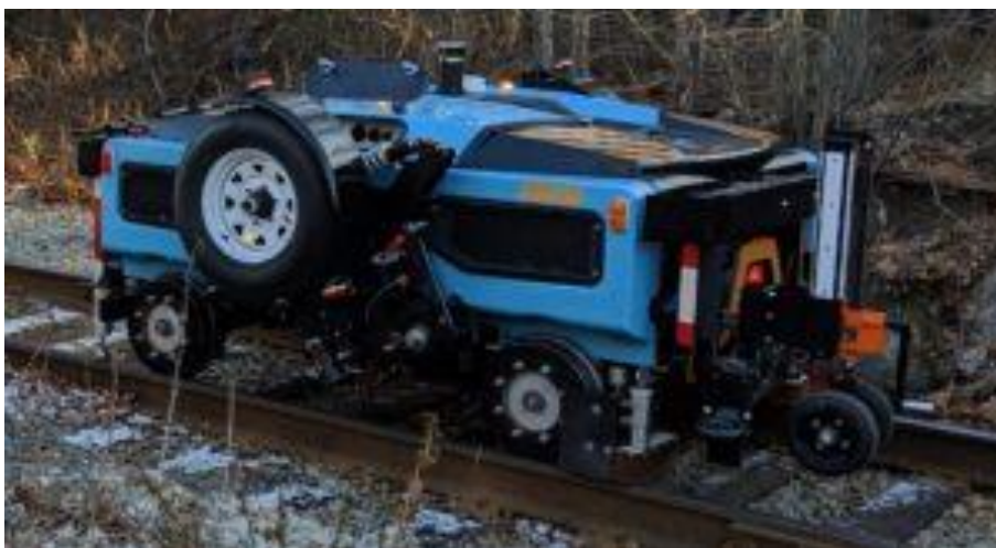
Rysunek 4. Pojazd Railpod do wykonywania inspekcji infrastruktury kolejowej [43].
