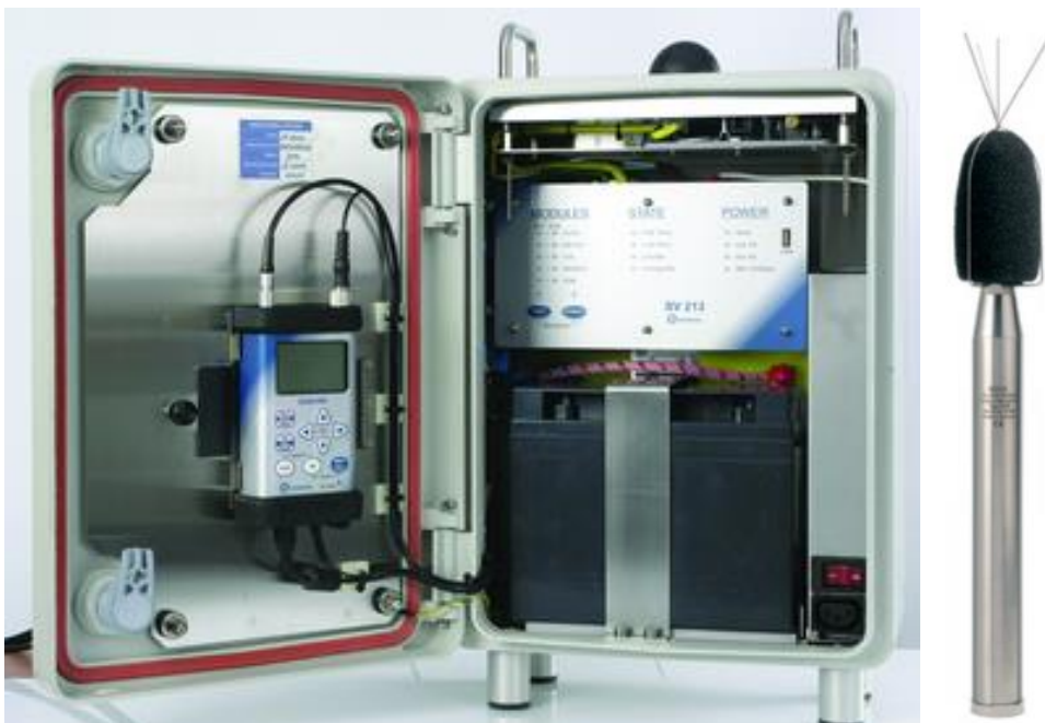
Rys. 4.13 Wnętrze stacji SV210C [86] oraz mikrofon GRAS 41AM [87].
