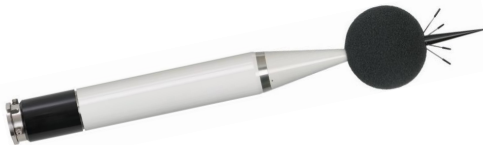
Rys. 4.15 Fotografia stacji monitoringu hałasu SV200 [85].
