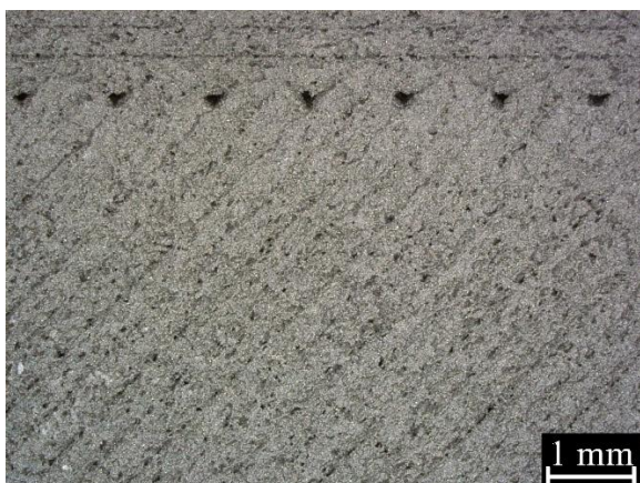
Rysunek 4.26. Powierzchnia spieków materiału komercyjnego spiekanego w atmosferze N_2-10\%H_2 , a) powierzchnia górna próbki do statycznej próby rozciągania, x10 b) powierzchnia boczna próbki do statycznej próby rozciągania, x80 c) powierzchnia górna próbki typu "belka" x20, d) powierzchnia górna próbki typu "belka", x80.
