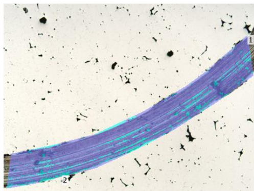
Rysunek 4.84. Ślad wytarcia a) w próbce stali spiekanej w próżni, b) w próbce stali spiekanej w at. Ar-10% H_2 , c) w próbce stali spiekanej w at. N_2 -10% H_2 , d) w próbce stali spiekanej w at. N_2 -10% H_2 po obróbce cieplnej, mikroskop konfokalny Keyence VK-X3000.
