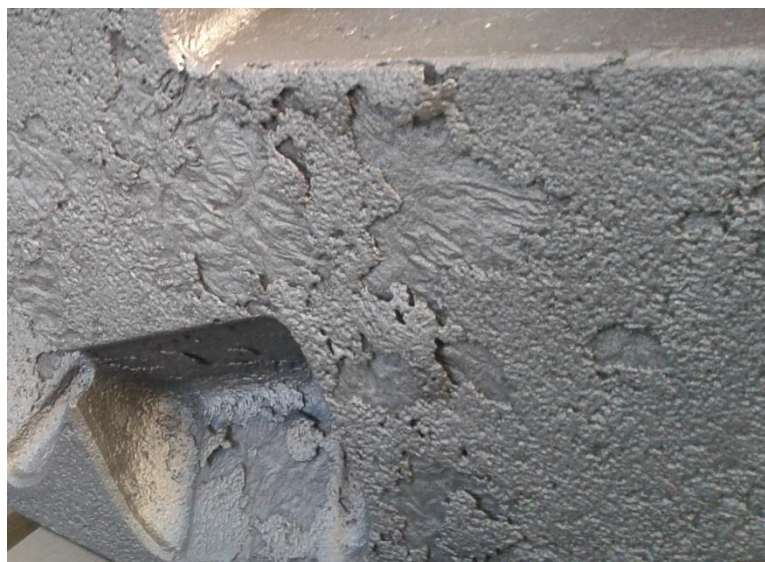
Rys. 2.1.4.3. Wada węgla błyszczącego na powierzchni odlewu wielkogabarytowego
