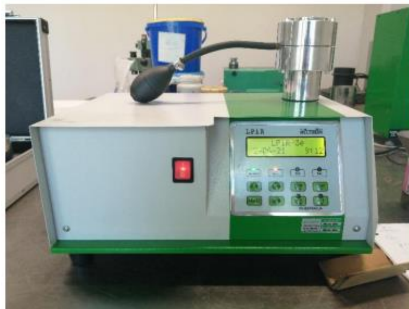
Rys. 6.2.2. Maszyna do badań przepuszczalności masy formierskiej typu LPiR-3e wraz ze specjalną tulejką do mas bezwodnych
