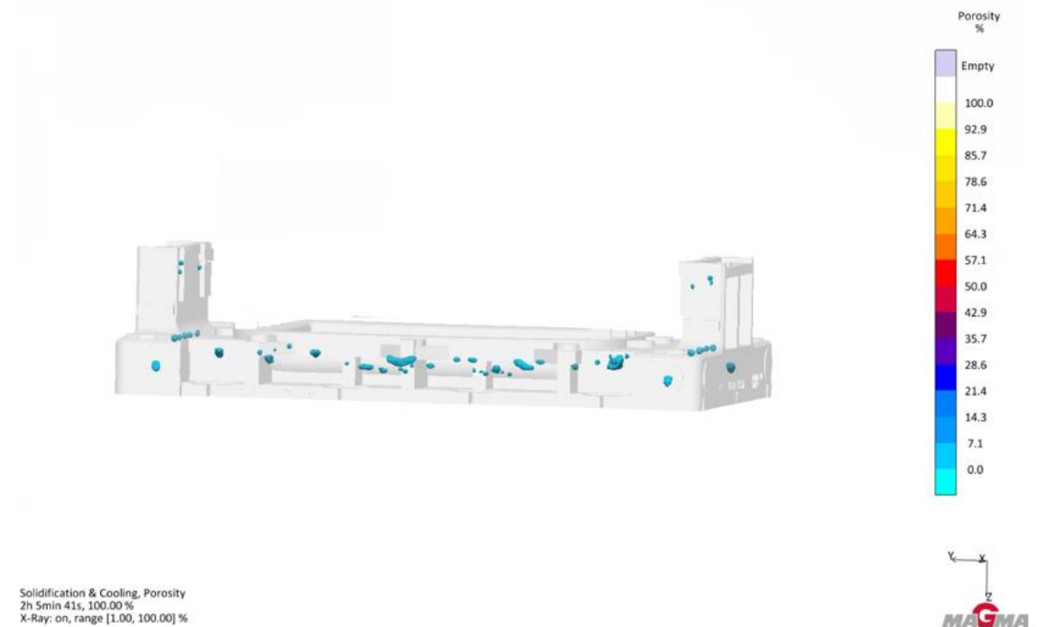
Rys. 8.7. Rozkład porowatości wewnętrznych dla odlewu nr 3
