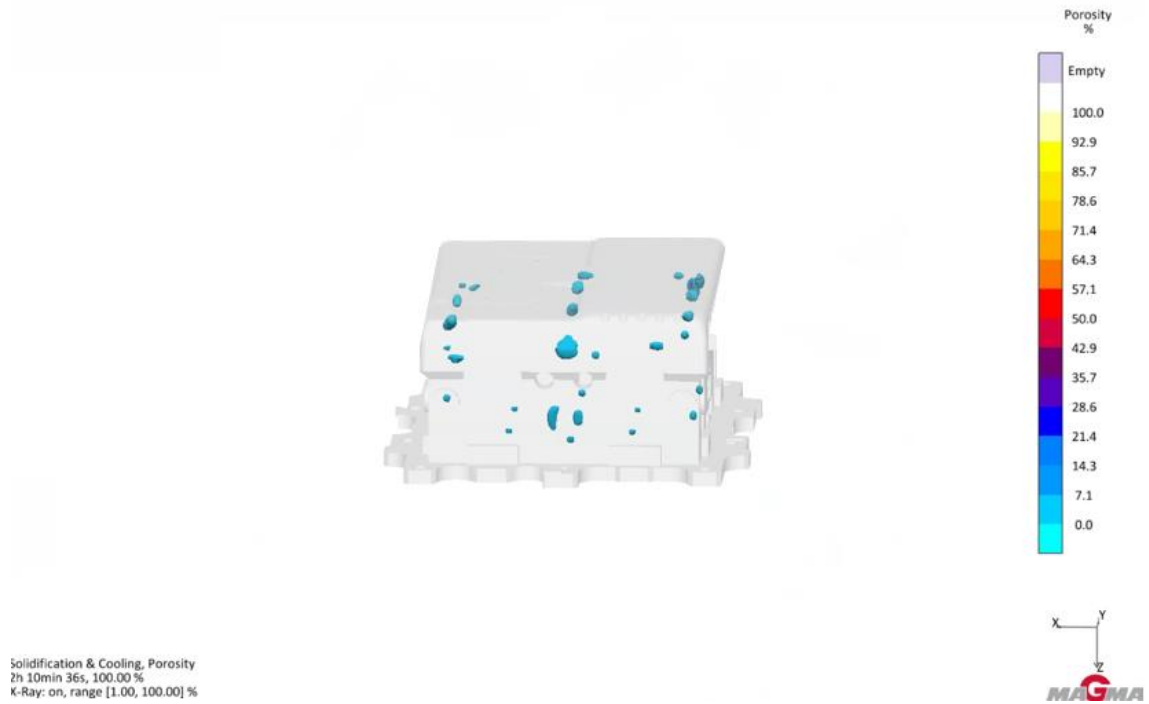
Rys. 8.6. Rozkład porowatości wewnętrznych dla odlewu nr 2
