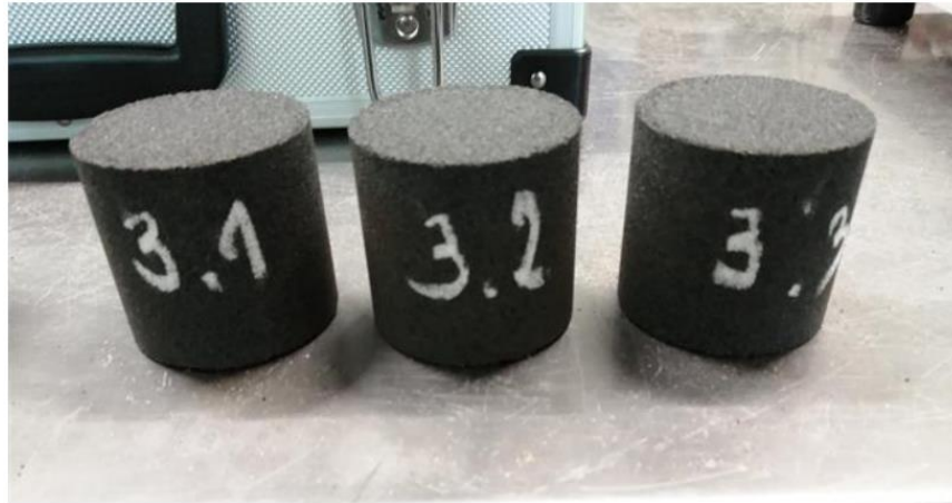
Rys. 6.2.1. Próbkki walcowe do badań przepuszczalności masy formierskiej bez pokrycia ogniotrwałego
