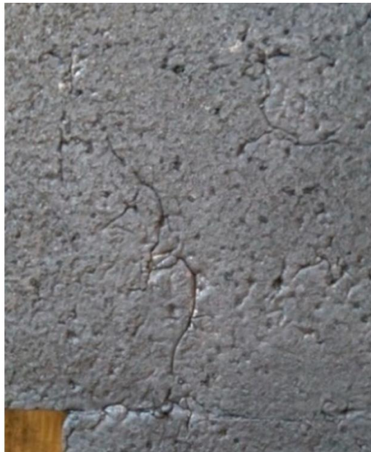
Rys. 2.1.4.2. Wada węgla błyszczącego [41]
