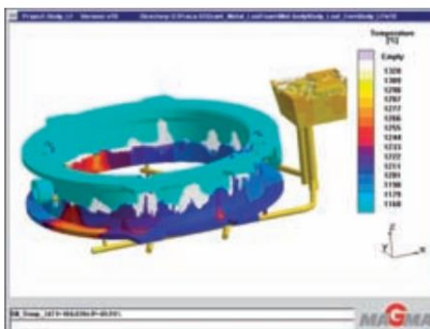
Rys. 2.2.3. Rozkład temperatury w 104s zalewania [94]
