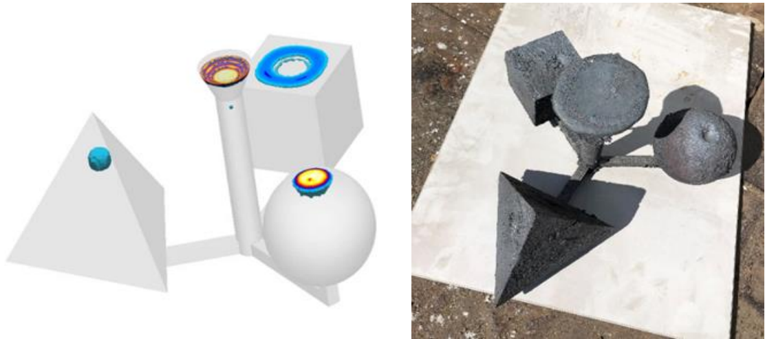
Rys.7.7.9. Porównanie wad modeli laboratoryjnych powstałych w symulacji i rzeczywistości
