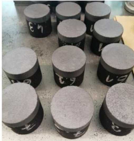
Rys. 6.2.3. Próbkki do badań przepuszczalności masy formierskiej z naniesionym pokryciem
