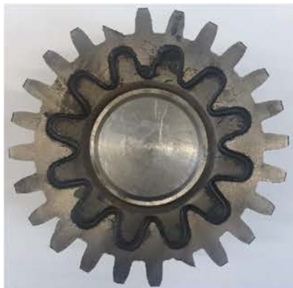
Rys. 8.2. Koło dzielone po usunięciu wybranych zębów w celu umożliwienia dostępu młotka [opracowanie własne]
