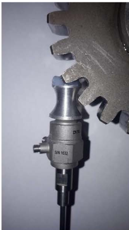
Rys. 6.6. Przygotowany autorski adapter zamontowany na końcu przetwornika wzbudnika oraz przyklejony zgodnie z rys. 6.5 b do zęba badanego koła podwieszono na linkach i przygotowany do badań [opracowanie własne]
