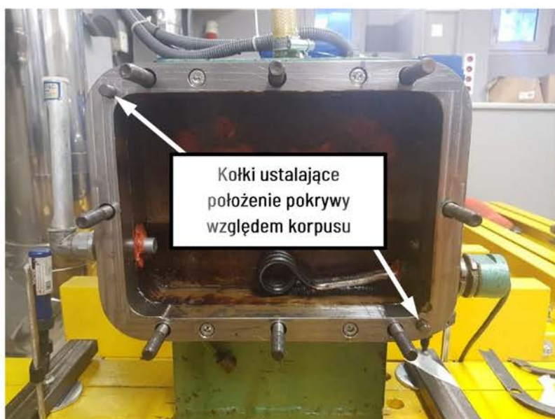
Rys. 7.3. Element dystansujący przekładni zębatej wraz z kółkami ustalającymi położenie pokrywy względem korpusu przekładni [opracowanie własne]
