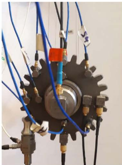
Rys. 6.8. Obiekt badań wraz z zamocowanymi przetwornikami przyspieszeń drgań [opracowanie własne]
