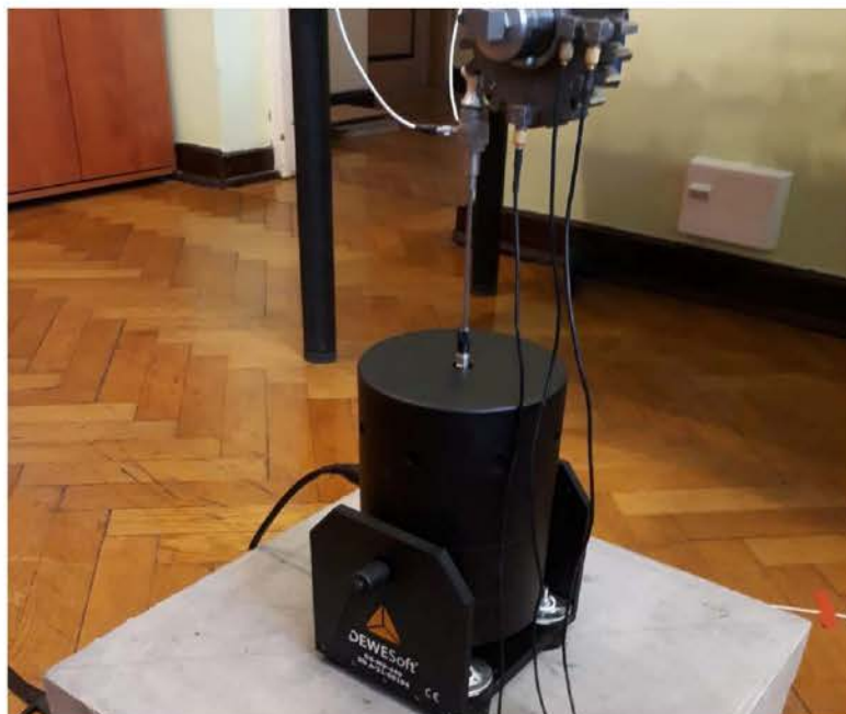
Rys. 6.4. Wzbudnik drgań DS-MS-440 wraz z przygotowanym osadzeniem [opracowanie własne]
