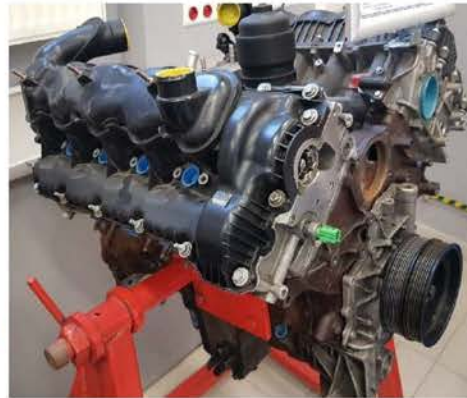
Rys. 2.5. Przykłady zastosowania na pokrywy elementów rozrządu i przekładni łańcuchowej: a) stopu aluminium z magnezem \text{MgAl9Zn1HP} w przy przypadku rzędowego sześciocylindrowego silnika firmy BMW, b) polimeru w przypadku ośmiocylindrowego silnika w układzie V stosowanego w samochodach firmy Land Rover [opracowanie własne]
