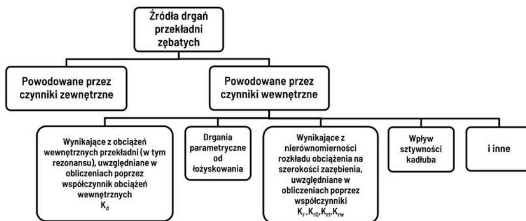
Rys. 2.3. Schemat podziału czynników wpływających na generowane drgania przekładni [opracowanie własne na podstawie [49,50]], K_r – współczynnik nierównomierności rozkładu obciążenia wynikający z niedokładności obróbki mechanicznej kół zębatych i korpusu, K_{r0} – współczynnik nierównomierności rozkładu obciążenia wynikający z odkształceń giętnych i skrętnych wałów i korpusów kół, K_{rt} – współczynnik trwałego rozkładu obciążenia, K_{rw} – wypadkowy współczynnik rozkładu obciążenia
