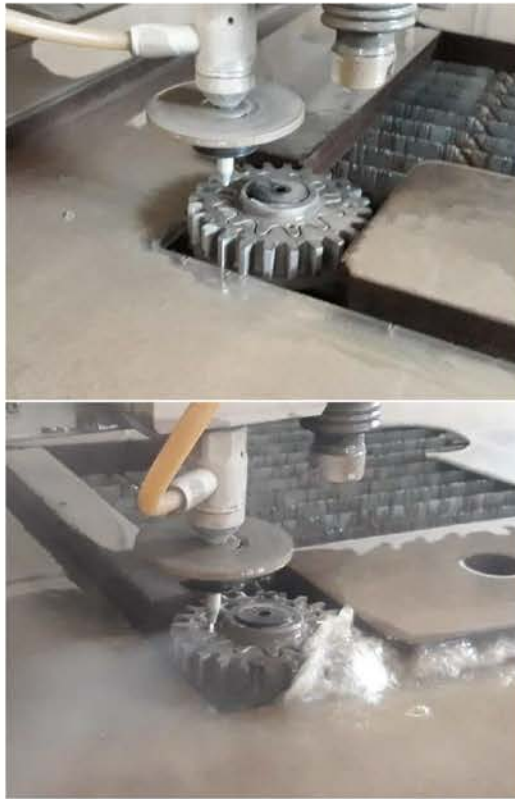
Rys. 6.1. Proces cięcia koła z wykorzystaniem mieszanki wody i ścierniwa pod ciśnieniem [opracowanie własne]
