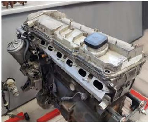
Rys. 2.5. Przykłady zastosowania na pokrywy elementów rozrządu i przekładni łańcuchowej: a) stopu aluminium z magnezem \text{MgAl9Zn1HP} w przy przypadku rzędowego sześciocylindrowego silnika firmy BMW, b) polimeru w przypadku ośmiocylindrowego silnika w układzie V stosowanego w samochodach firmy Land Rover [opracowanie własne]
