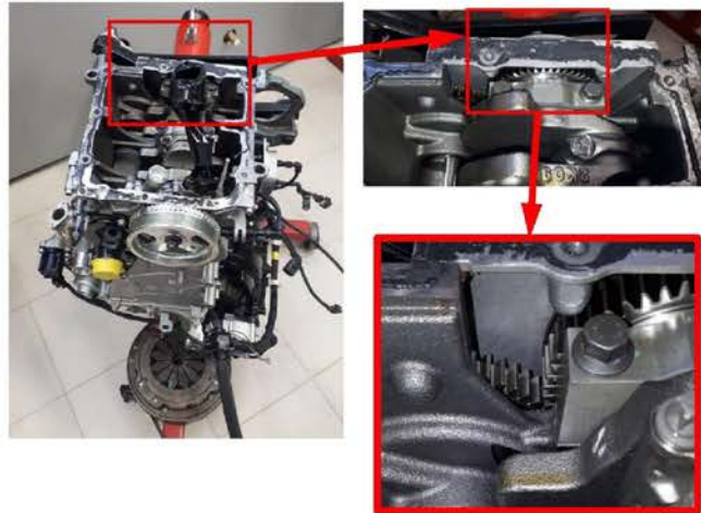
Rys. 1.4. Przekładnia walcowa o zębach prostych zastosowana w silniku 0,9 dm 3 TwinAir i służąca do napędu wałka wyrównowazającego [opracowanie własne]
