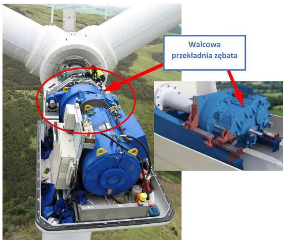
Rys. 1.9. Turbina wiatrowa – w układzie napędowym zastosowano szeregowe połączenie przekładni walcowej o osiach stałych i przekładni obiegowej [opracowano na podstawie [13,14]]
