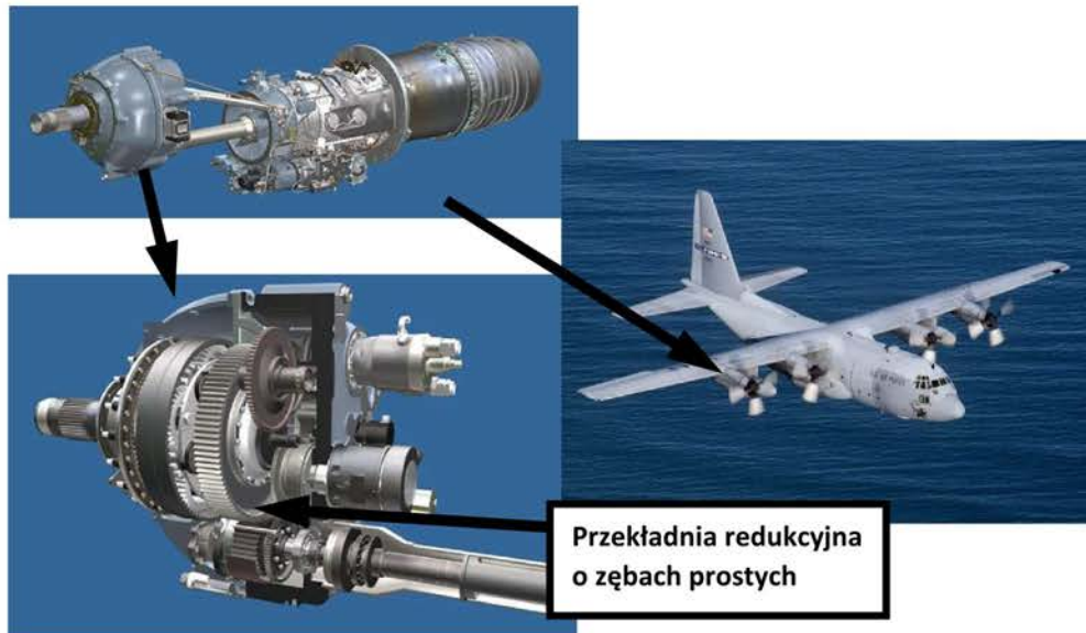
Rys. 1.2. Konstrukcja przekładni redukcyjnej silnika turbośmigłowego zastosowanej w statku powietrznym Lockheed C-130 Hercules [opracowano na podstawie [3,4]]
