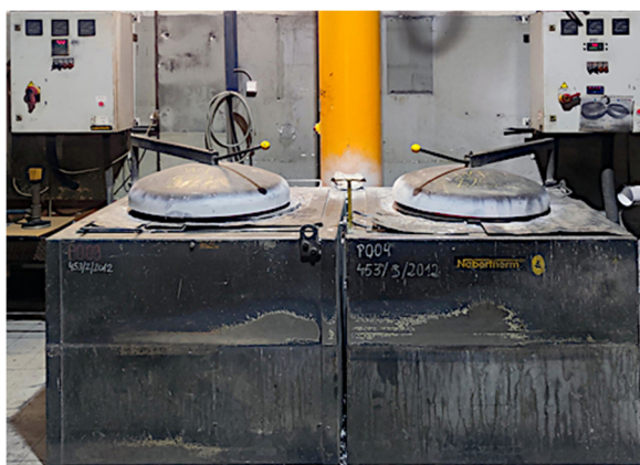
Rys. 49. Piece topielno-podtrzymujące w gnieździe odlewniczym.
