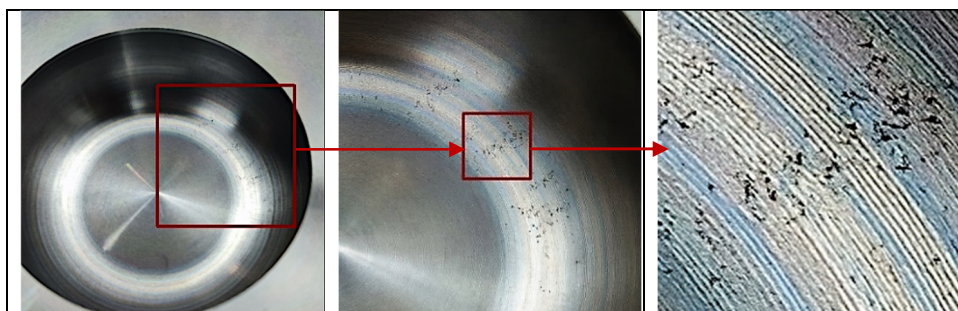
Rys. 29. Wady odlewnicze – mikroporowatość skurczowa.
