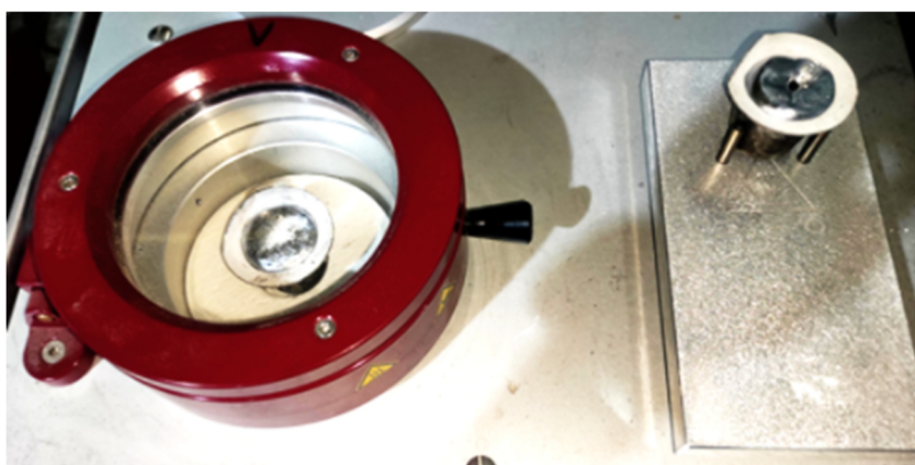
Rys. 77. Próbkę DI w czasie krzepnięcia na stanowisku 3VT Basic.
