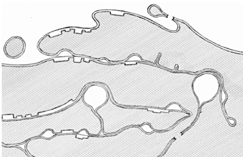
Rys. 12. Schematyczne przedstawienie turbulencji w cieczy powodujących porywanie błon tlenkowych, tworzenie się podwójnych warstw i pęcherzyków [60].
