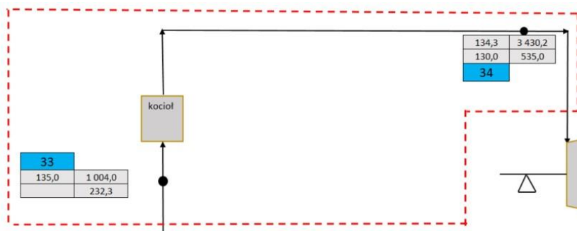
Rys. 58 Bilans energii dla kotła, punkty pomiarowe 33; 34
