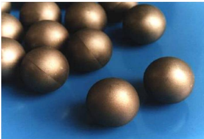
Rys. 12 Elementy paliwowe reaktora wysokotemperaturowego [2]
