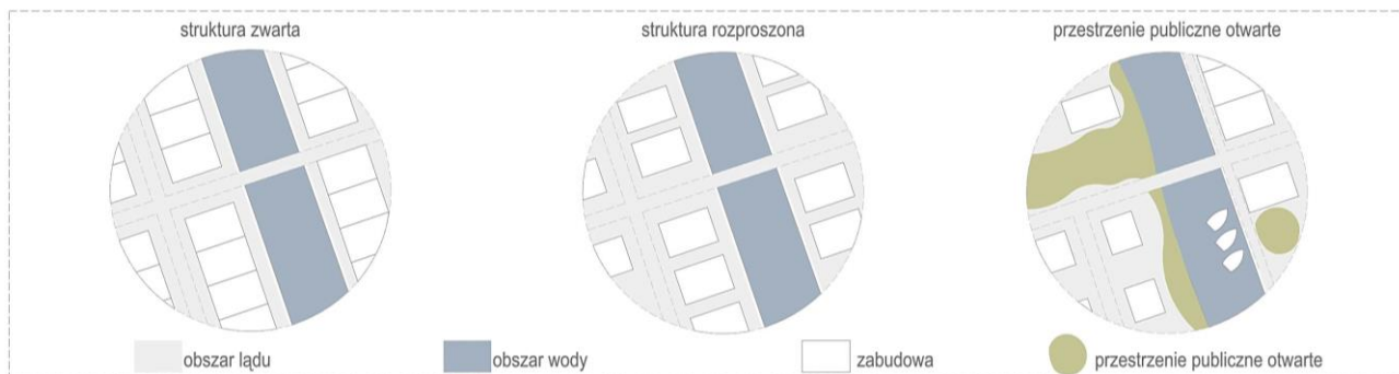
Ryc.90. Schematy ukształtowania rozwiązań architektoniczno-urbanistycznych nadrzecznego obszaru centralnego ze względu na intensywność zabudowy. Źródło: opracowanie własne.
