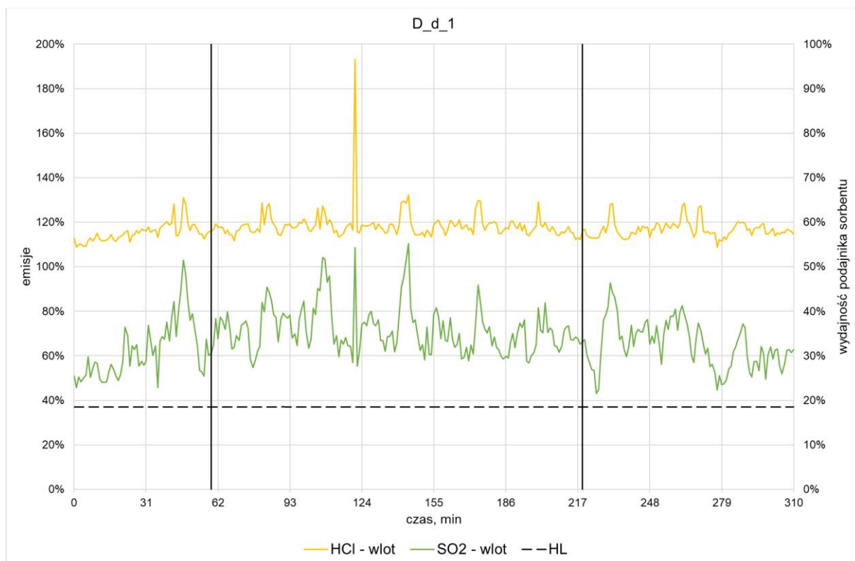
Rysunek 83 Test D_d_1, test nr 2: Stężenie SO 2 oraz HCl przed instalacją oczyszczania spalin. Strumień dozowanego do układu wapna hydratyzowanego - HL.
