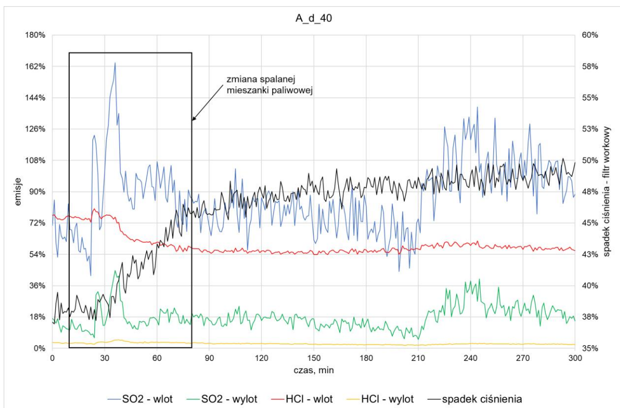
Rysunek 43 Test A_d_40, test nr 2: Stężenie SO 2 oraz HCl przed i za instalacją oczyszczania spalin. Spadek ciśnienia gazów przepływających przez filtr workowy.
