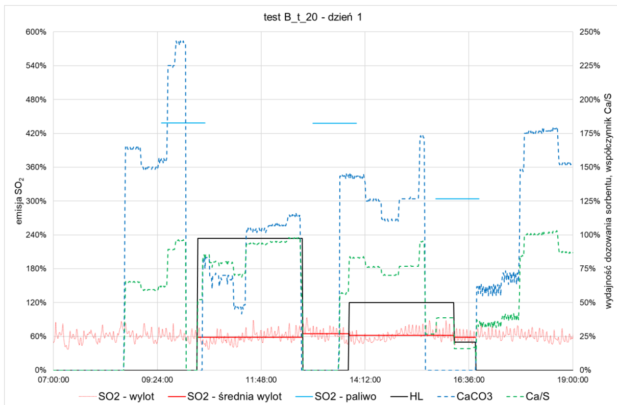
Rysunek 49 Test B_t_20, dzień 1: Stężenie chwilowe i średnie \text{SO}_2 na wylocie z instalacji oczyszczania spalin, wartości strumienia \text{CaCO}_3 dozowanego do komory paleniskowej, wartości emisji \text{SO}_2 wyliczonej na podstawie składu paliwa ( \text{SO}_2 – paliwo) oraz wartości współczynnika Ca/S.
