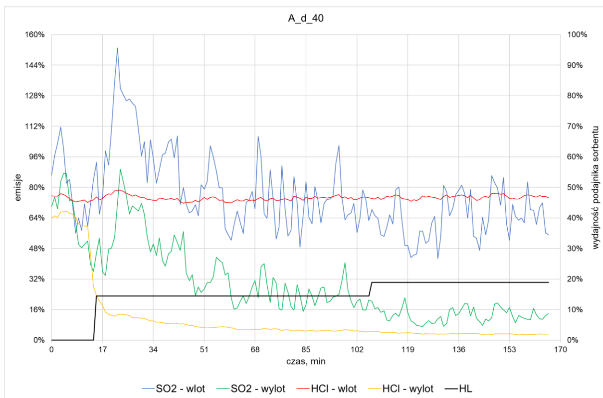
Rysunek 40 Test A_d_40, test nr 1: Stężenie SO 2 oraz HCl przed i za instalacją oczyszczania spalin. Strumień dozowanego do układu wapna hydratyzowanego - HL.
