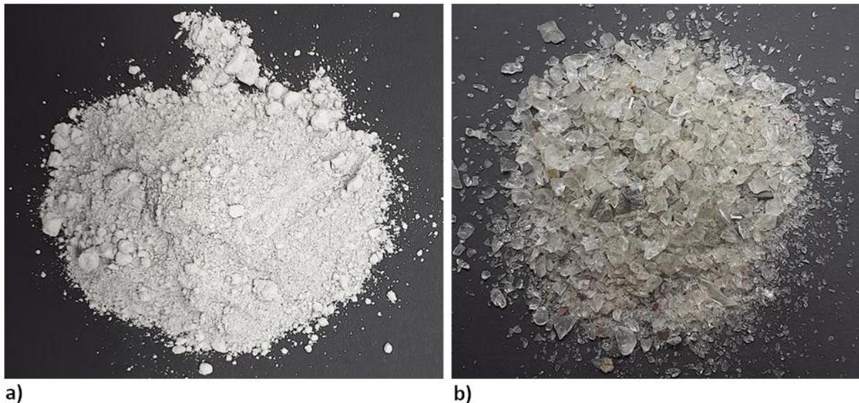
Fig.3.2.1: a) Metakaolin, b) CRT glass.
