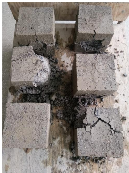
Rys. 3.32. Spękane próby z zawartością surowego popiołu dennego
