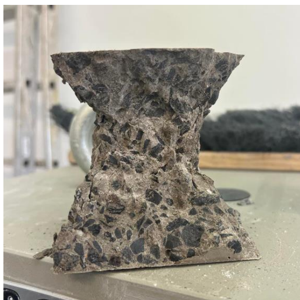
Rys. 3.36. Prawidłowe zniszczenie próby
