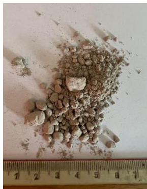
Rys. 1.18. Cement wapniowo siarczanoglinianowy (CSA)
