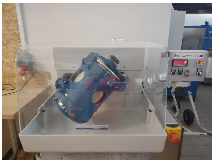
Rys. 36. Mieszalnik laboratoryjny do homogenizacji cementu
