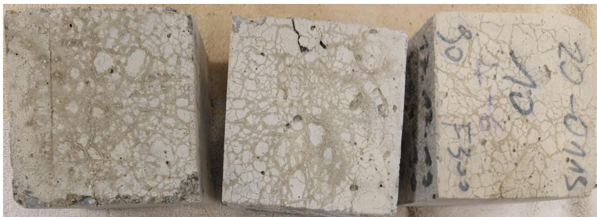
Rys. 82. Próbkę betonu XF4 z cementu CEM (50K-50LL) dojrzewające 90 dni zniszczone po 60 cyklach zamrażania-rozmrażania
