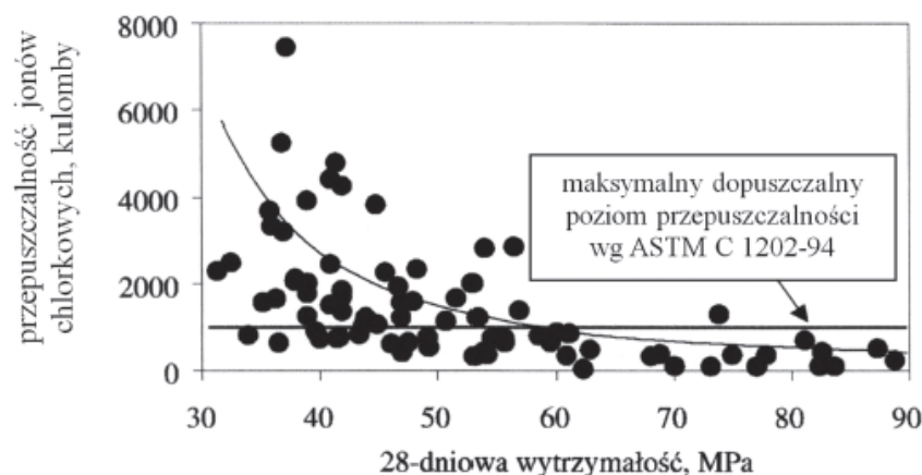
Rys. 21. Przepuszczalność jonów chlorkowych \text{Cl}^- w zależności od wytrzymałości betonu na ściskanie [132]
