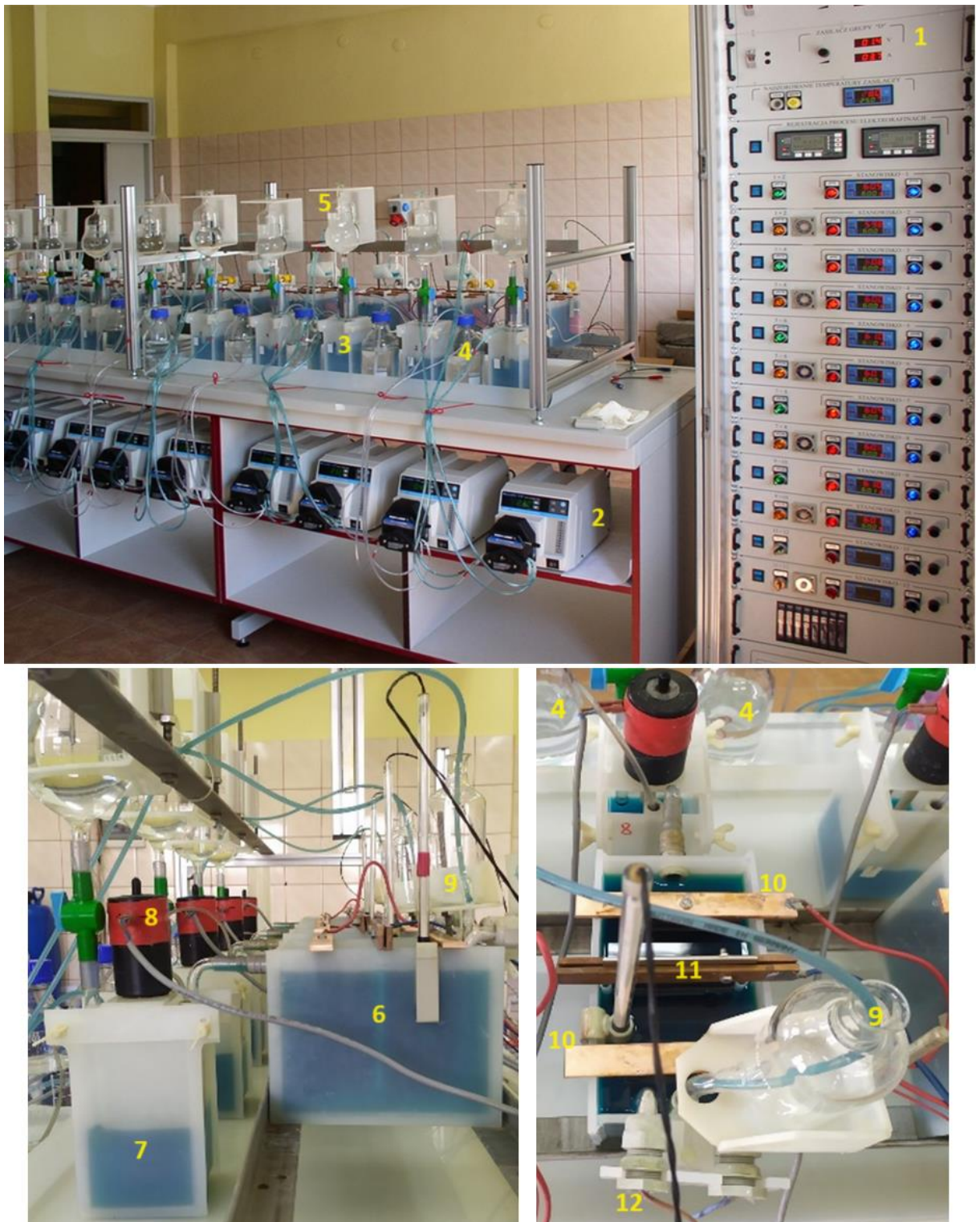
Rysunek 17. Stanowisko do badań procesów elektrorafinacji i elektrowydzielania metali (1 – szafa sterownicza; 2 – pompy perystaltyczne; 3 – układy obiegów cyrkulacyjnych elektrolitu; 4 – układy dozowania inhibitorów; 5 – układy ciągłego uzupełniania strat parowania; 6 – wanna elektrolityczna; 7 – zbiornik spływowy; 8 – mieszadło; 9 – zbiornik naporowy; 10 – szyny prądowe na których zawieszono są anody; 11 – szyna prądowa, na której zawieszona jest katoda; 12 – układ grzania elektrolitu w wannach elektrolitycznych)
