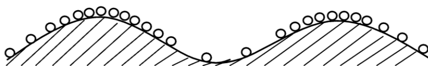
Rysunek 6. Schematyczne rozmieszczenie cząstek kleju na powierzchni katody z widocznym zagęszczeniem molekuł kleju na wypukłościach katody [4]
