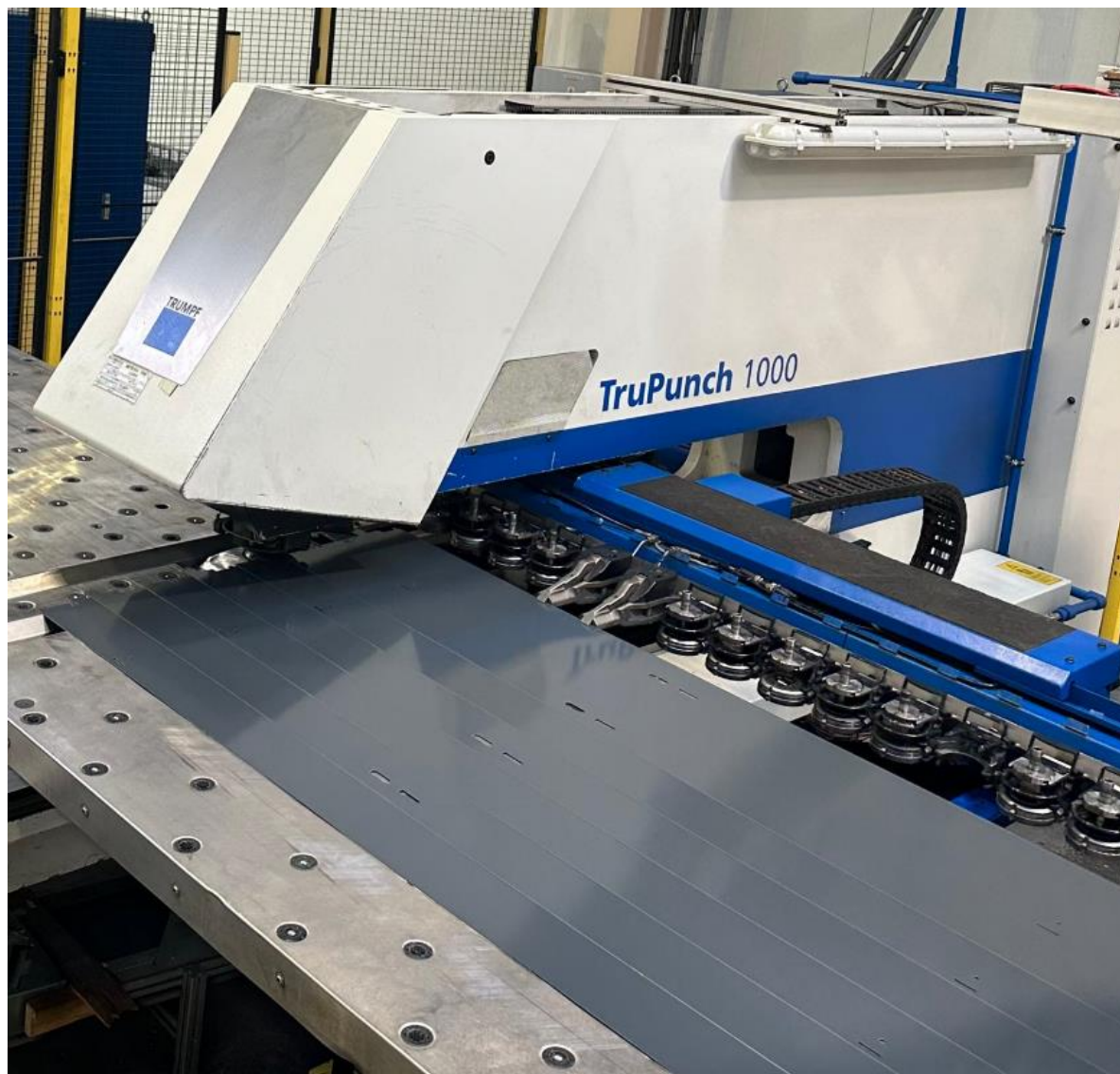
Rys. 17. Proces wykrawania formatek profili ościeżnicowych
