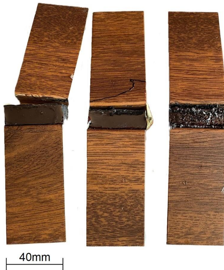
Rys. 38. Próbkki A1200 po rozciąganiu [opracowania własne]
