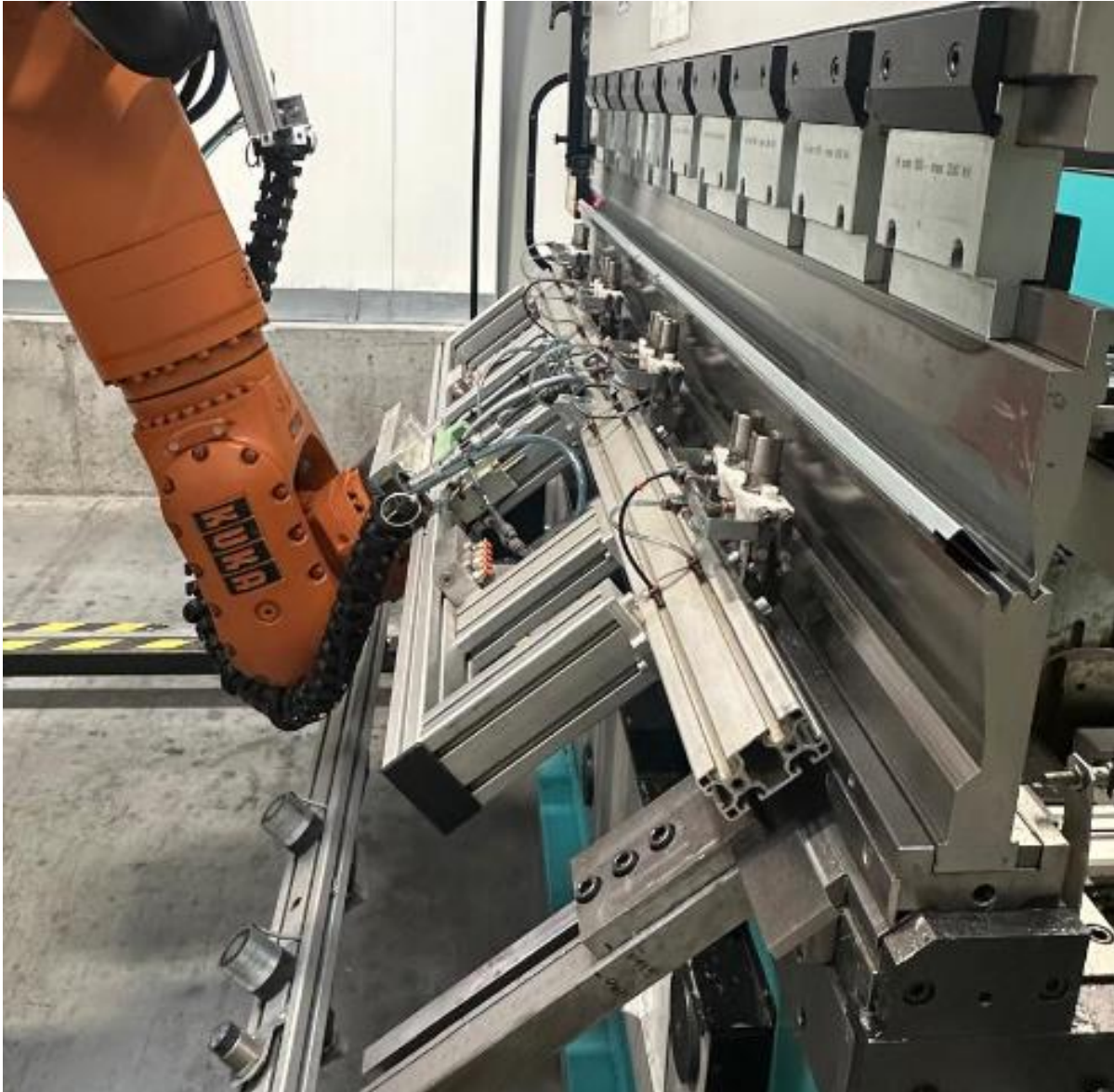
Rys. 19. Proces krawędziowania formatek ościeżnic. Krawędziarka VIMERCATI, KUKA KR150
