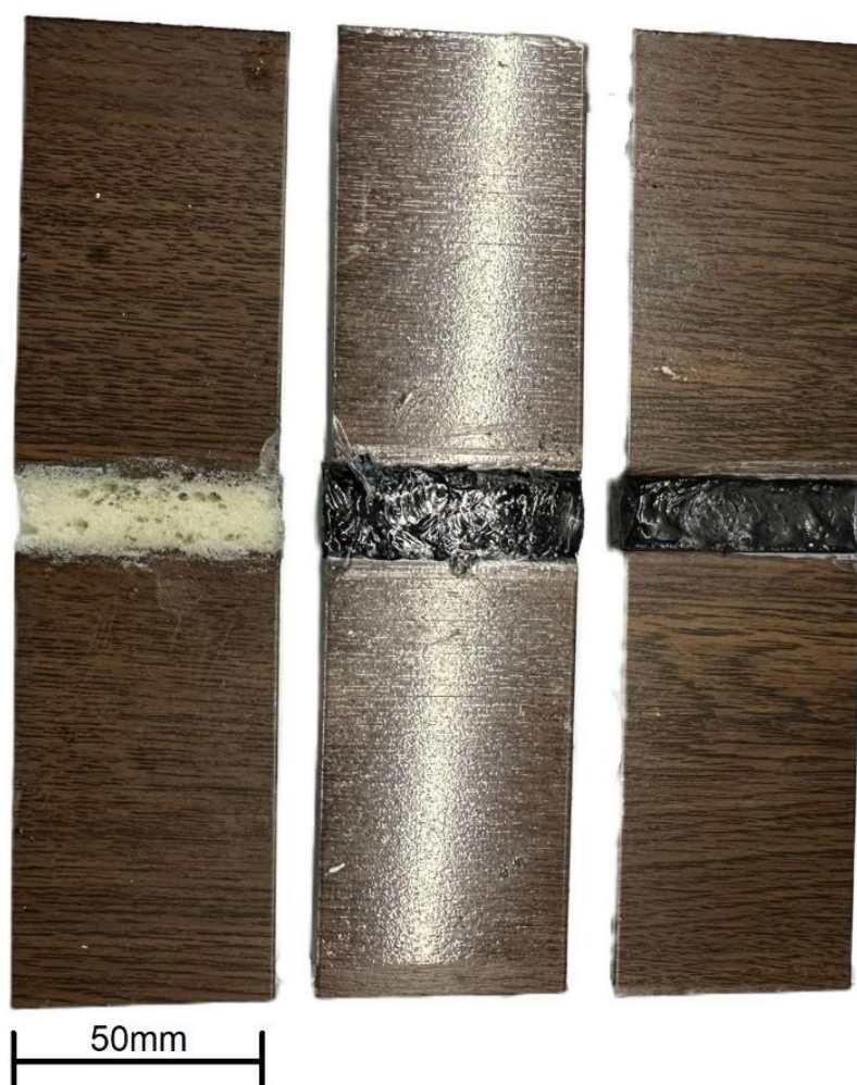
Rys. 16. Przekrój przygotowanych próbek od lewej: 1) Próbka C30S, 2) Próbka A600S 3) Próbka A1200S [opracowania własne]
