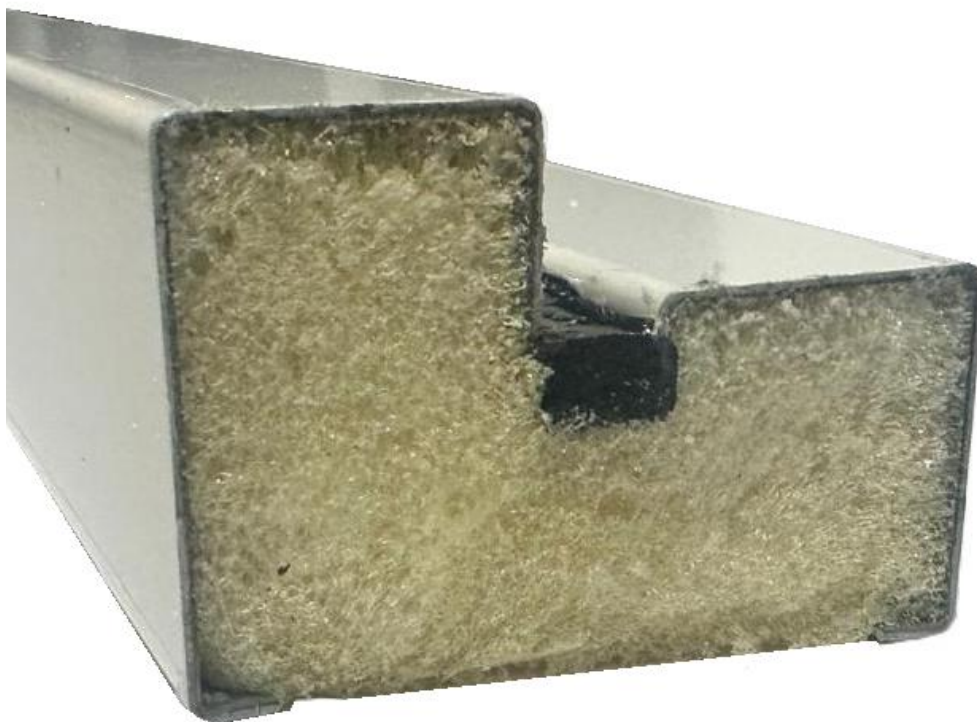
Rys. 11. Prototyp ościeżnicy z przekładką poliuretanową [opracowania własne]
