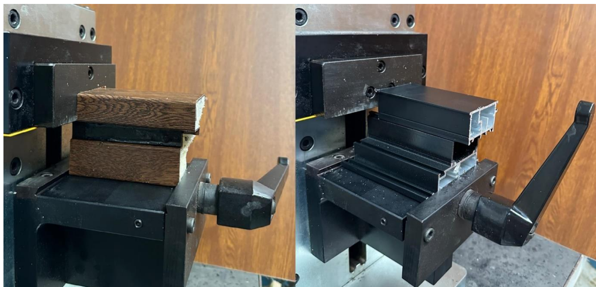
Rys. 51. Próbkę po badaniu wytrzymałości na ścinanie. Od lewej: próbka profilu A1200S, próbka ościeżnicy aluminiowej z przekładką poliamidu
