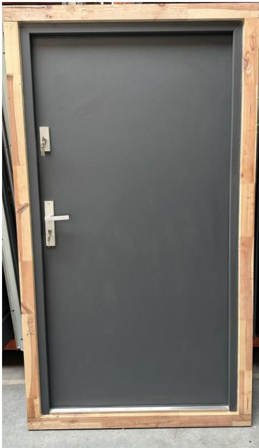
Rys. 22. Złożone skrzydło z ościeżnicą w ramie badawczej
