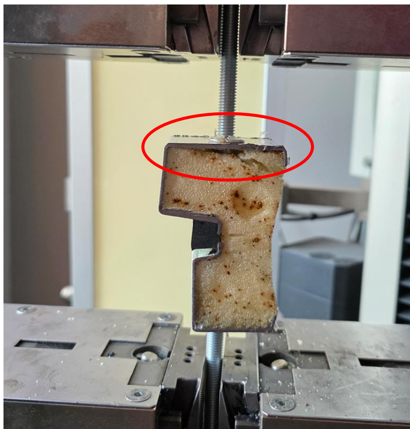
Rys. 50 Widok próbki po badaniu wytrzymałości na rozciąganie po starzeniu
