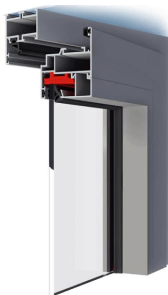
Rys. 6. Przekrój ościeżnicy monolitycznej [62]
