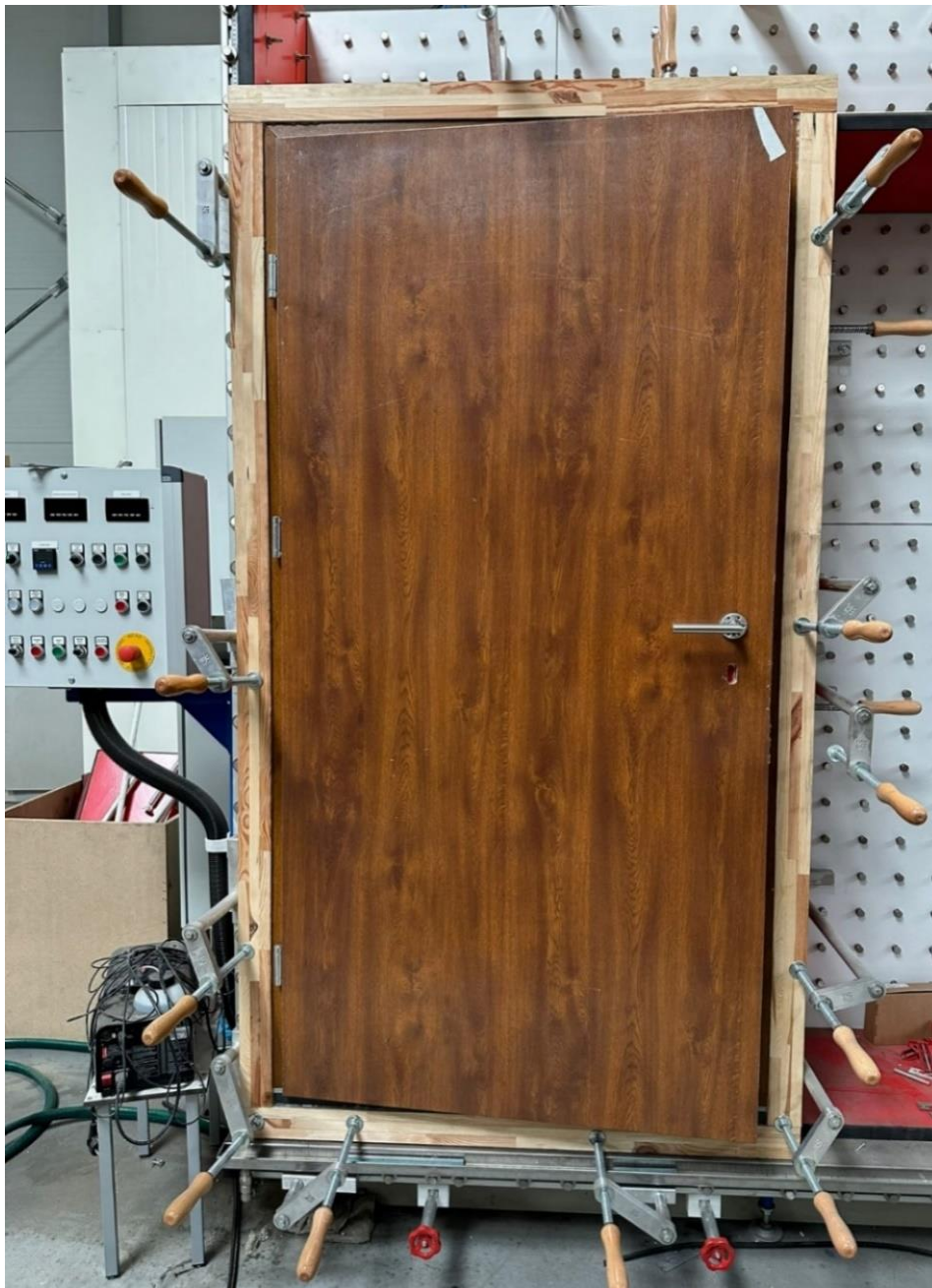
Rys. 29. Zmontowana próbka drzwi do badań wodoszczelności
