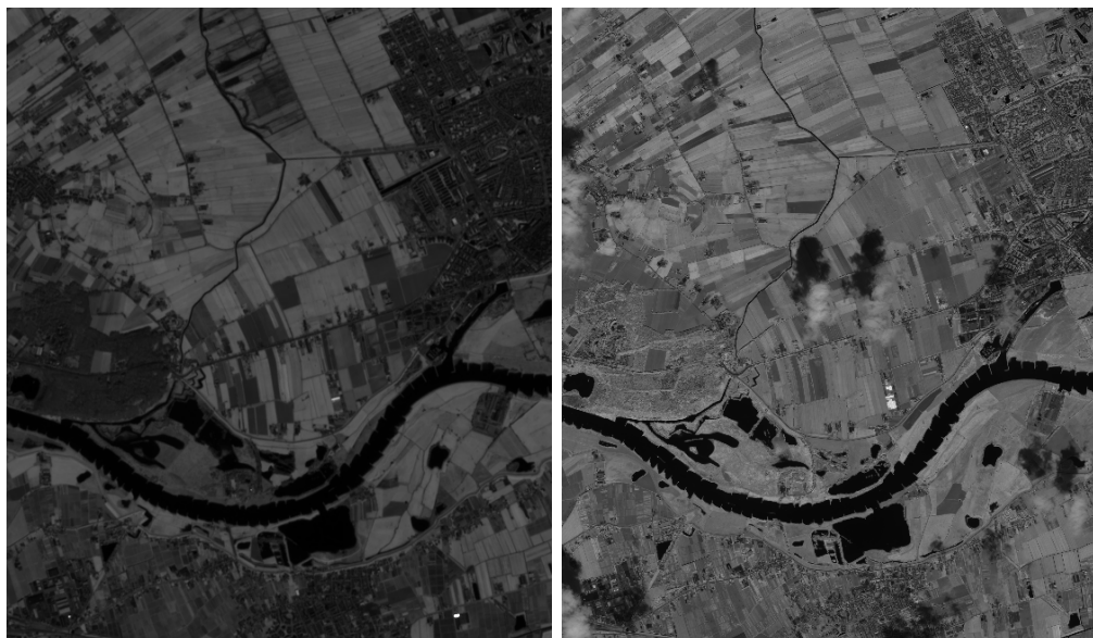
Rysunek 3.4: Porównanie wyglądu obrazów z różnych źródeł. Po lewej - obraz niskiej rozdzielczości z satelity Sentinel-2, po prawej - ten sam obszar widziany przez instrumenty misji WorldView-2 [24]
