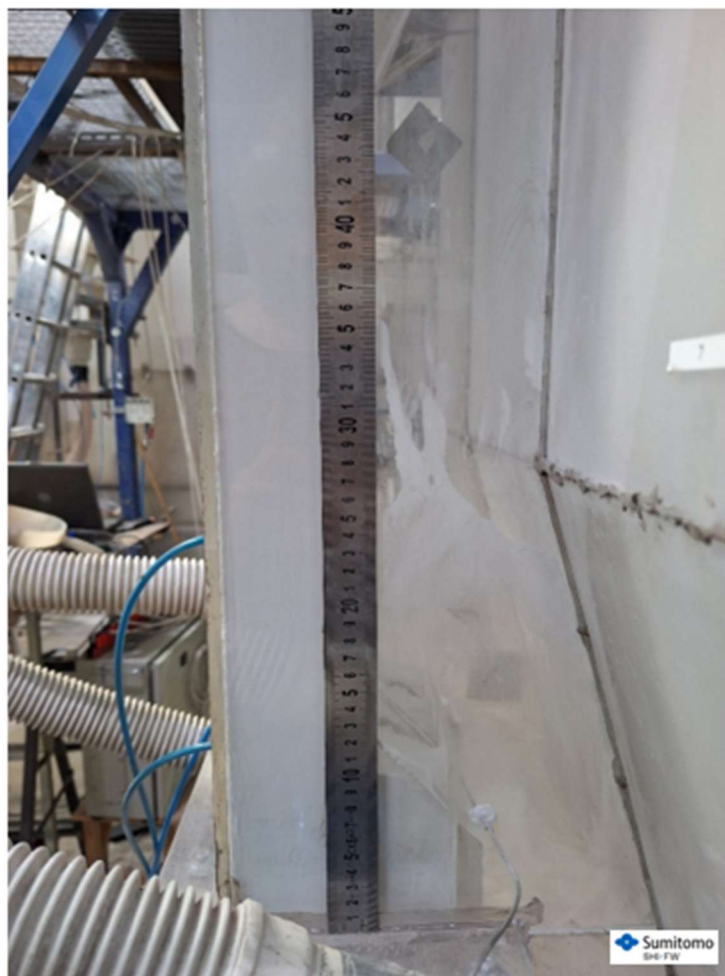
Rys. 42. Liniał na boku nogi opadowej w celu kontroli wysokości słupa gromadzącego się materiału cyrkulującego.
