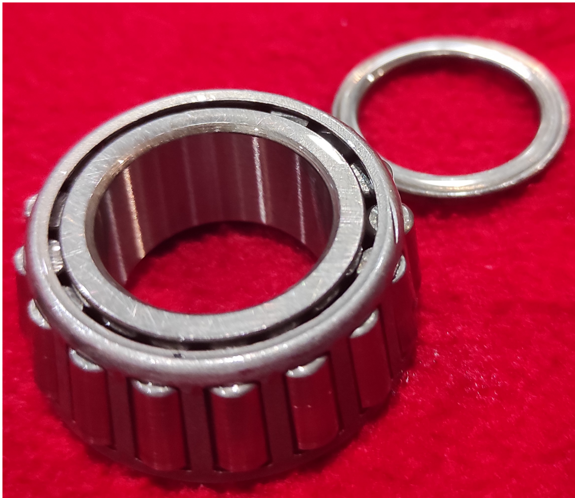
Rysunek 3.1: Uszkodzone łożysko wału (górne) - wytarcie wewnętrznej bieżni wyczuwalne palcem.
