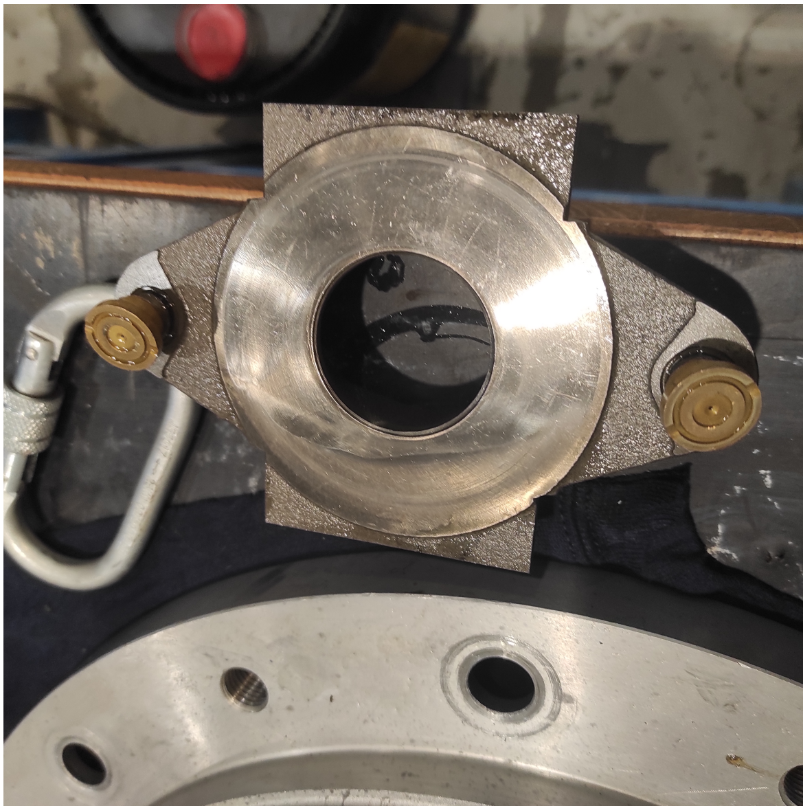
Rysunek 3.2: Uszkodzona kołyska - zniekształcenie powierzchni wyczuwalne palcem.
