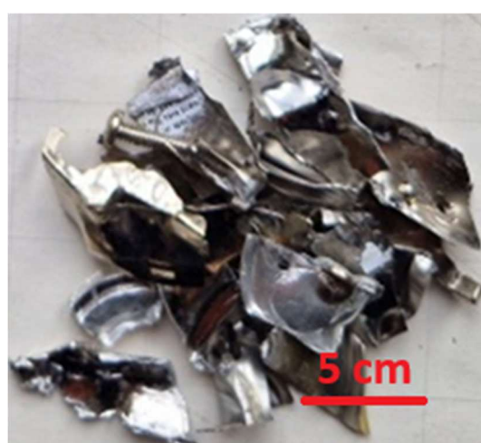
Rys. 6.7. Częstki stalowej pokrywy obudowy HDD.
