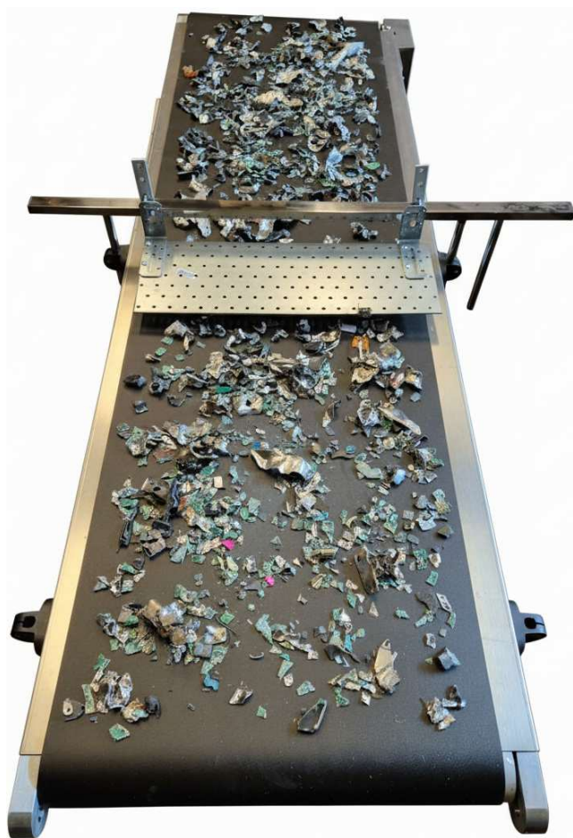
Rys. 5.12. Stanowisko separacji pasywnej.
