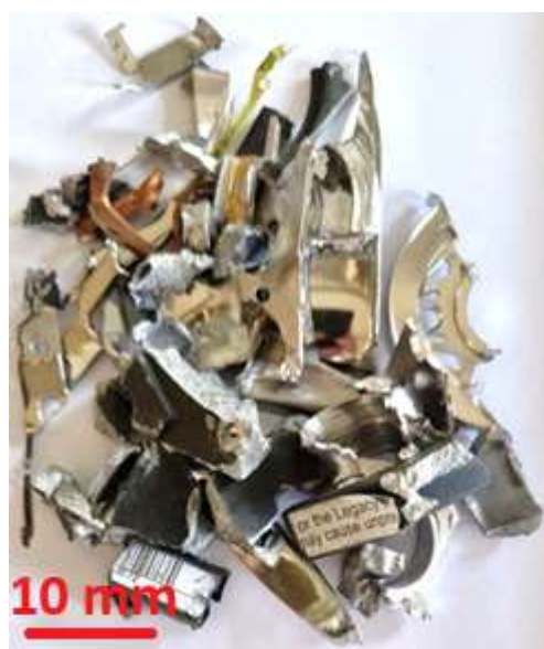
Rys.6.21. Wydzielona cząstki aluminium o uziarnieniu 10-3,15 mm.
