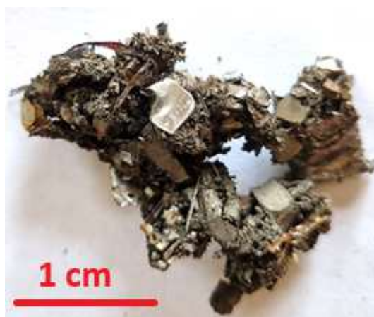
Rys. 6.10. Wyodrębnione cząstki magnesów neodymowych z elementami stali ferromagnetycznej.
