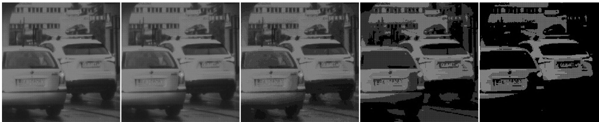
Rysunek 5.5. Przykładowy fragment klatki filmu po wyzerowaniu kolejno 0, 3, 8, 10, 11 ostatnich bitów rozdzielczości skali szarości
