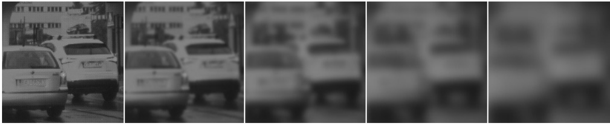
Rysunek 5.4. Przykładowy fragment klatki filmu z wprowadzonymi różnymi poziomami rozmycia Gaussa. Od lewej - oryginał i rozmycia na poziomach 9, 27, 45 i 65
