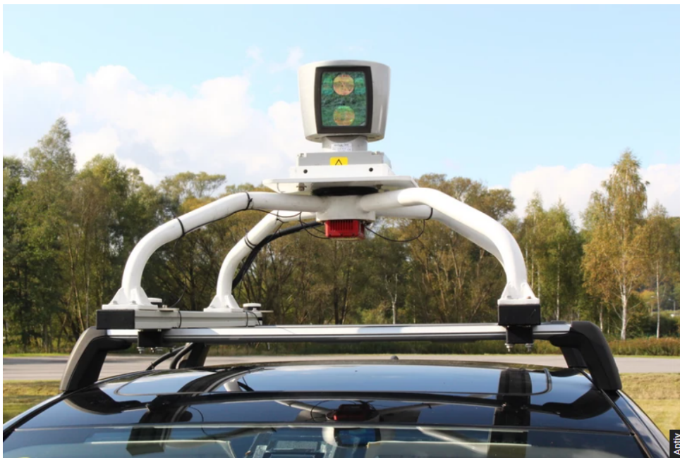
Rysunek 2.4. Lidar zamontowany na dachu samochodu testowego na torze Aptiv [42]
