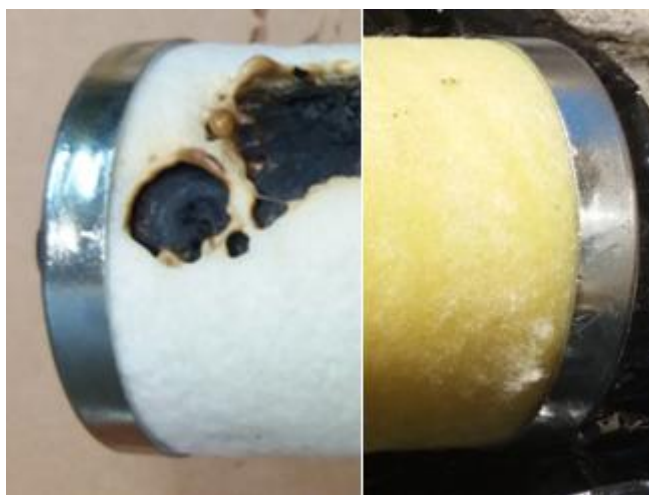
Rys. 10. Uszkodzony separator oleju (z lewej), porównany do separatora prawidłowo zużytego (z prawej).
