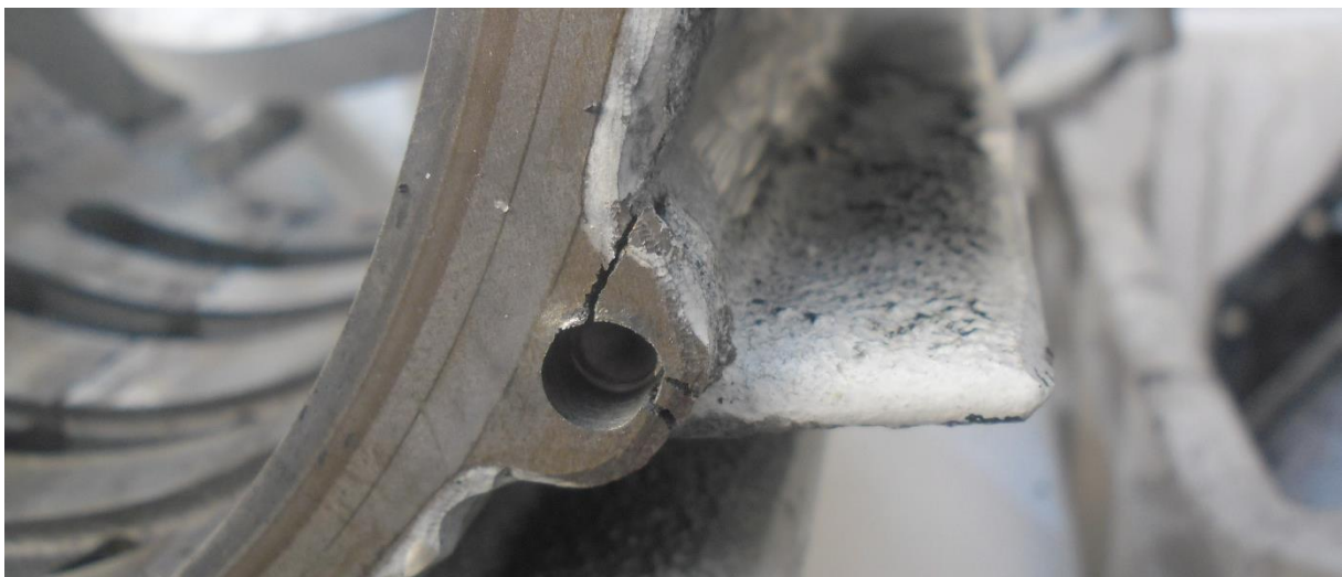
Rys. 17. Uszkodzenie gniazda ustalającego kolka stożkowego, znajdującego się w cylindrze pompy, na skutek nagłego zablokowania wirnika pompy.
