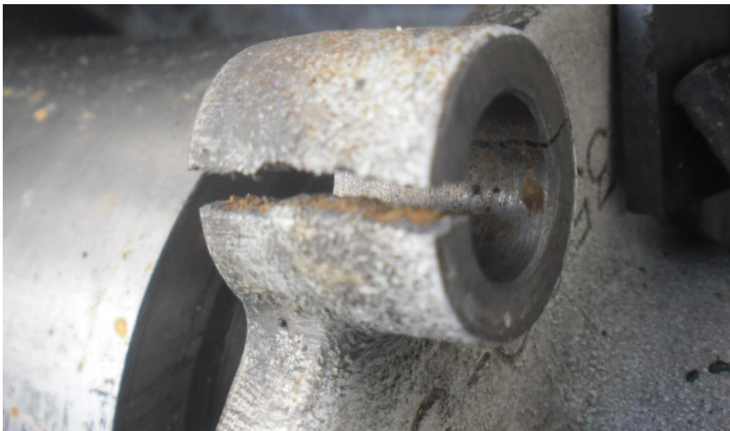
Rys. 19. Uszkodzenie otworu pod śrubą mocującą, w pokrywie rotacyjnej łopatkowej pompy próżniowej, na skutek nagłego zablokowania wirnika.
