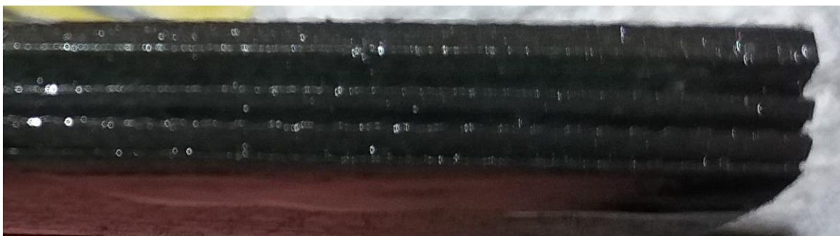
Rys. 11. Widok czola rozwarstwionej łopatki.
