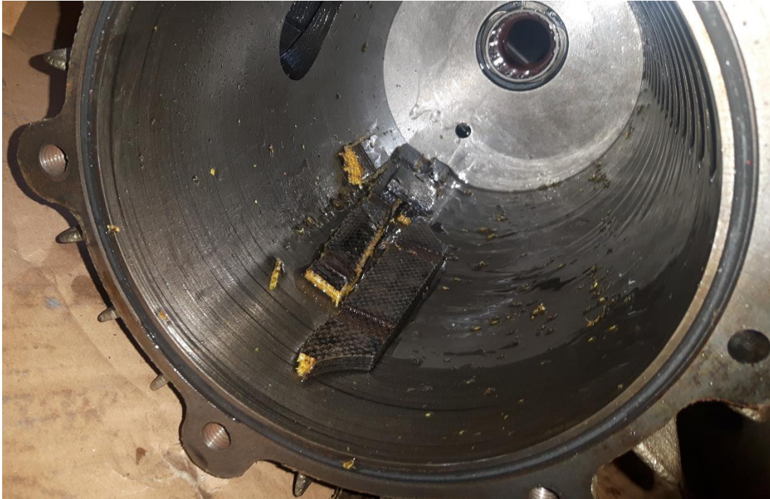
Rys. 14. Widok złamanej łopatki w cylindrze rotacyjnej olejowej pompy próżniowej.
