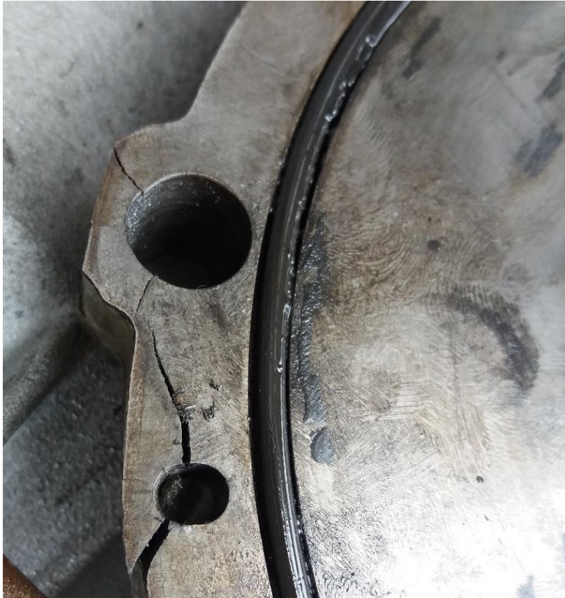
Rys. 18. Uszkodzenie gniazd kolka ustalającego i śruby mocującej, w pokrywie rotacyjnej łopatkowej pompy próżniowej, na skutek nagłego zablokowania wirnika.
