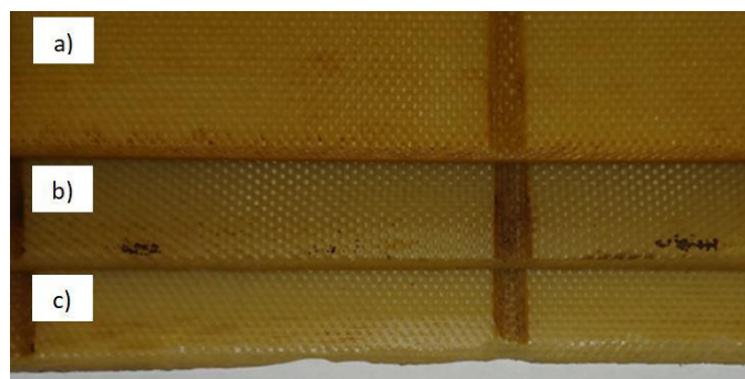
Rys. 46 Łopatki użyte w trakcie czynnego eksperymentu diagnostycznego (a - łopatka nieuszkodzona, b - łopatka lekko uszkodzona, c - łopatka mocno uszkodzona). [15]
