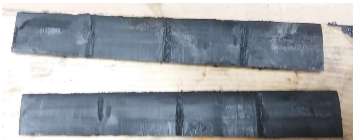
Rys. 13. Przykład nieregularnie zużytych łopatek.
