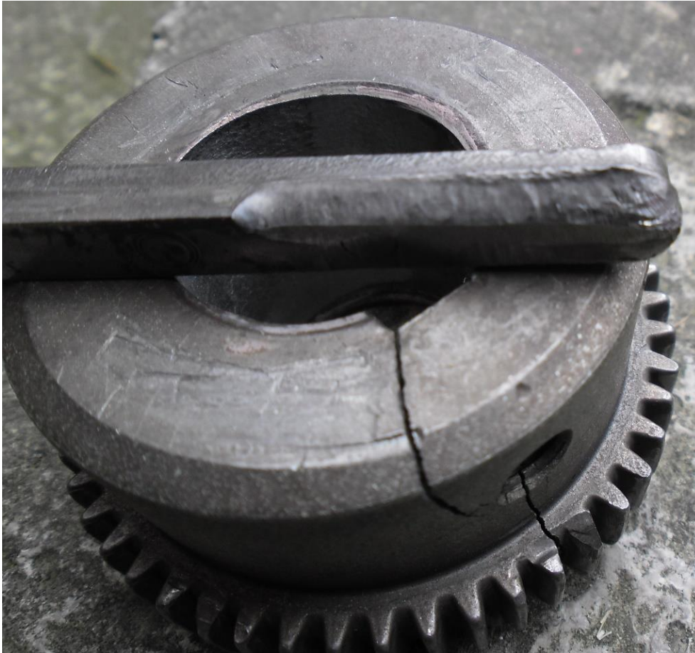
Rys. 20. Uszkodzenie sprzęgła, na skutek nagłego zablokowania wirnika rotacyjnej łopatkowej pompy próżniowej.
