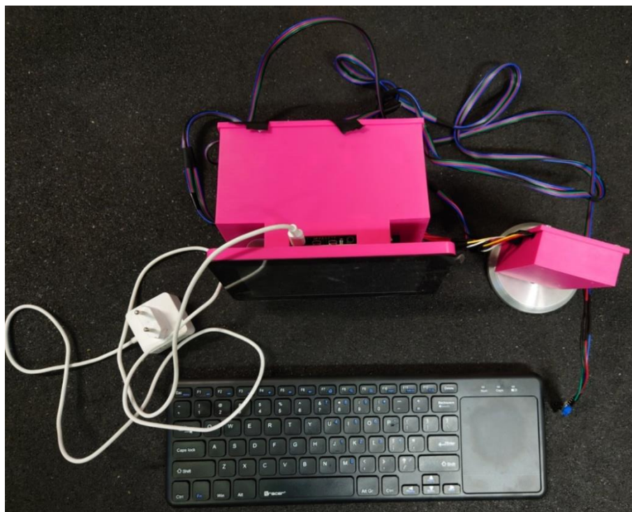
Rys. 28 Zbudowany rejestrator ciśnienia.
