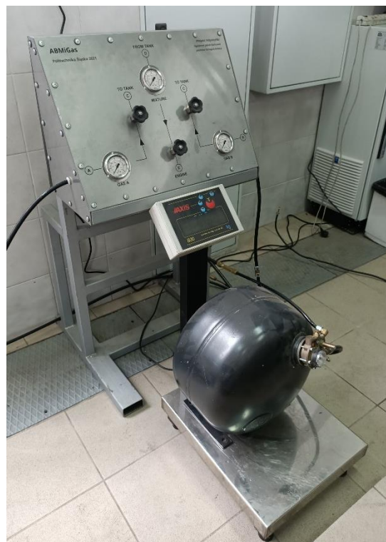
Rys. 4.3. Kompletnie stanowisko do wytwarzania mieszanin paliwowych
