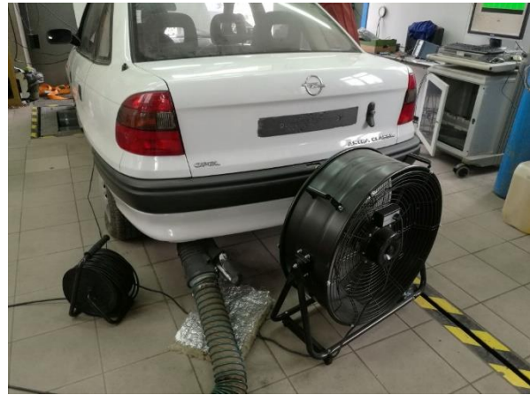
Rys. 4.6. Pojazd na stanowisku z dodatkowym chłodzeniem układu wydechowego raz wyciągiem spalin
