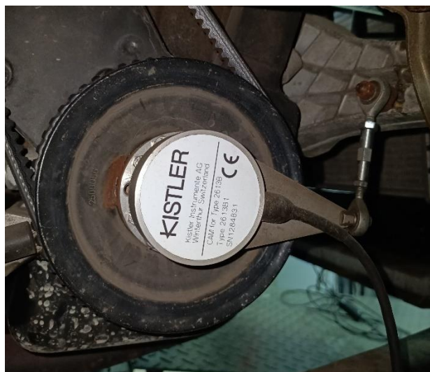
Rys. 4.9. Znacznik z czujnikiem fotooptycznym Kistler 2613B
