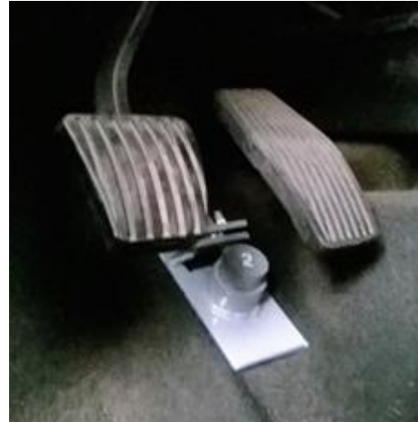
Rys. 4.16. Podkładka z trzpieniem zmontowana w miejscu oryginalnego odboju
