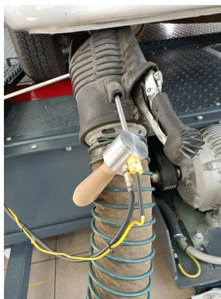
Rys. 4.19A. Sonda analizatora umieszczona w końcówce układu wydechowego
