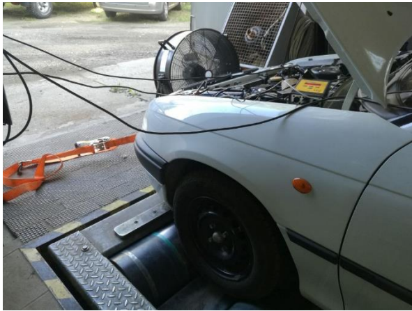
Rys. 4.5. Przednia oś pojazdu na rolkach hamowni
