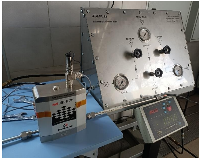
Rys. 4.11. Przepływomierz masowy Bronkhorst mini Cori Flow na stanowisku badawczym
