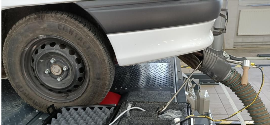
Rys. 4.19B. Sonda analizatora umieszczona w końcówce układu wydechowego
