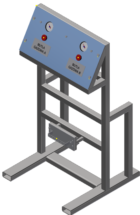
Rys. 4.2. Rysunek w programie graficznym ramy stanowiska z panelem sterującym
