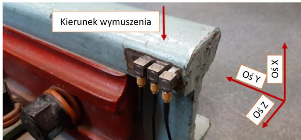
Rysunek 54 Kierunek osi pomiarowych zamontowanych czujników przyspieszenia.
