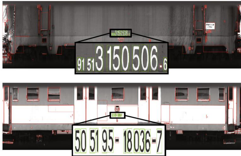
Rysunek 14. Przykłady segmentacji obszaru tekstu na dwóch różnych wagonach. Na zielono ramka graniczna podzielona na segmenty po udoskonaleniu RANSAC. Źródło: [85].
