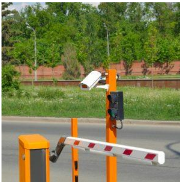
Rysunek 1. System ANPR polskiego producenta zamontowany na szlabanie drogowym w celu identyfikacji pojazdów. Źródło: www.szymkowiak.pl .
