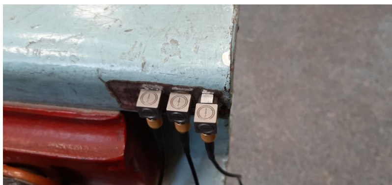
Rysunek 52. Akcelerometry Endevco zamontowane na oczyszczonej bocznej ścianie głowki szyny. Kolejno (od lewej): montaż na klej cyjanoakrylowy, воск pszczeli i fabryczne akcesorium czujników – magnes. Źródło: opracowanie własne.
