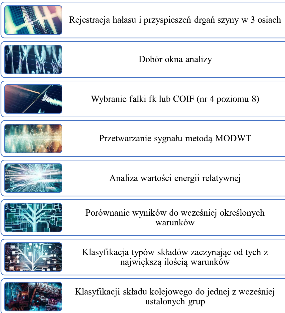
Rysunek 94 Zaproponowana metoda identyfikacji pojazdów na podstawie sygnałów wibroakustycznych przy pomocy metody MODWT. Źródło: opracowanie własne, Grafika: DALL-E
