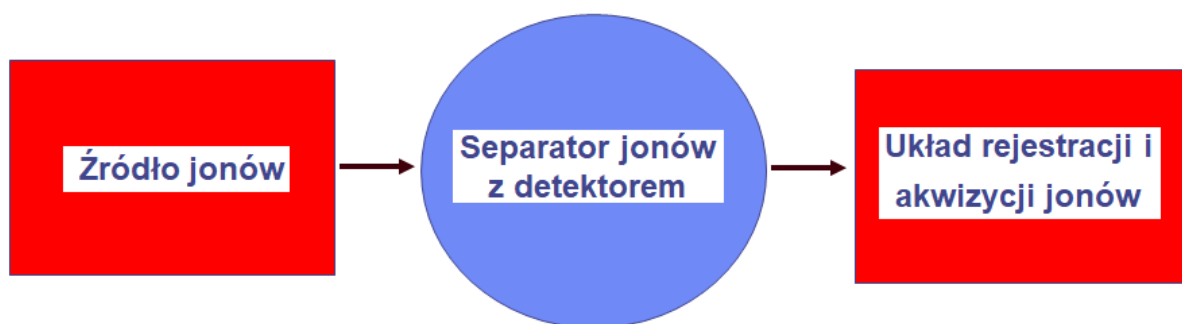
Rys. 2.1. Ogólna idea spektrometru masowego
