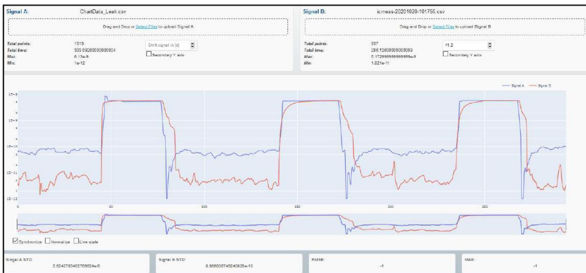
Rys. 5.10. Zestawienie porównawcze poziomu nieszczelności wzorcowej He dla urządzenia GLD10 (niebieska linia) względem urządzenia referencyjnego PHOENIX Quadro firmy Leybold (czerwona linia)
