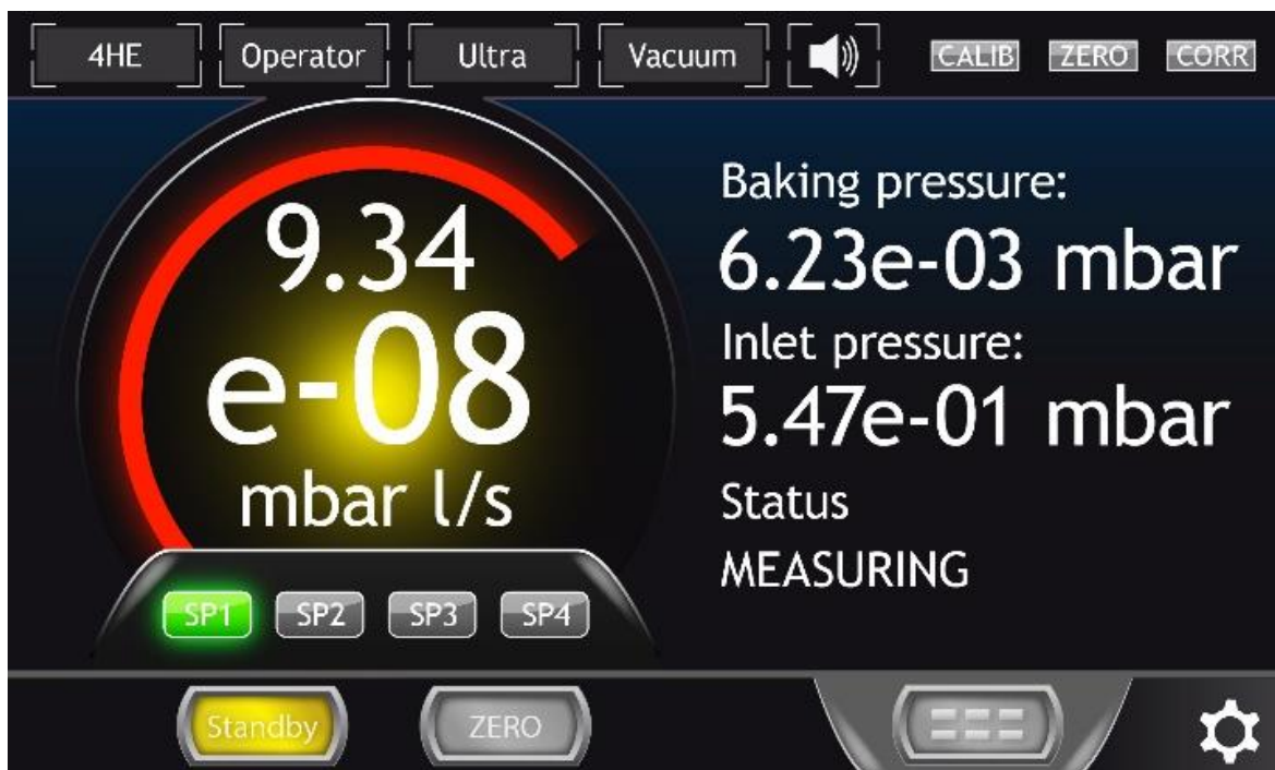
Rys. 4.10. Widok ekranu modułu sterowania własnego detektora nieszczelności GLD10, z możliwością wyświetlania parametrów użytkowych pracy samego urządzenia.
