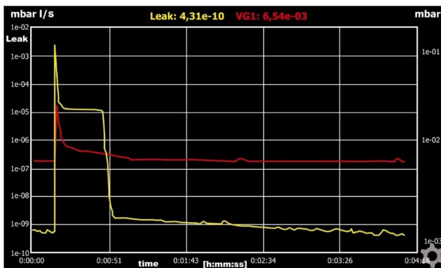
Rys. 4.11. Przykładowy przebieg rejestracji poziomu nieszczelności w czasie dla własnego detektora nieszczelności GLD10 (bezpośredni widok z ekranu modułu sterowania spektrometru mas)
