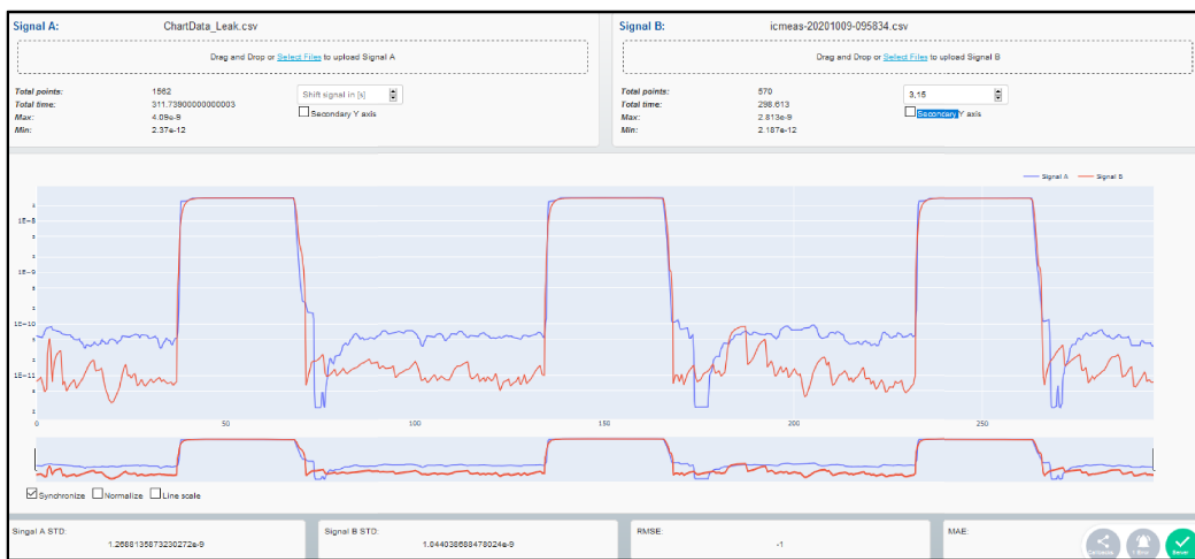
Rys. 5.8. Zestawienie porównawcze poziomu nieszczelności wzorcowej He dla urządzenia GLD10 (niebieska linia) względem urządzenia referencyjnego PHOENIX Quadro firmy Leybold (czerwona linia)
