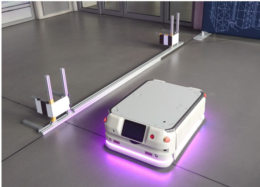
Rysunek 9.3: Stanowisko testowe do eksperymentów z dokowaniem platformy AGV Formica 3 do znaczników 2DM-RC zamontowanych na lewej i prawej nodze AS.
