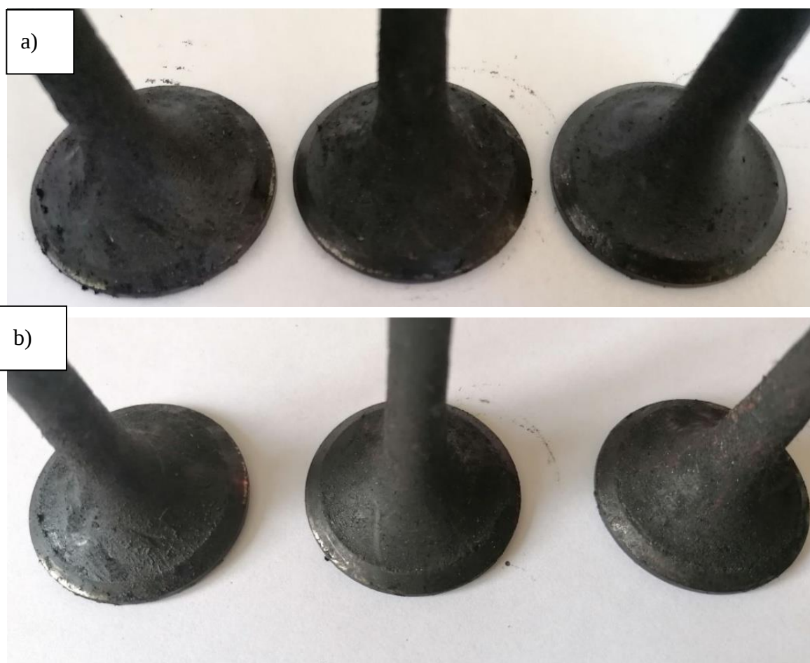
Rys. 12.18. Widok zaworów po eksploatacji w badanej jednostce napędowej dostosowanej do zasilania gazem ziemnym: a) z przyłgnią wzmocnioną Fe 3 Al, b) z przyłgnią wzmocnioną Stelitem 6
