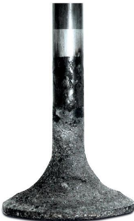
Rys. 5.10. Powstawanie osadów na powierzchni przylgni w wyniku napływu gorących gazów spalinowych[61]
