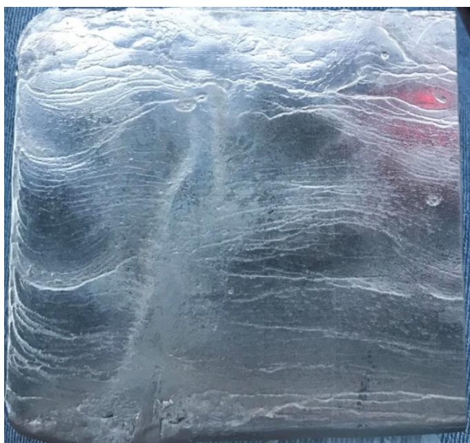
Rys. 9.1. Uzyskana sztaba intermetalalu \text{Fe}_3\text{Al} (opracowanie własne)
