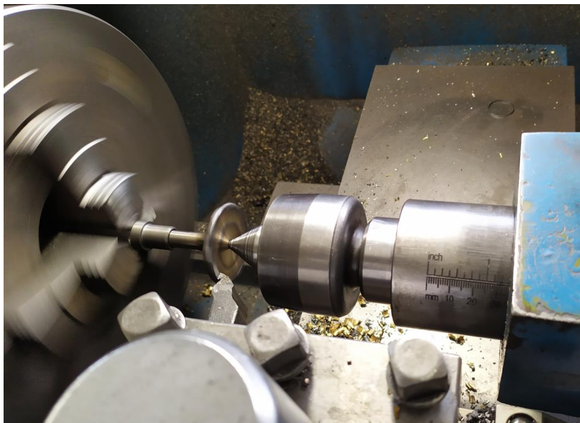
Rys. 12.2. Obróbka toczna talerzyka zaworu
