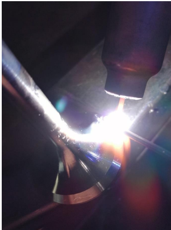
Rys. 9.3. Proces napawania przylgni zaworu wydechowego spoiwem z fazy międzymetalicznej \text{Fe}_3\text{Al} (opracowanie własne)
