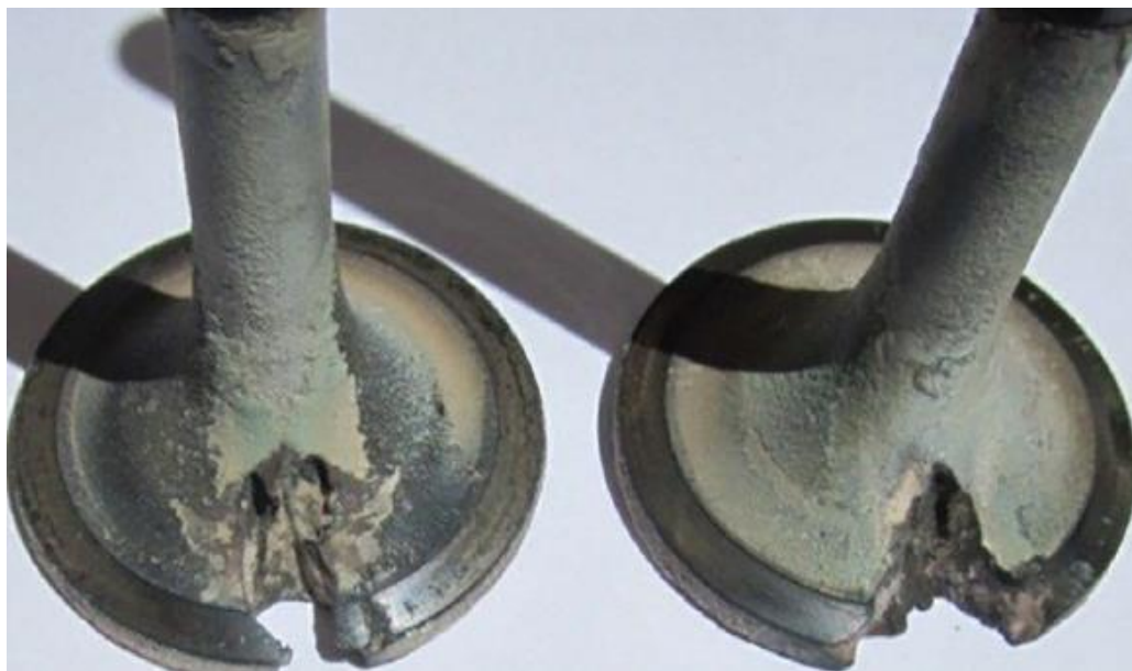
Rys. 5.5. Uszkodzenie powierzchni przylgni zaworu wydechowego w silniku ZS zasilanym olejem napędowym [59]
