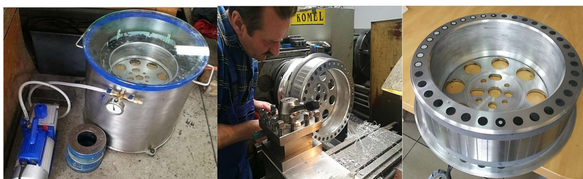
Rys.14.7. Montaż uzwojonego stojana z konstrukcją wsporczą: a) montaż konstrukcji wsporczej z tarczą od strony przeciwnapędowej, b) montaż stojana z elementem konstrukcji wsporczej z radiatorami strony napędowej, c) stojan uzwojony osadzony na konstrukcji wsporczej z radiatorami bocznymi, d) stojan zalany w żywicy epoksydowej w komorze ciśnieniowej, e) obróbka stojana po zalaniu w żywicy epoksydowej, f) gotowy stojan
