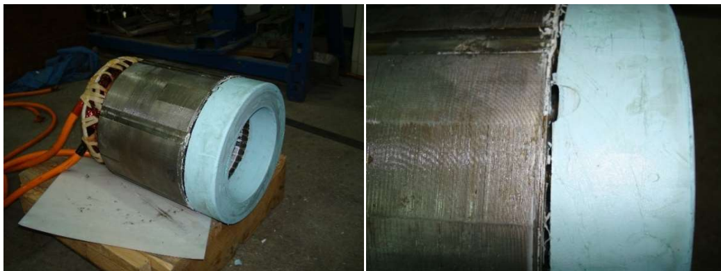
Rys. 6.1. Czoła silnika typu SMwsg160-L4 produkcji Sieć Badawcza Łukasiewicz Instytut Napędów i Maszyn Elektrycznych KOMEL a) czoła uzwojenia zalane kauczukiem silikonowym po badaniach laboratoryjnych b) rozwarstwienie pomiędzy silikonem, a rdzeniem magnetycznym.
