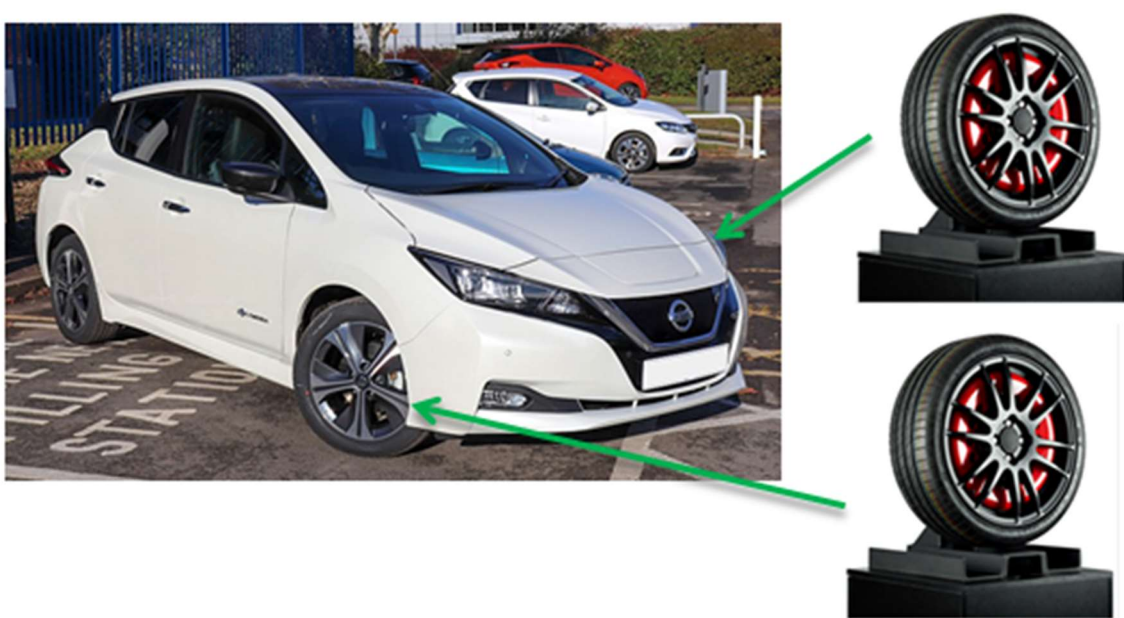
Rys.11.1. Samochód Nissan Leaf rozpatrywany w symulacjach pracy napędu z dwoma silnikami w kołach
