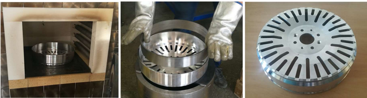
Rys.14.5. Montaż rdzenia magnetycznego w wirniku: a) wirnik aluminiowy umieszczony w piecu, b) „wrzucenie” schłodzonego rdzenia wirnika, c) gotowy wirnik, widok od strony felgi
