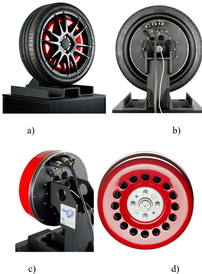
Rys.5.4.Silnik SMzs200S32 wyprodukowany w Sieci Badawczej Łukasiewicz – Górnośląski Instytut Technologiczny : a) silnik z zamontowanym kołem - widok od strony napędowej b) silnik z zamontowanym kołem - widok od strony przeciwnapędowej c) silnik - widok od strony przeciwnapędowej d) silnik - widok od strony napędowej [108].
