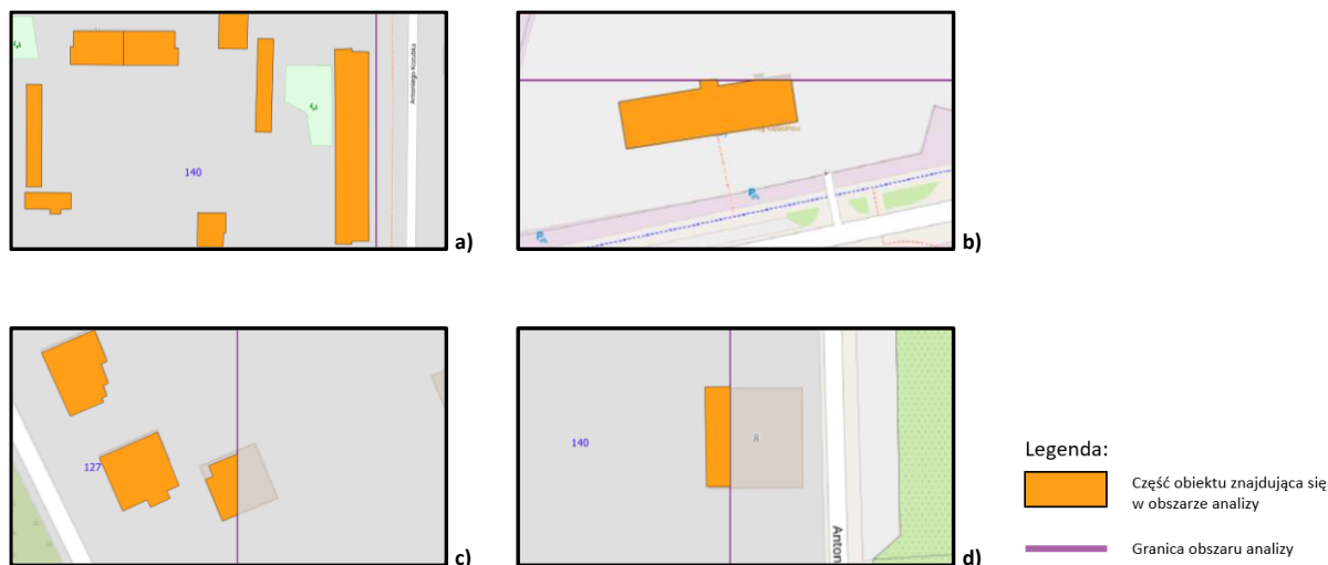
Rys. 4.2 Przykłady lokalizacji obiektów zagospodarowania przestrzennego przy granicy obszaru analizy: a) 100% powierzchni obiektu w obszarze analizy, b) ok. 95% powierzchni obiektu w obszarze analizy, c) ok. 50% powierzchni obiektu w obszarze analizy, d) ok. 25% powierzchni obiektu w obszarze analizy
