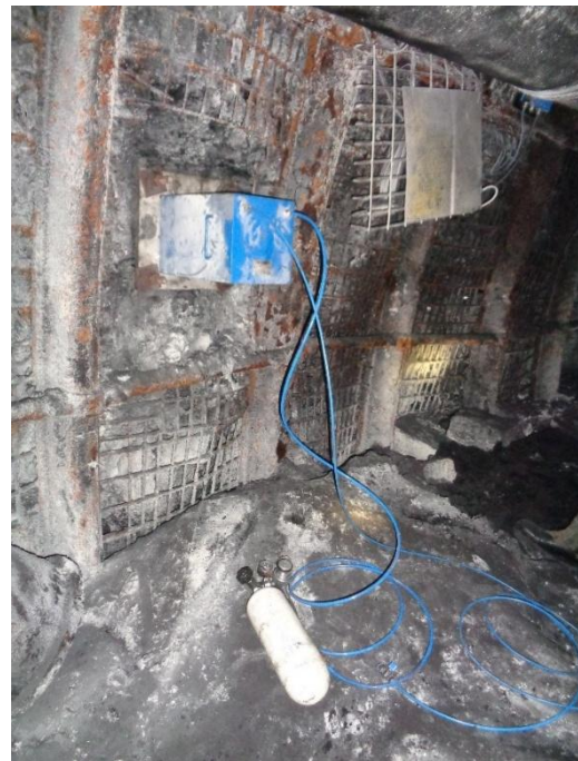
Rys. 8.2. Schemat pomiarowy oraz realizacja stanowiska badawczego w rejonie pokładu 510 w partii Aw. Wzbudnik zasilany z butli gazowej oraz wyzwalany ręcznie.
