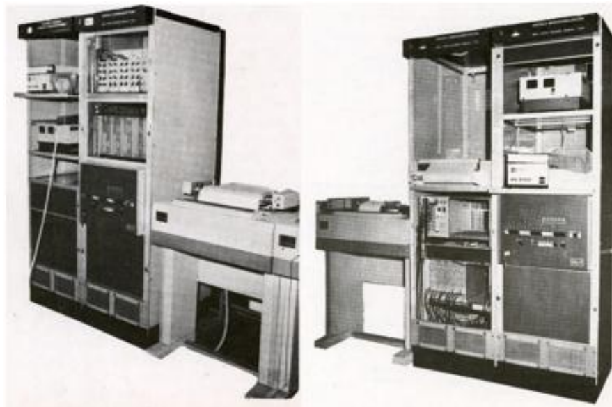
Rys. 6.1. Minikomputerowe systemy z analogową transmisją danych SAK z lewej i SYLOK z prawej.
