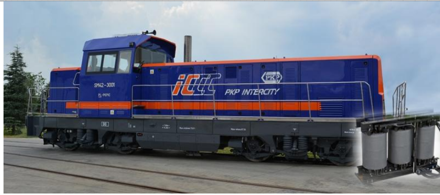
Rysunek 5 Lokomotywa SM42, w której zaprojektowano i wykonano zamiennik transformatora z rdzeniem z materiału nanokrystalicznego do potrzeb własnych o mocy 400 kVA wraz ze zdjęciem transformatora [95].
