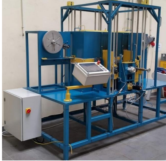
Rysunek 19 Prototypowe urządzenie do ultraszybkiej obróbki cieplnej taśm amorficznych w układzie pracy ciągłej
