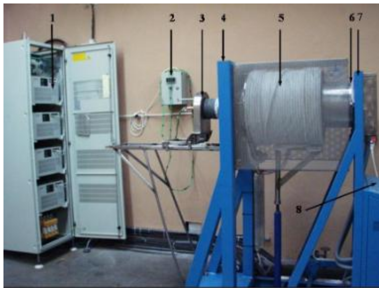
Rysunek 15 Piec do obróbki termomagnetycznej: (1) - zespół zasilacza cewki, (2) - wskaźniki temperatury, (3) - pokrywa zamykająca zintegrowana z podajnikiem rdzeni, (4) - konstrukcja podtrzymująca cewkę, (5) - cewka, (6) - moduł grzewczy, (7) - konstrukcja podtrzymująca moduł grzewczy, (8) - pulpit sterowniczy.
