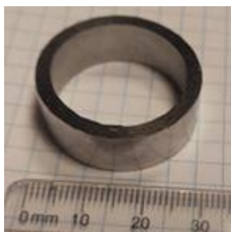
Rysunek 77 Rdzeń wykonany z taśmy stopu Fe 67 Co 20 B 13 po obróbce cieplnej w temperaturze 500°C w czasie 1 s.
