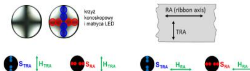
Rysunek 58 Krzyż konoskopowy i matryca LED, orientacje sygnałów S i pól magnetycznych H oraz orientacja próbki w mikroskopie w trakcie badań magnetoptycznych. Kierunek RA – wzdłuż osi taśmy, kierunek TRA – poprzecznie do osi taśmy [95].
