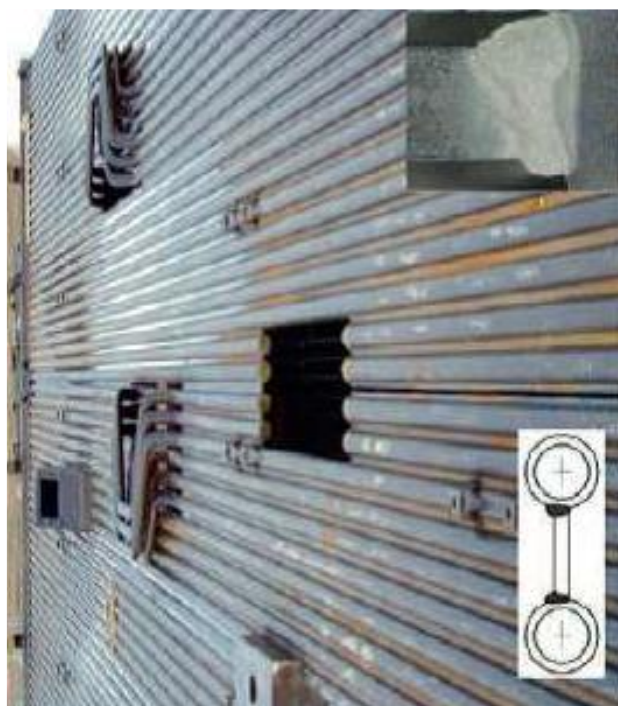
rys.6. Ściany szczelne kotłów spawane metodą hybrydową w Energoinstal S.A. [10]
