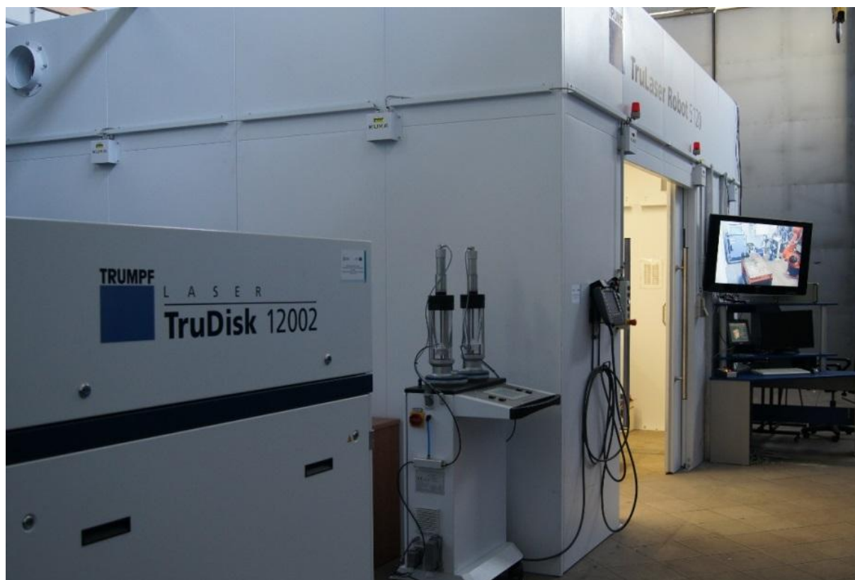
rys. 9. Stanowisko zrobotyzowane z laserem dyskowym w GIT-Łukasiewicz Centrum Spawalnictwa
