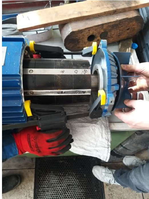
Rys.17. Wysuwanie magnesów trwałych [opracowanie własne]
