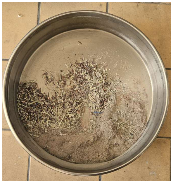
Rys.68. Nadawa stanowiąca mieszaninę miedzi i tworzywa sztucznego [opracowanie własne]
