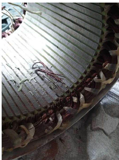
Rys.19. Usuwanie laminatu z rowków stojanach [opracowanie własne]
