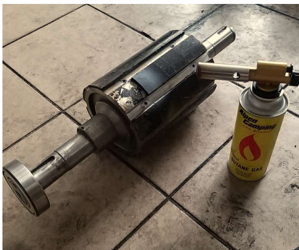
Rys.18. Demontaż magnesów NdFeB z wykorzystaniem palnika gazowego [opracowanie własne]
