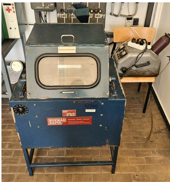
Rys.67. Separator „Boxmag-Rapid [opracowanie własne]
