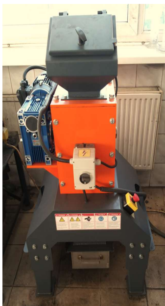
Rys.32. Kruszarka laboratoryjna Mawo-tech MKL1x1,5 [opracowanie własne]
