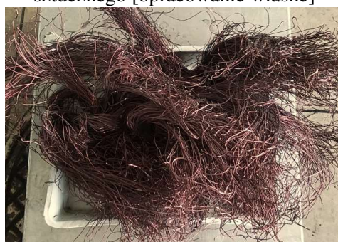
Rys.27. Uzwojenie miedziane stojana [opracowanie własne]
