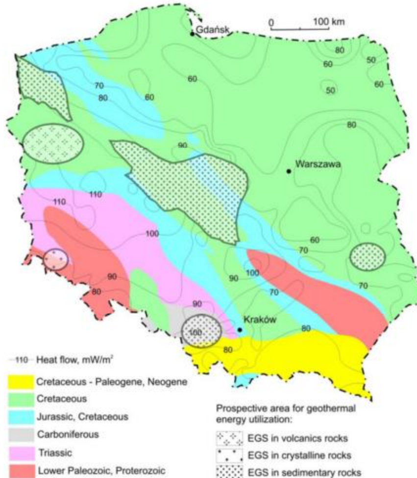
Figura 3.1: Perspektywiczne rejony EGS w Polsce na tle uproszczonej budowy geologicznej i gęstości strumienia ciepłego.
