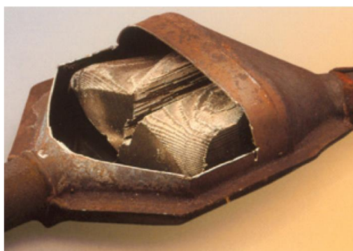
Rys. 19. Uszkodzenie ceramicznego konwertera wskutek uderzenia [8]
