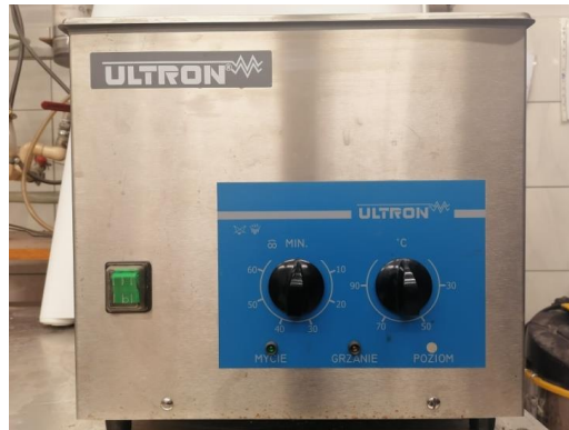
Rys. 38. Łażnia ultradźwiękowa Ultron wykorzystana do przygotowania próbek nośnika ceramicznego
