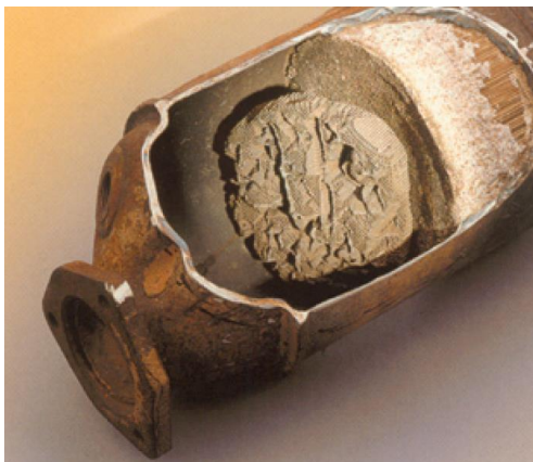
Rys. 18. Pęknięcia i nadtopienia ceramicznego konwertera wskutek przegrzania [8]
