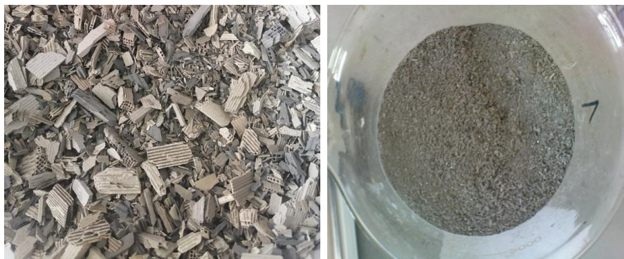
Rys. 39. Nośnik ceramiczny katalizatora samochodowego: (a) - po ręcznym kruszeniu oraz (b) - po homogenizacji w młynie kulowym
