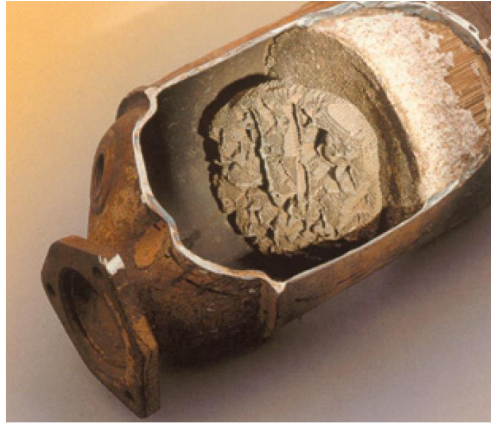
Rys. 18. Pęknięcia i nadtopienia ceramicznego konwertera wskutek przegrzania [8]
