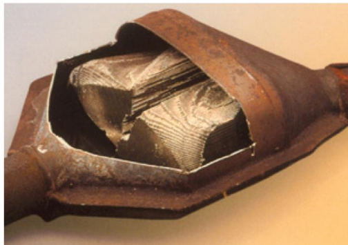
Rys. 19. Uszkodzenie ceramicznego konwertera wskutek uderzenia [8]
