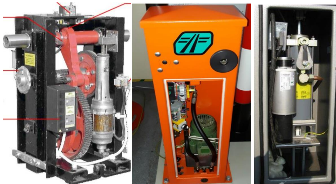
Rys. 3.3 Elektryczne napędy rogatkowe – od lewej kolejno: zmodernizowany elektryczny napęd rogatkowy JEGD50M220 [25], elektrohydrauliczny napęd rogatkowy RHR-95 [26], elektrohydrauliczny napęd rogatkowy HSM 10E [26]
