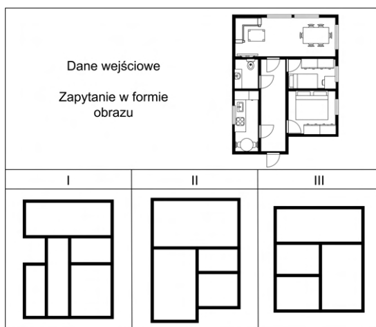
Rysunek 2.6: Wizualizacja zadania wyszukiwania obrazem. Obraz zapytania ( u góry ) służy do przeszukania bazy danych w celu znalezienia 3 najbardziej podobnych planów pięter ( na dole ).
