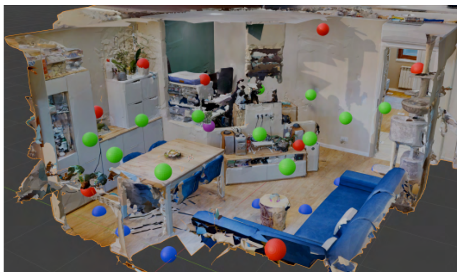
Rysunek 5.19: Wizualizacja modelu trójwymiarowego mieszkania w programie Blender, widok z naniesieniem punktów charakterystycznych. Sfery czerwone oznaczają kotwice systemu radiowego. Sfery niebieskie pokazują położenie punktu charakterystycznego w płaszczyźnie podłogi dla każdego ze stanowisk pomiarowych. Sfery zielone reprezentują położenie mobilnych lokalizatorów radiowych (punktów charakterystycznych na poziomie lokalizatorów umieszczonych na trójnogach). Sfery fioletowe to lokalizatory umiejscowione statycznie.
