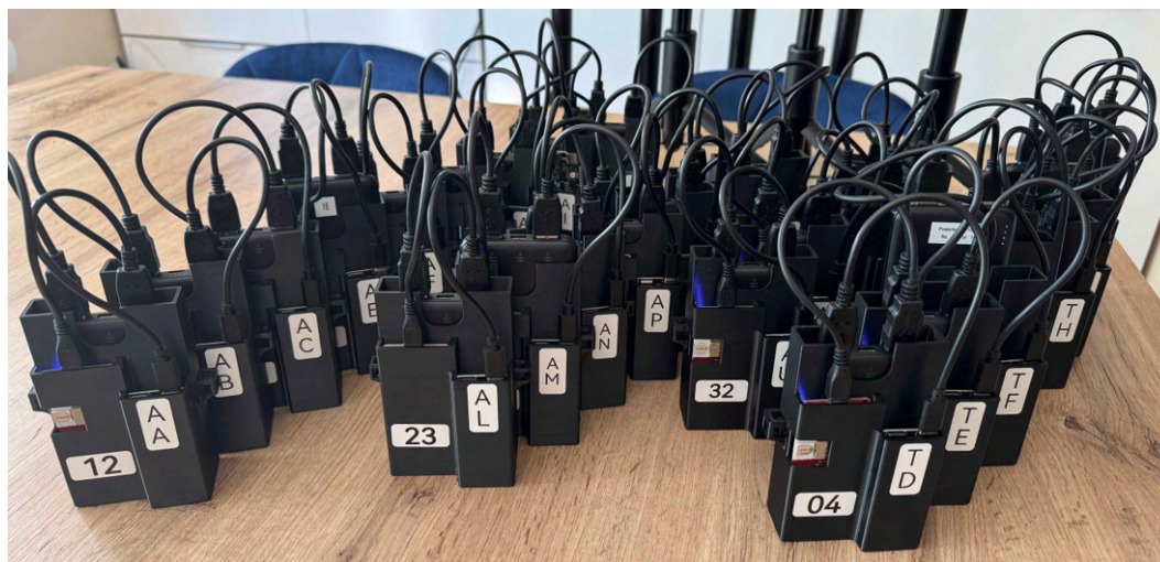
Rysunek 5.9: Zdjęcie skonstruowanych urządzeń radiowych podczas pracy i z podłączonym zasilaniem.
