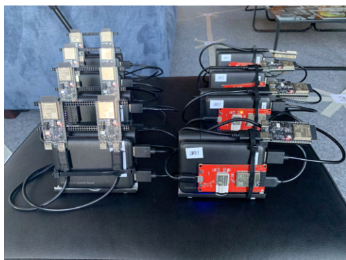
(a) Zbudowane urządzenia lokalizacyjne obu technologii radiowych: BLE (po lewej) i UWB (po prawej).
