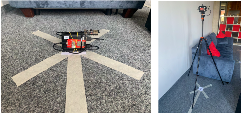
Rysunek 3.15: Urządzenie śledzące umieszczone w punkcie pomiarowym P1 w konfiguracji na podłodze (po lewej) oraz na wysokości 150 cm (po prawej).
