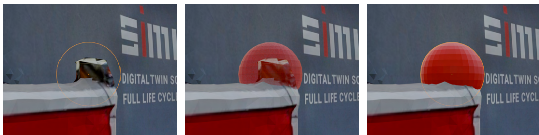
Rysunek 3.17: Wizualizacja obudowania lokalizatora sferą (z lewej: 100% nieprzezroczystości, środek: 50%, z prawej: 0%).
