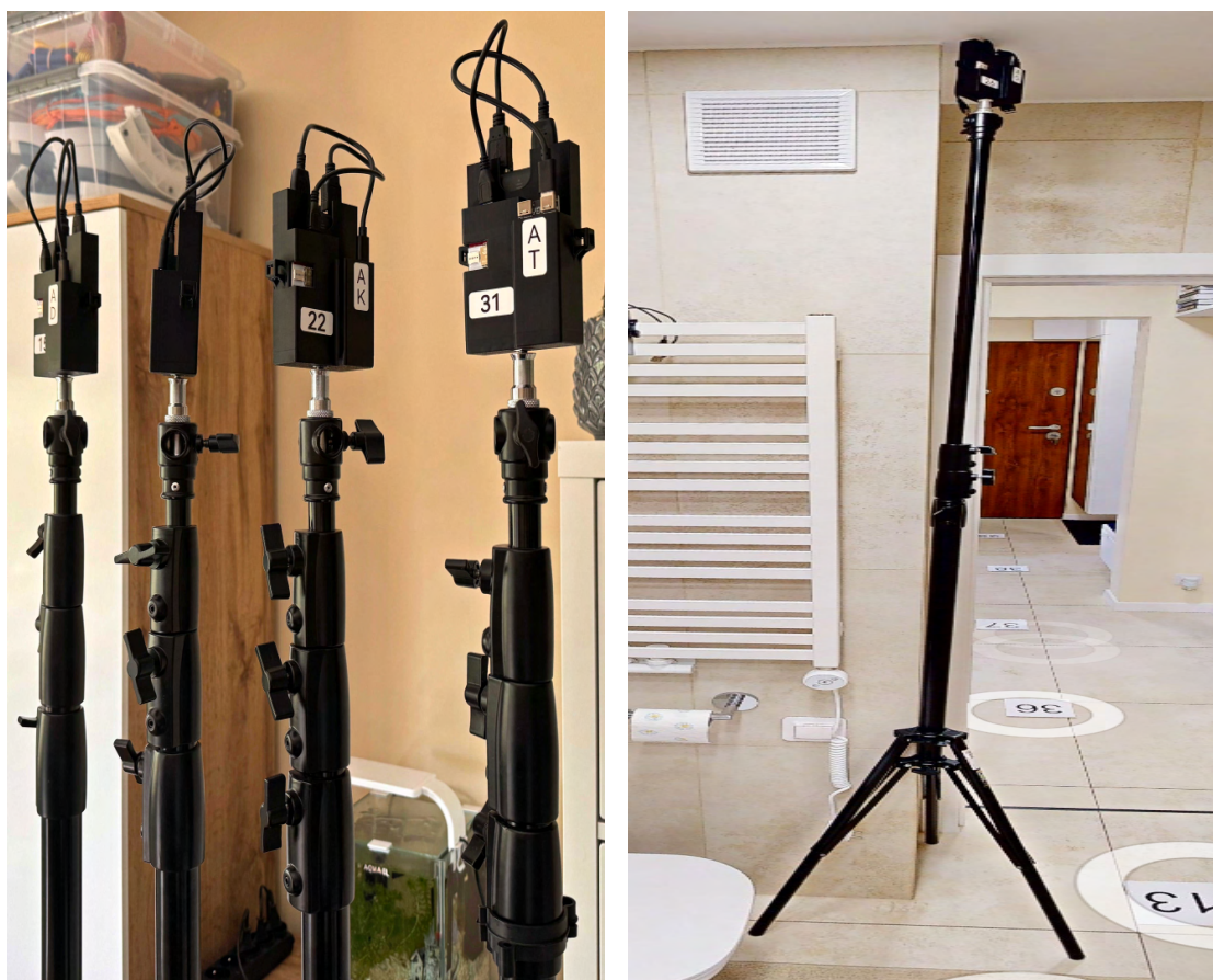
Rysunek 5.7: Po lewej: zdjęcie sposobu montażu punktów referencyjnych umieszczanych na dużych wysokościach, tj. z wykorzystaniem statywów, które pozwoliły na stabilne wyniesienie kotwic radiowych pod sufit pomieszczenia. Po prawej: zdjęcie faktycznego użycia takiego statywu.
