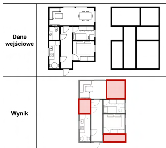
Rysunek 2.12: Wizualizacja zadania wykrywania zmian. Obrazy początkowy i zaktualizowany ( u góry ) są analizowane w celu wykrycia różnic między nimi. Wykryte niezgodne elementy zostały zaznaczone na czerwono ( na dole ).
