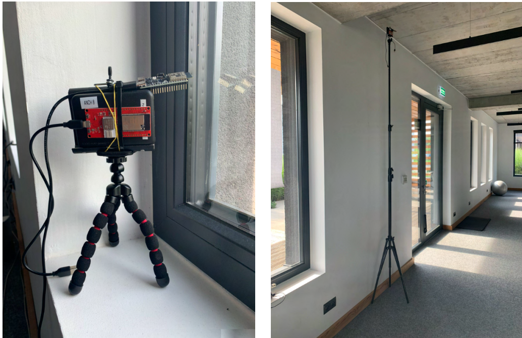
Rysunek 3.16: Urządzenie kotwicy zamontowane na statywie niskim (po lewej) oraz regulowanym wysokim (po prawej).
