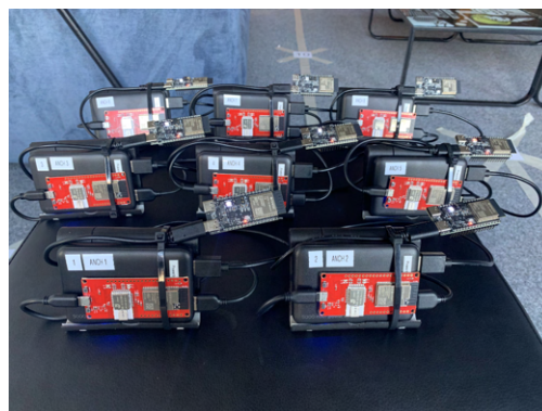
(b) Zbudowane urządzenia kotwic, łączące komponenty obu technologii: UWB (płytki czerwone) i BLE (płytki czarne).
