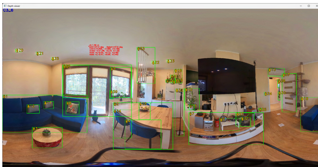
Rysunek 5.24: Zrzut ekranu opracowanego narzędzia deweloperskiego do wizualizacji detekcji obiektów na panoramach ERP wraz z przeliczeniem położenia do przestrzeni trójwymiarowej.
