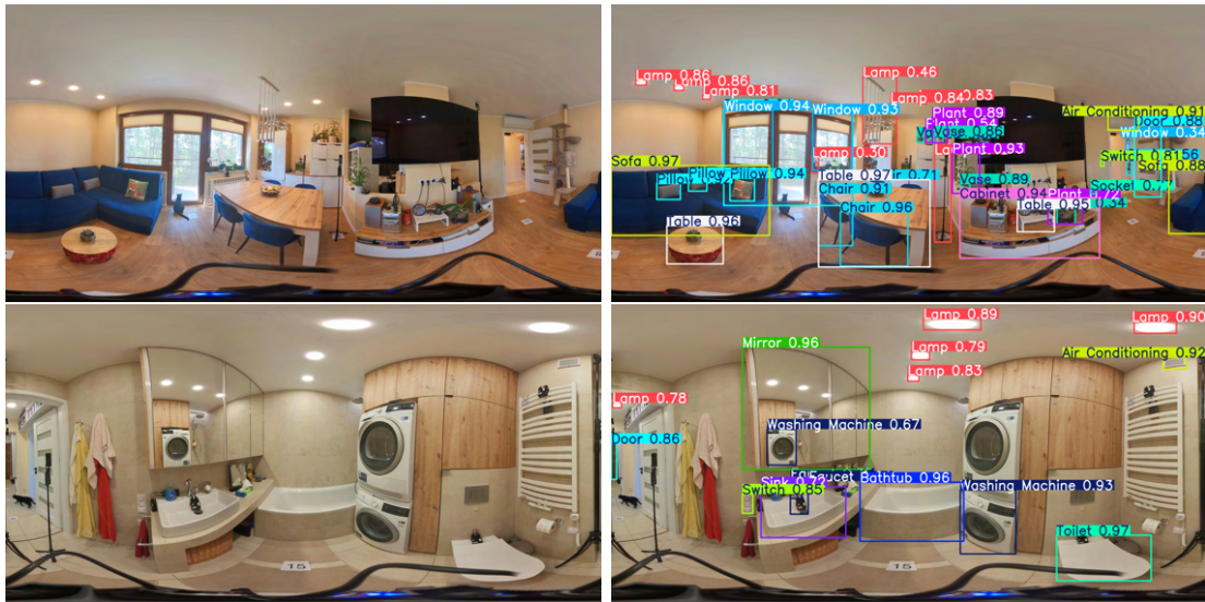
Rysunek 5.22: Przykładowe zdjęcia panoramiczne z badań systemu hybrydowego wraz z zaznaczonymi na nich detekcjami obiektów.
