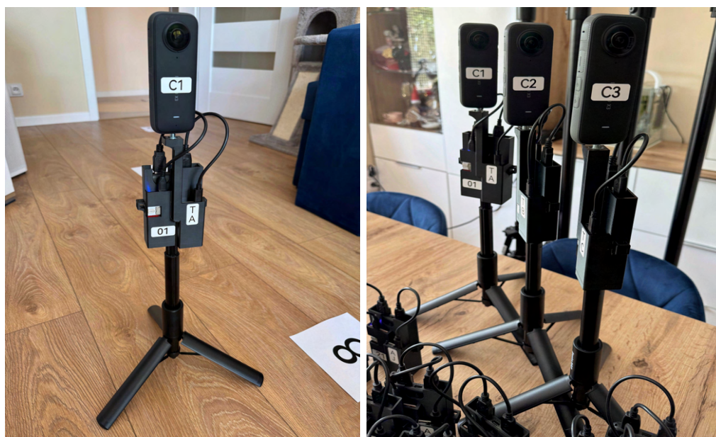
Rysunek 5.6: Zdjęcia mobilnych urządzeń pomiarowych. Na lewym zdjęciu, w zbliżeniu, od góry: kamera sferyczna, lokalizator radiowy, trójnóg montażowy. Po prawej zdjęcie wszystkich trzech przygotowanych urządzeń pomiarowych.
