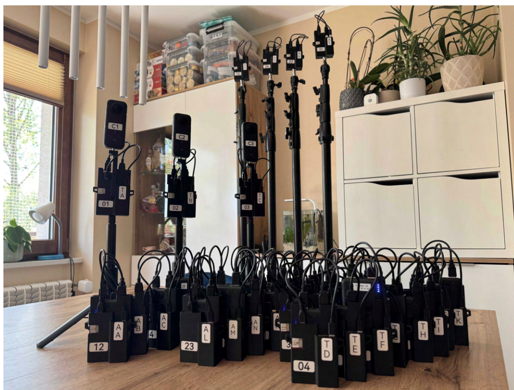
Rysunek 5.8: Zdjęcie zbiorcze wszystkich 35 skonstruowanych urządzeń, budujących radiową część hybrydowego systemu pozycjonowania. Na zdjęciu, kolejno: trzy mobilne urządzenia pomiarowe (kamera, lokalizator, trójnóg) po lewej stronie, cztery zmontowane punkty referencyjne dużej wysokości (kotwice wyniesione pod sufit) w tle, 28 pozostałych urządzeń (20 kotwic i 8 lokalizatorów) z przodu.
