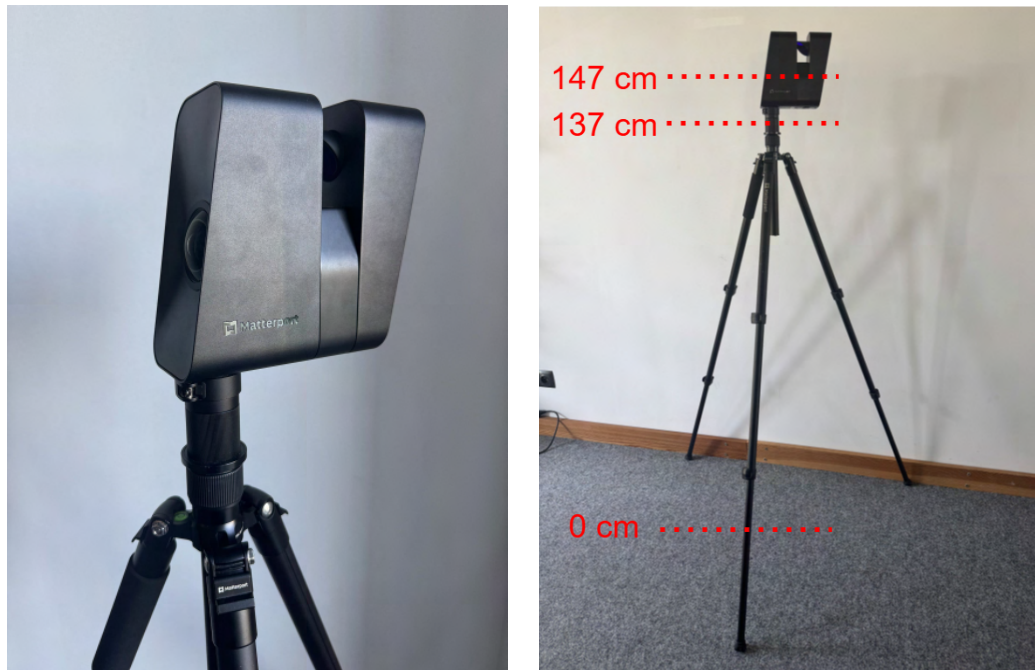
Rysunek 4.23: Zdjęcie skanera przestrzeni Matterport Pro 3 (po lewej) oraz jego umieszczenie na dedykowanym trójnogu z naniesionymi na zdjęcie pomiarami wysokości (po prawej).
