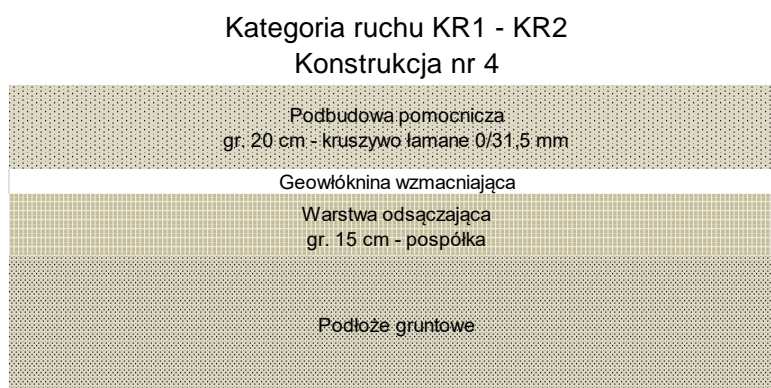
Rys.7.14 Przekrój konstrukcji nr 4 – kategoria ruchu KR1 – KR2
