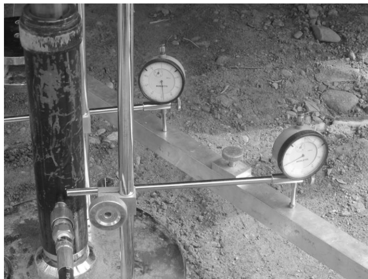
Fot. 5.5 Przykład nieprawidłowego ustawienia czujników podczas badania płytą VSS (zdjęcie autora)
