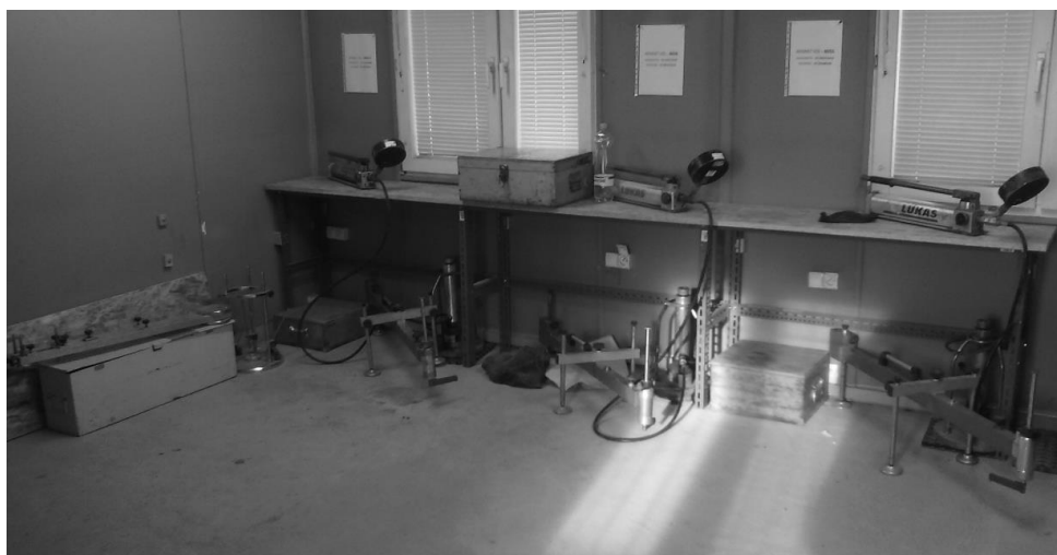
Fot. 6.2 Płyty statyczne VSS (zdjęcie własne)
