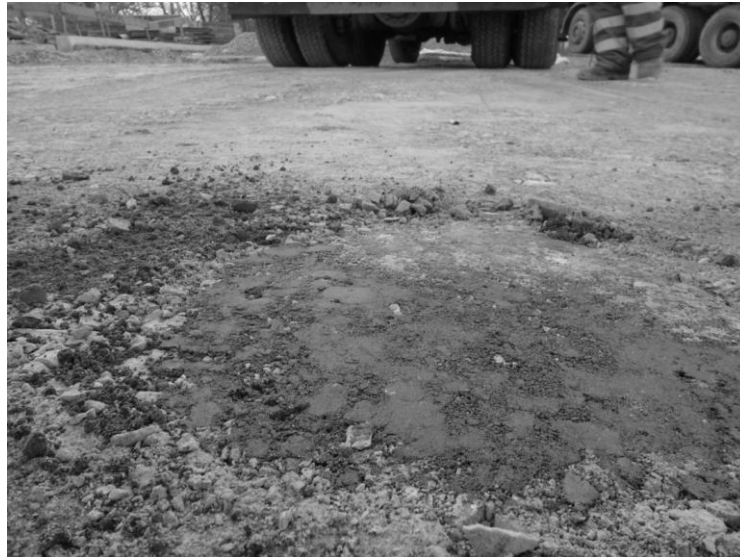
Fot. 5.4 Przykład niepoprawnego przygotowania warstwy do badania płytą VSS (zdjęcie własne)
