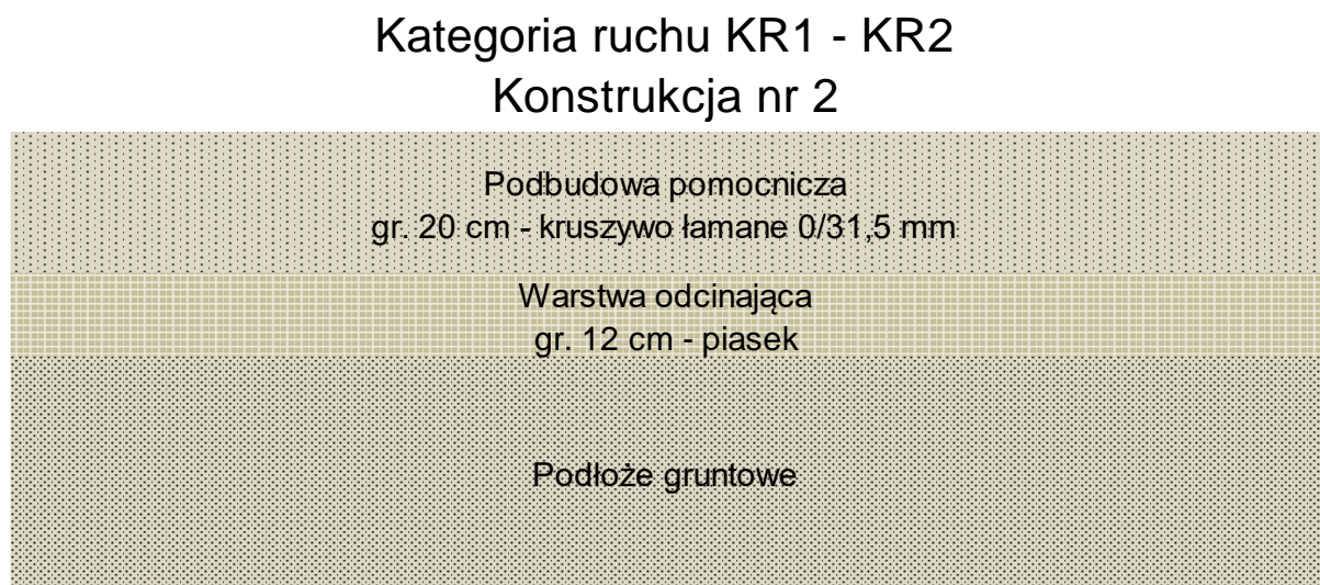
Rys.7.10 Przekrój konstrukcji nr 2 – kategoria ruchu KR1 – KR2
