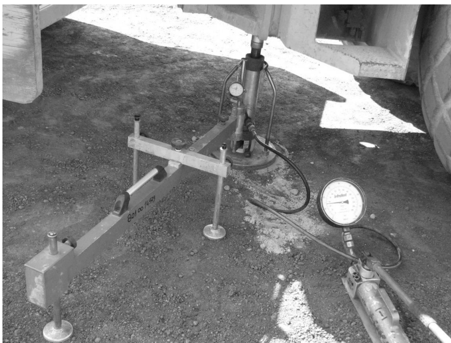
Fot. 5.2 Przykładowa płyta statyczna jednoczujnikowa do badania VSS (zdjęcie własne)
