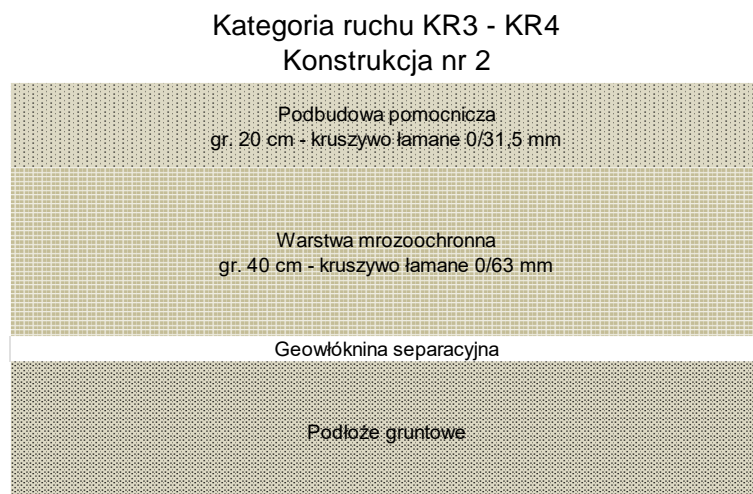
Rys.8.10 Przekrój konstrukcji nr 2 – kategoria ruchu KR3 – KR4
