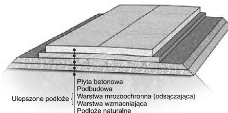
Rys. 3.2 Przekrój warstw konstrukcji sztywnych (Szydło i Mackiewicz, 2005)
