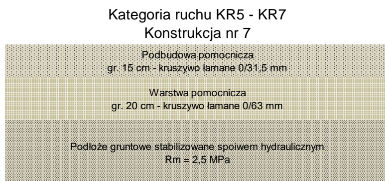
Rys.9.20 Przekrój konstrukcji nr 7 – kategoria ruchu KR5 – KR7
