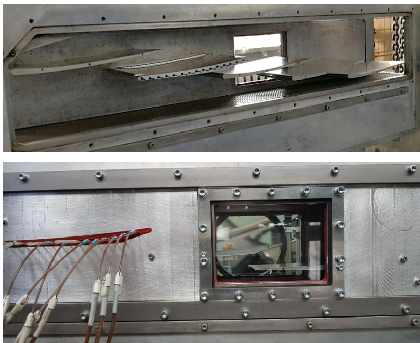
Rys. 2.4. Kaskada łopatek wirnika na stanowisku badawczym SUT oraz aparatura pomiarowa
