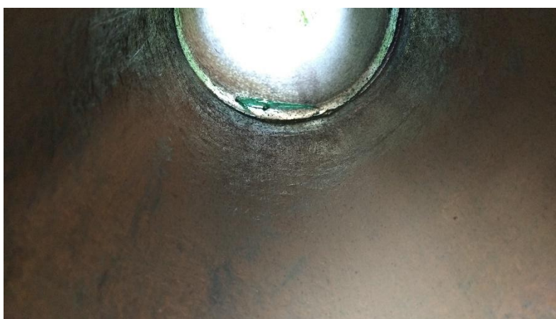
Rys. 69. Widok złącza III od strony grani spoiny
