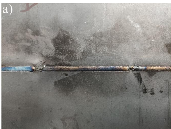
Rys. 117. Widok lica złącza 6A: a) po spawaniu, b) po badaniu penetracyjnym
