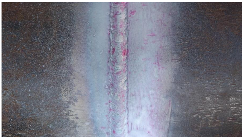
Rys. 68. Widok złącza III od strony lica spoiny po badaniu penetracyjnym
