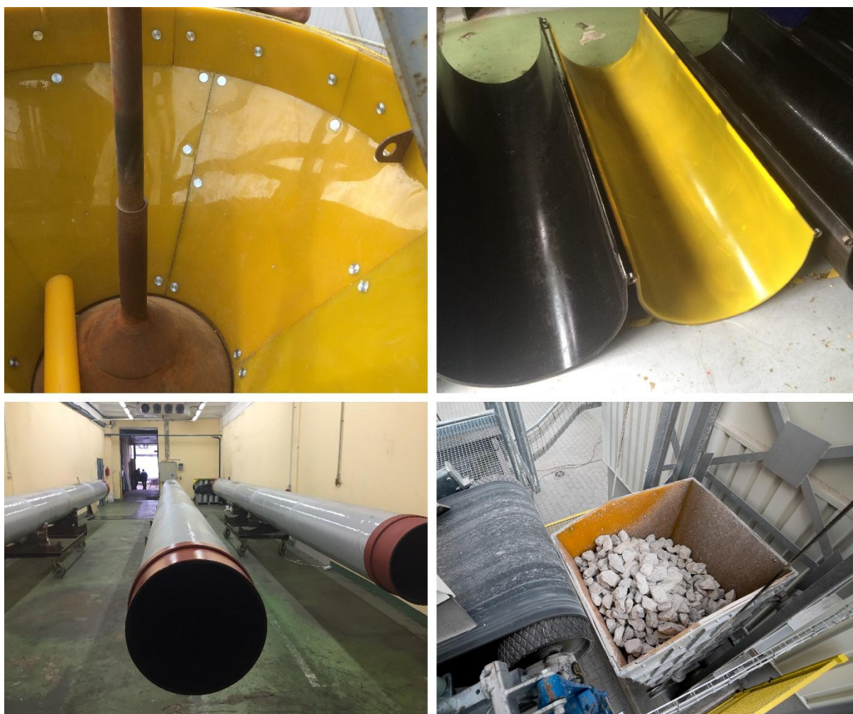
Rys. 10. Przykłady zastosowania wykładek z PUGA w przemyśle (zsypy, rynny, rurociągi, kontenery) [43]
