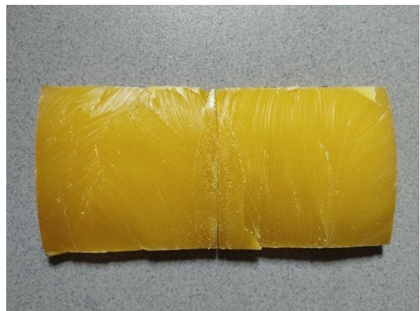
Rys. 149. Widok oderwanej wykładki ze złącza 2R
