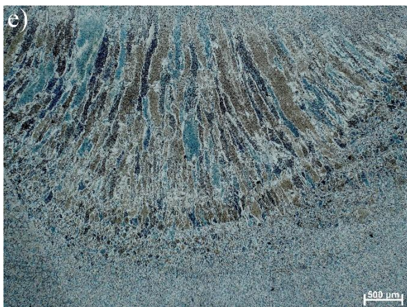
Rys. 37. Mikrostruktury złącza – rozwiązanie „a”, powiększenie 25x; punkty obserwacji: a) 1, b) 2, c) 3, d) 4, e) 5, f) 6
