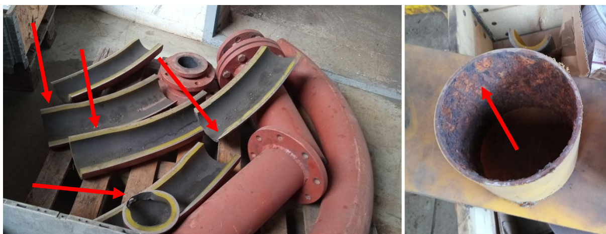
Rys. 3. Przykładowe uszkodzenia występujące podczas eksploatacji: uszkodzenie wykładek, erozja rur, odkształcenia geometryczne rur, zarastanie rur [por. 6]
