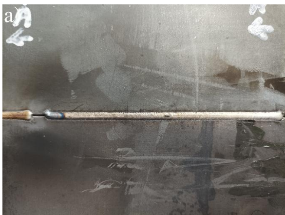
Rys. 114. Widok lica złącza 3A: a) po spawaniu, b) po badaniu penetracyjnym
