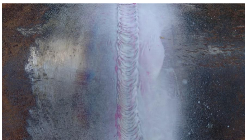
Rys. 62. Widok złącza II od strony lica spoiny po badaniu penetracyjnym
