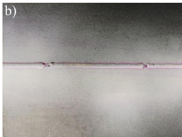
Rys. 117. Widok lica złącza 6A: a) po spawaniu, b) po badaniu penetracyjnym
