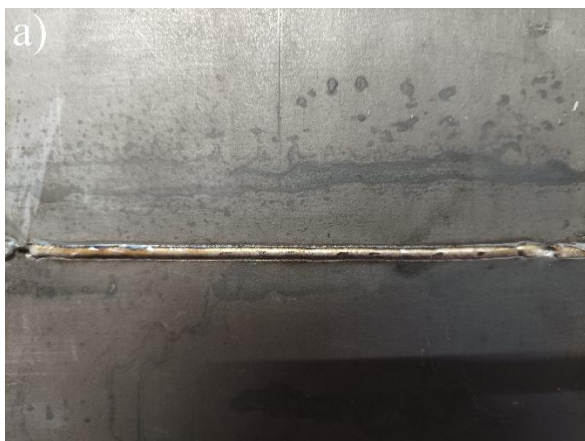
Rys. 112. Widok lica złącza 1A: a) po spawaniu, b) po badaniu penetracyjnym
