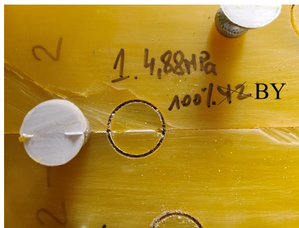
Rys. 127. Widok po badaniu pull-off złącza 1A wraz ze stemplem
