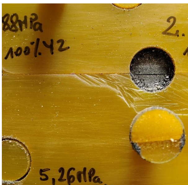
Rys. 128. Widok po badaniu pull-off złącza 7A wraz ze stemplem
