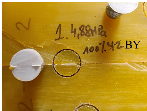
Rys. 127. Widok po badaniu pull-off złącza 1A wraz ze stemplem
