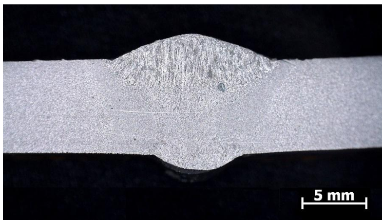
Rys. 58. Widok makroskopowy przekroju złącza I, pow. 8x
