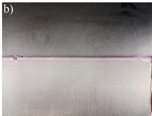
Rys. 116. Widok lica złącza 5A: a) po spawaniu, b) po badaniu penetracyjnym
