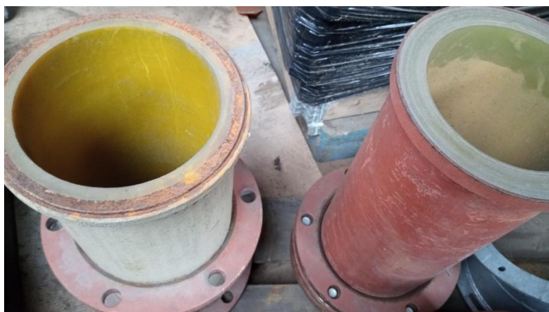
Rys. 13. Widok zdemontowanych rur z wykładkami z pracującej instalacji transportu hydraulicznego
