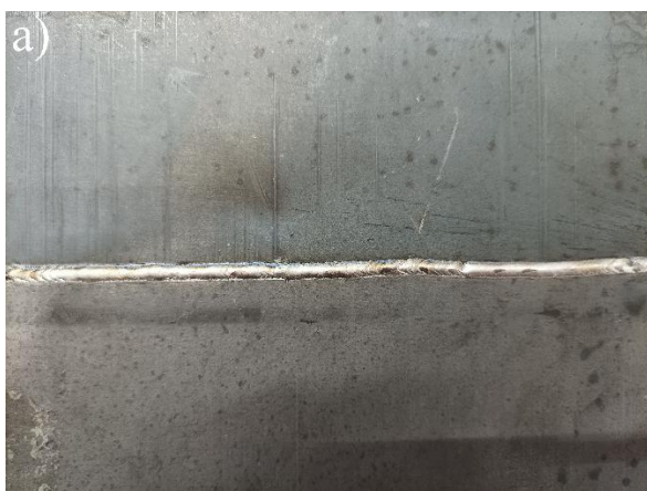
Rys. 113. Widok lica złącza 2A: a) po spawaniu, b) po badaniu penetracyjnym
