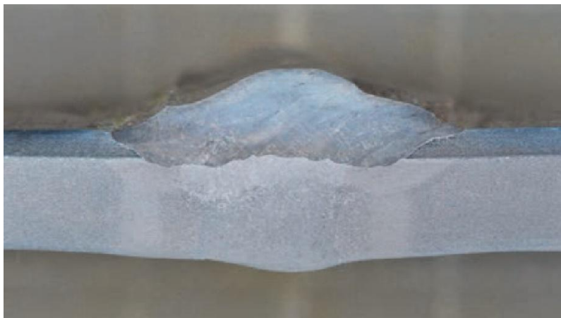
Rys. 9. Widok makroskopowy przekroju złącza na rurze kompozytowej Sanicro 3R12/4L7 [40]
