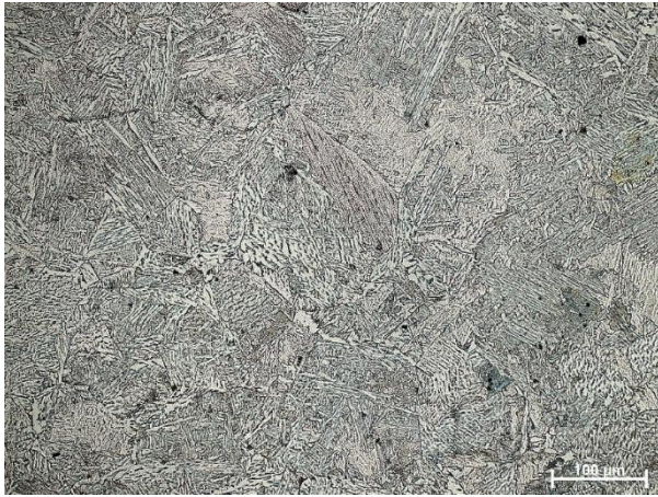
Rys. 45. Mikrostruktura strefy wpływu ciepła złącza rozwiązania „g”, pow. 200x
