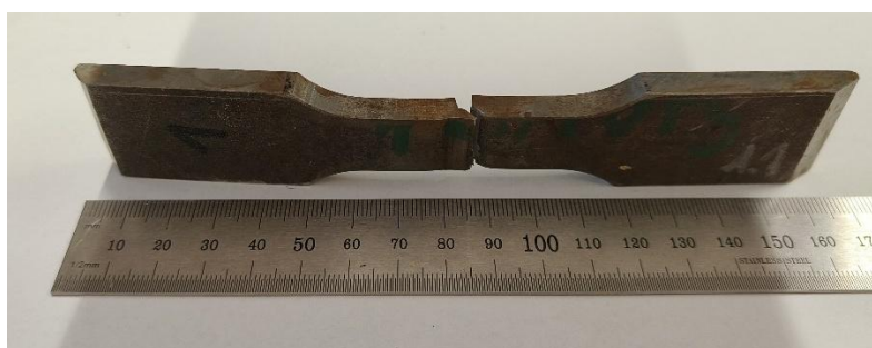
Rys. 154. Próbką R1.1 po statycznej próbie rozciągania
