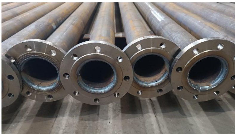
Rys. 4. Widok prefabrykowanych fragmentów rurociągów wykonanych ze stali trudnościeralnych.
