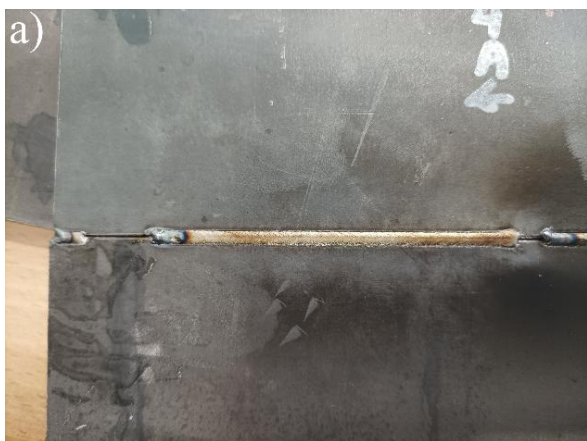
Rys. 115. Widok lica złącza 4A: a) po spawaniu, b) po badaniu penetracyjnym
