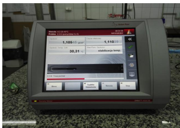
Rysunek 24. Gęstościomierz Anton Paar 4500M.
