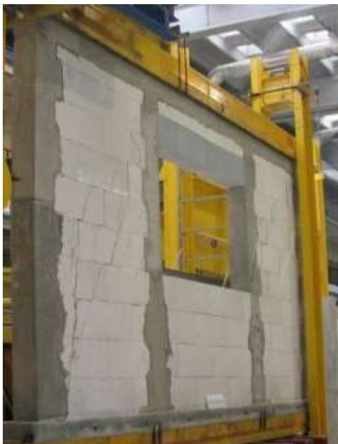
Rys. 5.22. Porównanie obrazów zarysowań elementów badawczych i modeli numerycznych ścian z otworami serii HAS-C2-AAC w chwili zniszczenia: a) ściana ścinana i ściskana do wartości 0,1 \text{ N/mm}^2
