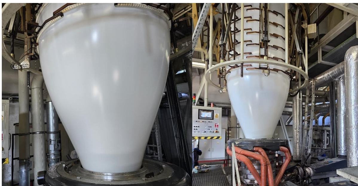
Rysunek 63. Zdjęcia z produkcji folii FFS EIV603, EIV604, EIV801, EIV802 na linii produkcyjnej Reifenhauser Reicofol ML – Total-Chem Sp. z o.o. Żory.
