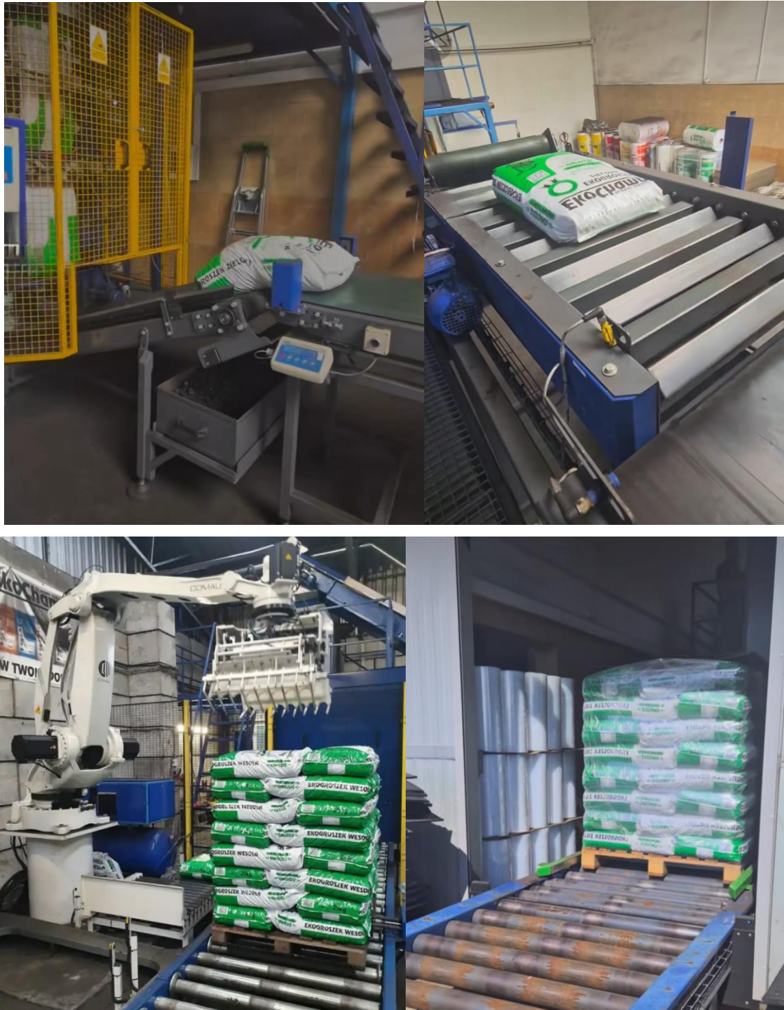
Rysunek 64. Zdjęcia z procesu pakowania i paletyzowania folii EIV603, EIV604, EIV801 i EIV802
