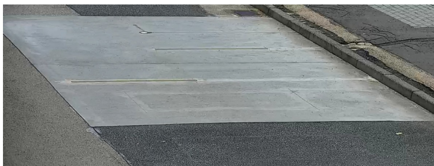
Rysunek 3.19. Czujniki tensometryczne na stanowisku testowym UBB. Źródło: materiały firmy APM PRO
