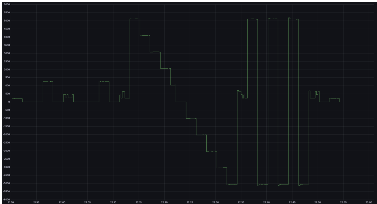
Rys. 4.25. Zarejestrowany profil pracy magazynu podczas zdalnego sterowania od 5000 W do -5000 W z krokiem 1000 W z poziomu Home Assistant
