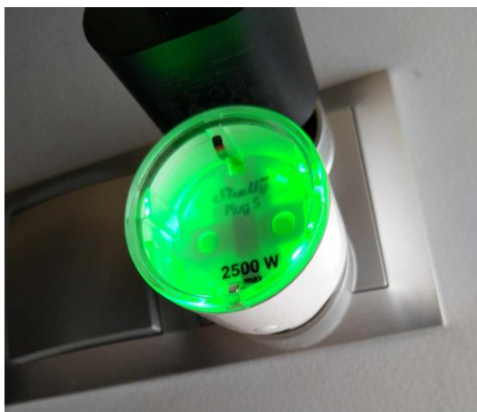
Rys. 4.16. Gniazdko WiFi Shelly Plus S wykorzystane do zdalnego załączania odbiorników SL
