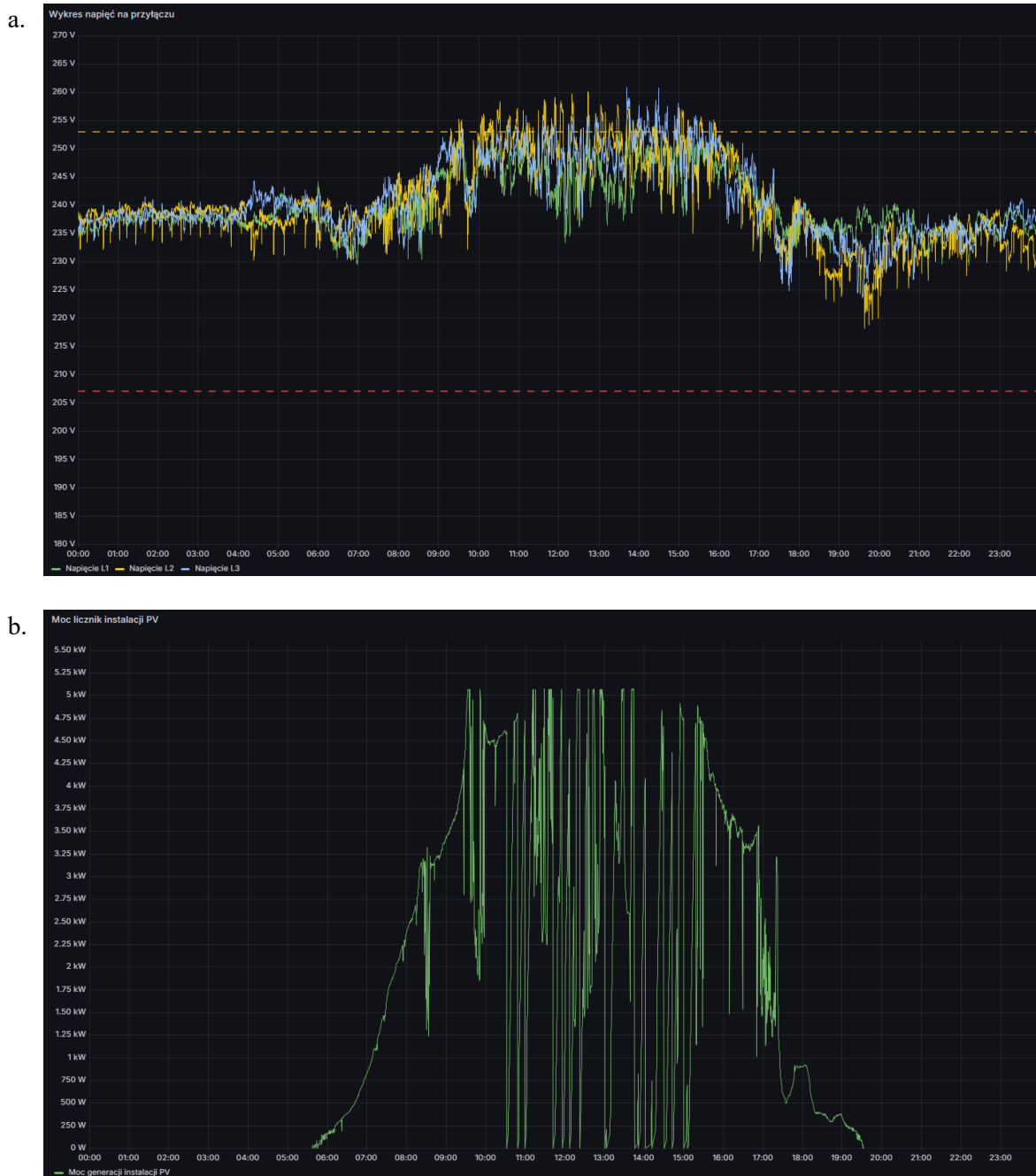
Rys. 4.13. Przebiegi napięć fazowych (a) oraz generacja źródła PV (b) w dniu 21.05.2025 r. – przerwy w pracy mikroinstalacji PV w wyniku przekroczenia dopuszczalnego poziomu napięcia
