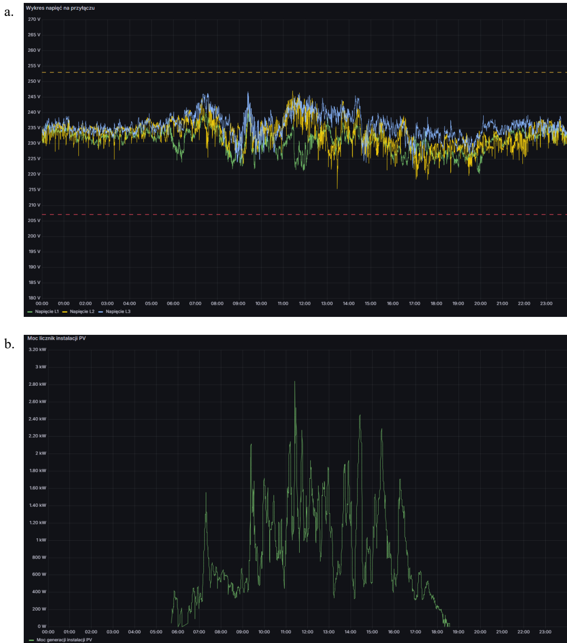
Rys. 4.14. Przebiegi napięć fazowych (a) oraz generacja źródła PV (b) w dniu 19.05.2025 r. – normalna praca mikroinstalacji PV
