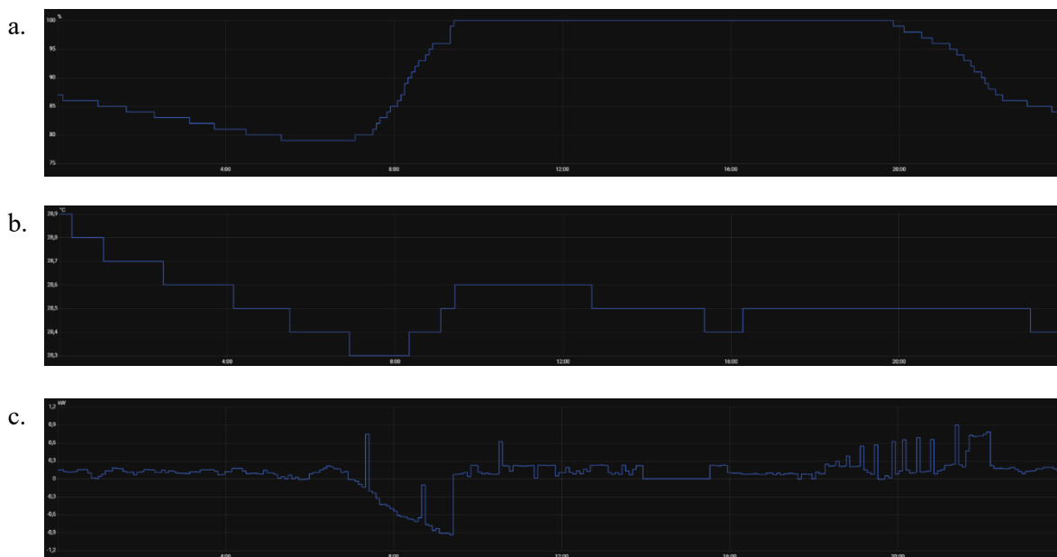
Rys. 4.21. Wykresy przedstawiające odczytane przy użyciu algorytmu Node-RED przykładowe wartości rejestrów ładowarki magazynu: (a) stopień naładowania magazynu, (b) temperatura baterii akumulatorów, (c) moc magazynu energii
