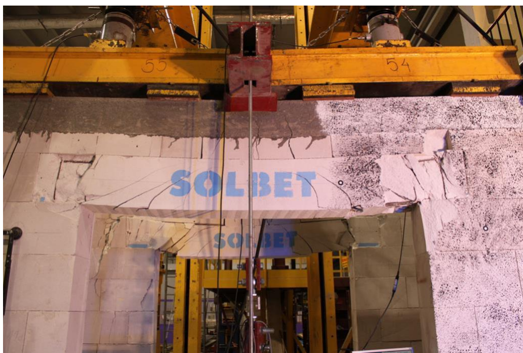
Rys. 7.3.47 Uszkodzenia modeli skrępowanych obwodowo z wypełnionymi spoinami pionowymi: a) MSO-Z1-1, b) MSO-Z1-2
