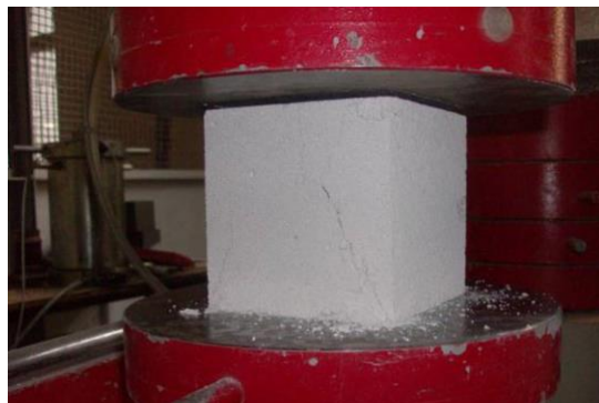
Rys. 6.2.7 Zniszczenie ściskanych elementów próbnych serii CZ: a) próbka CZ-1, b) próbka CZ-5
