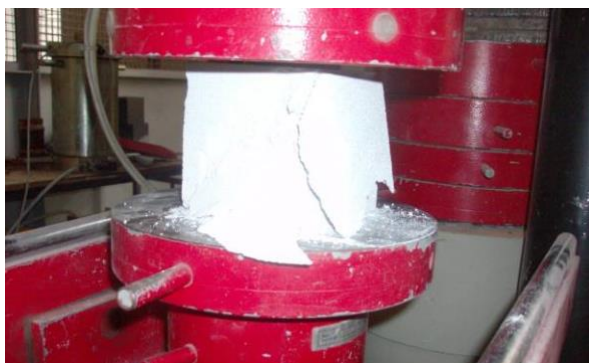
Rys. 6.2.7 Zniszczenie ściskanych elementów próbnych serii CZ: a) próbka CZ-1, b) próbka CZ-5
