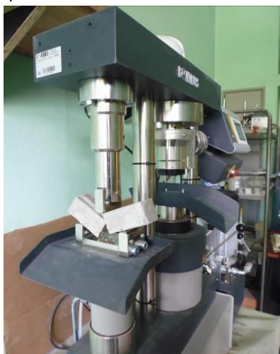
Rys. 6.6.3 Badania wytrzymałości na ściskanie i rozciąganie zaprawy: a) badanie na rozciąganie zginanie, b) badania na ściskanie
