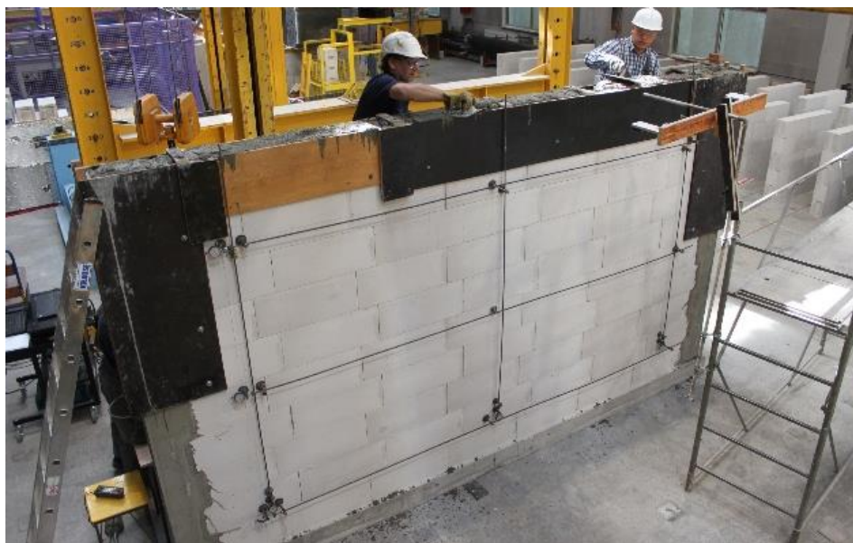
Rys. 7.2.8 Widok ściany skrępowanej betonem zwykłym z układem baz pomiarowych i czujników zegarowych (model MS-Z1-1)
