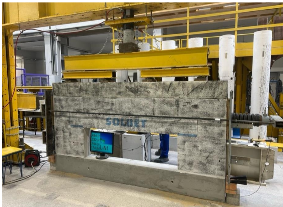
Rys. 7.4.15 Model badawczy fragmentu ściany na stanowisku badawczym a) rysunek z opisem: 1 – bloczki z ABK, 2 – posadzka, 3 – rama przyłożenia siły, 4 – siłomierz, 5 – siłownik, 6 – trawersy przekazujące obciążenie, 7 – podkładki walcowe i płaskie przekazujące obciążenie, 8 – ściągi poziome, 9 – płyta dociskowa ściągu, 10 – mierniki przemieszczeń, 11 – sprężyna przekazująca siłę ze ściągu, 12 – siłomierz, 13 – wieniec żelbetowy lub z betonu lekkiego b) fotografia (model pomalowany do rejestracji przemieszczeń za pomocą bezdotykowego pomiaru optycznego systemem cyfrowej korelacji obrazu Aramis)
