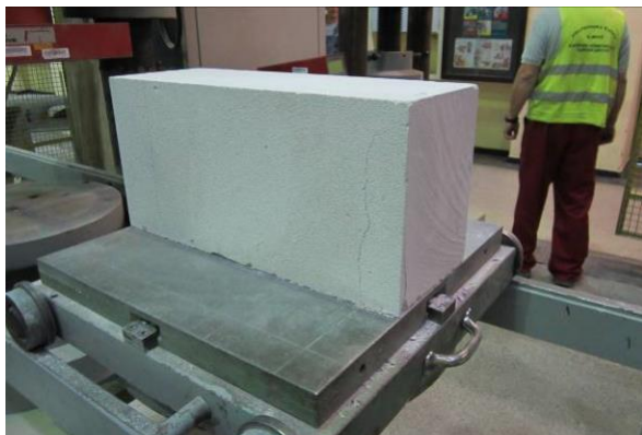
Rys. 6.2.4 Zniszczenie ściskanych elementów murowych serii U: a) próbka S1, b) próbka S2,
