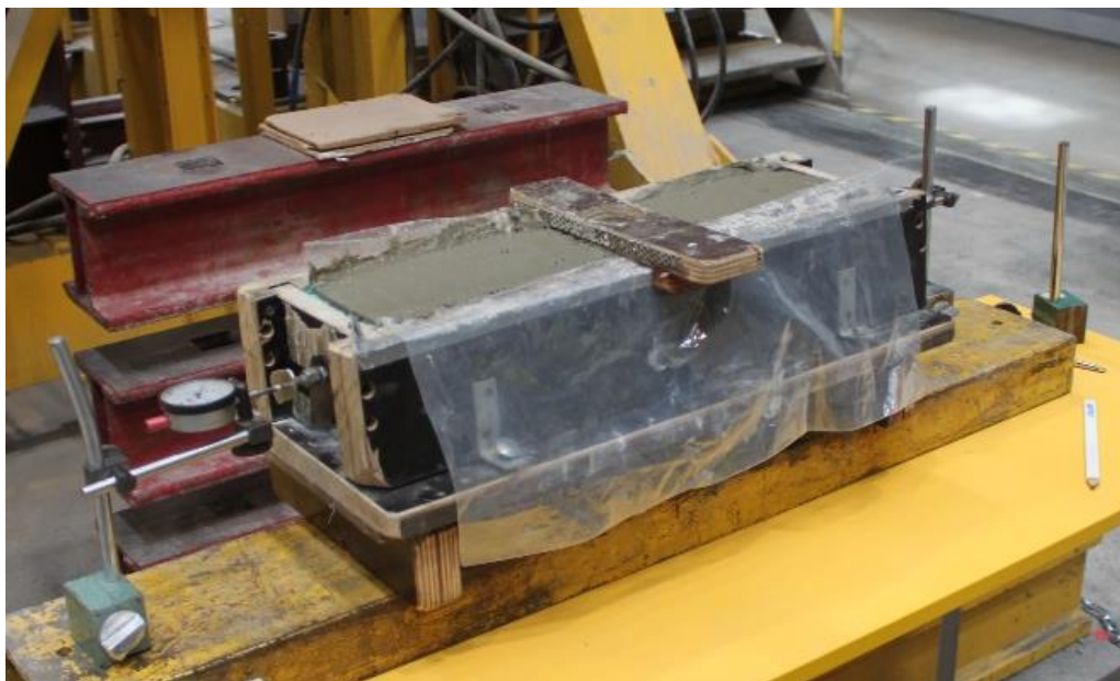
Rys. 7.2.11 Badania skurczu swobodnego. Widok stanowiska badawczego
