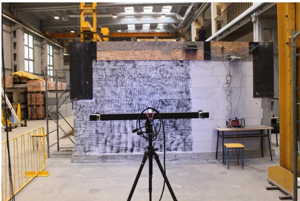
Rys. 7.2.9 Pomiar przemieszczeń muru systemem optycznym Aramis (model MS-Z1-1)
