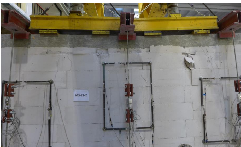
Rys. 7.3.25 Uszkodzenie modeli z skrępowanych niewypełnionymi spoinami pionowymi: a) MS-Z1-1, b) MS-Z1-2
