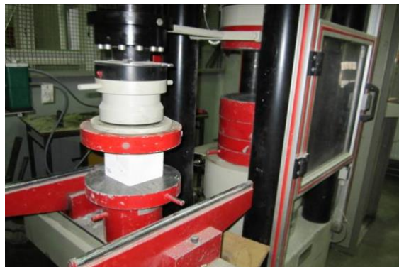
Rys. 6.2.3 Badanie wytrzymałości na ściskanie elementów murowych: a) badanie całych elementów, b) badanie próbek sześciennych
