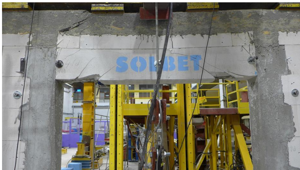
Rys. 7.3.50 Uszkodzenia modeli skrępowanych podwójnie z wypełnionymi spoinami pionowymi: a) M2SO-Z2-1, b) M2SO-Z2-2
