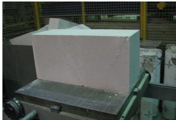
Rys. 6.2.4 Zniszczenie ściskanych elementów murowych serii U: a) próbka S1, b) próbka S2,
