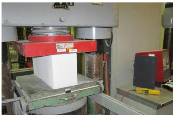
Rys. 6.2.3 Badanie wytrzymałości na ściskanie elementów murowych: a) badanie całych elementów, b) badanie próbek sześciennych
