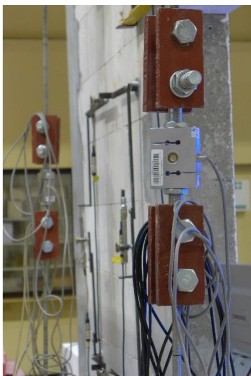
Rys. 7.3.12 Szczegóły układu przekazywania obciążenia: a) mocowanie siłomierza naciąganych, b) stalowy trawers ułożony na wieńcu i mocowanie cięgien, c) siłowniki tłokowe mocowane od spodu płyty wielkich sił
