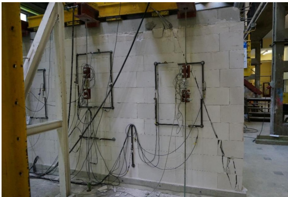
Rys. 7.3.23 Uszkodzenie modeli nieskrępowanych z niewypełnionymi spoinami pionowymi: a) MNS-Z1-1, b) MNS-Z1-2
