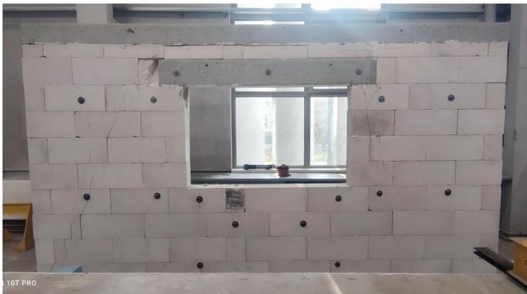
Rys. 7.4.11 Uszkodzenia modeli bez skrępowania z niewypełnionymi spoinami pionowymi: a) i b) MNSO-LC
