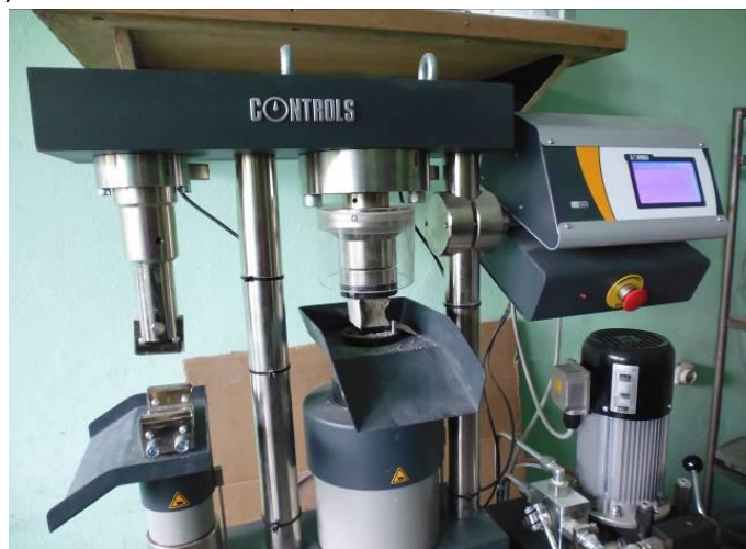
Rys. 6.6.3 Badania wytrzymałości na ściskanie i rozciąganie zaprawy: a) badanie na rozciąganie zginanie, b) badania na ściskanie
