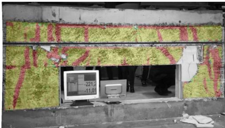
Rys. 7.4.16 Zniszczenia modeli badawczych a) Model NIII – N [69]
