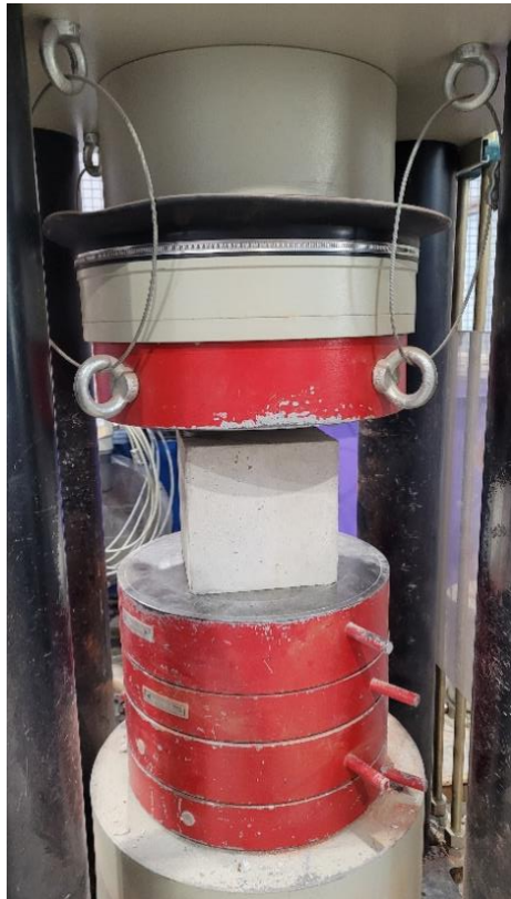
Rys. 6.8.1 Widok próbki betonu przed (a) i po badaniu (b)
