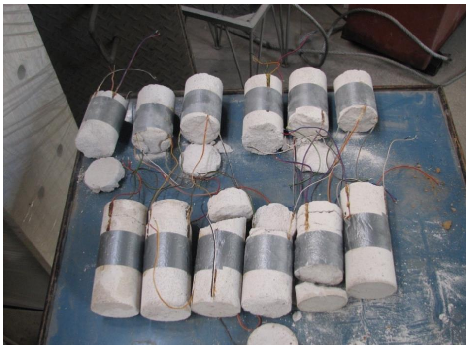
Rys. 6.3.2 Sposób zniszczenia próbek serii SV (u góry) i SH (na dole)
