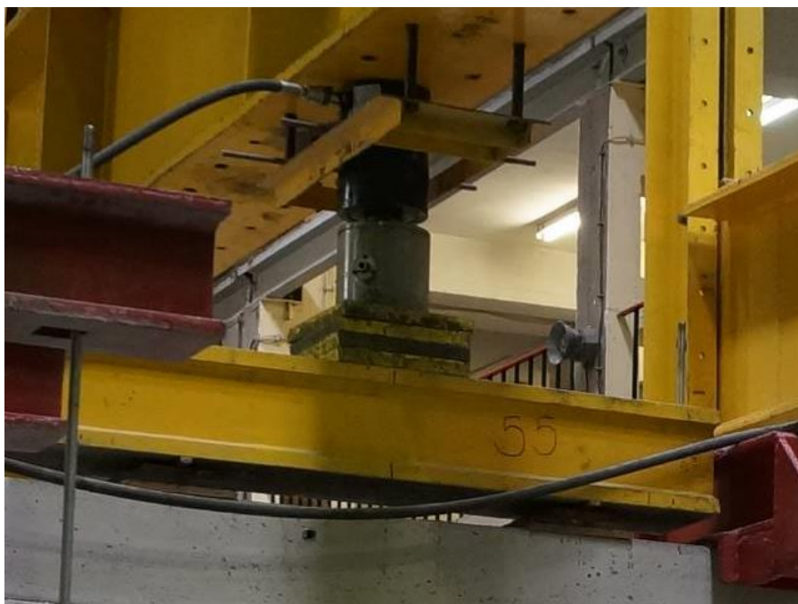
Rys. 7.3.11 Belka trawersowa oraz siłownik i siłomierz przymocowane do ramy
