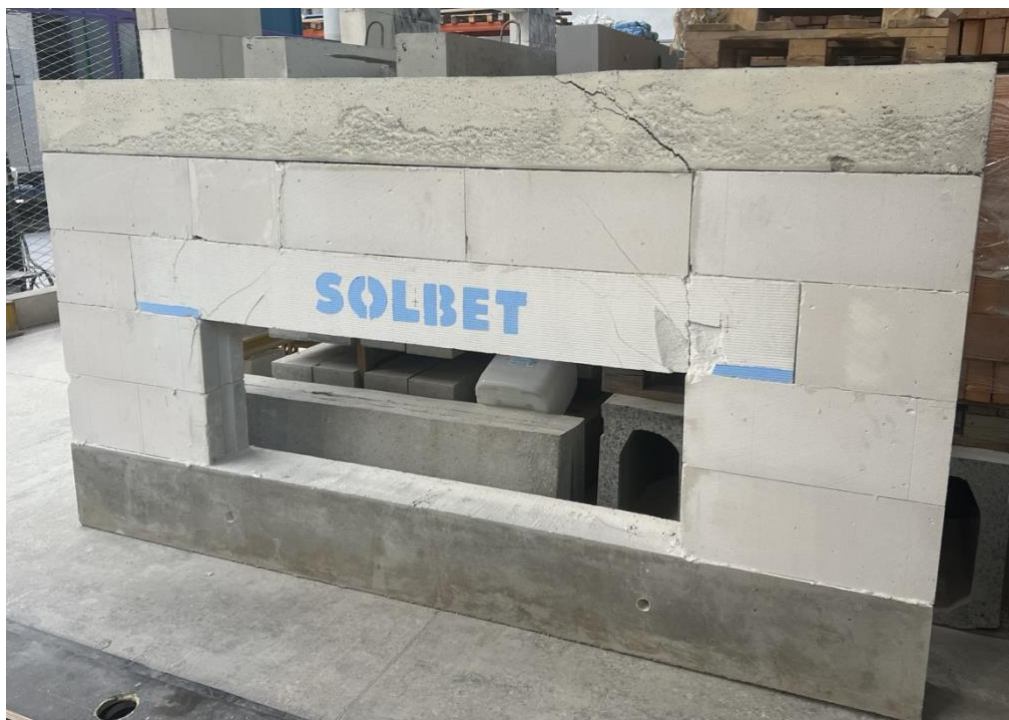
Rys. 7.4.14 Model badawczy fragmentu ściany: a) rysunek modelu, b) model po badaniu
