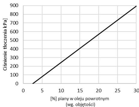
Rys. 3 Struktura napowietrzenia oleju A –charakterystyka ilości piany w objętości oleju w zależności od ciśnienia tłoczenia pompy odsysającej [5], B – różnica między napowietrzonym olejem i olejem odgazowanym [7]
